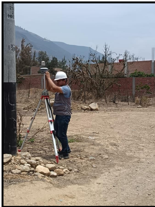
Realizando estacionamiento para levantamiento topográfico
