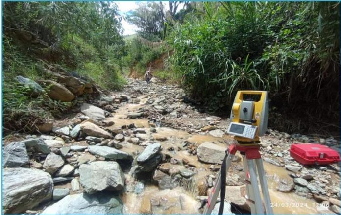
Imagen 04: Toma de puntos con el equipo topografico.
