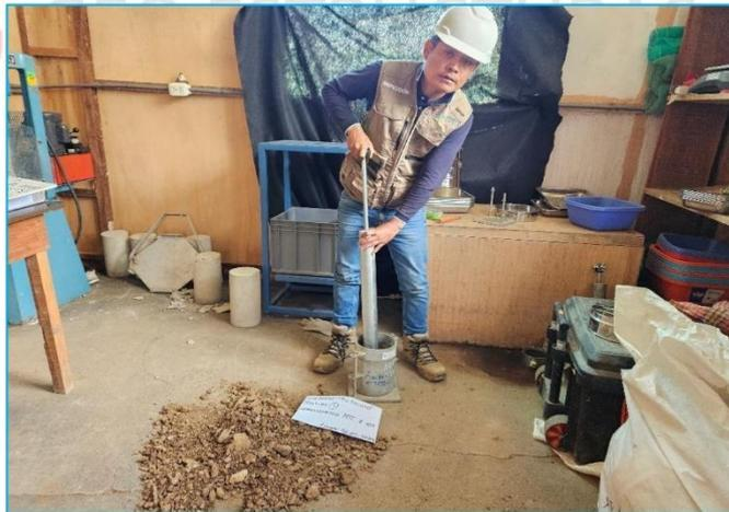
Imagen 10: Ensayo de Proctor en el laboratorio de suelos con las muestras.
