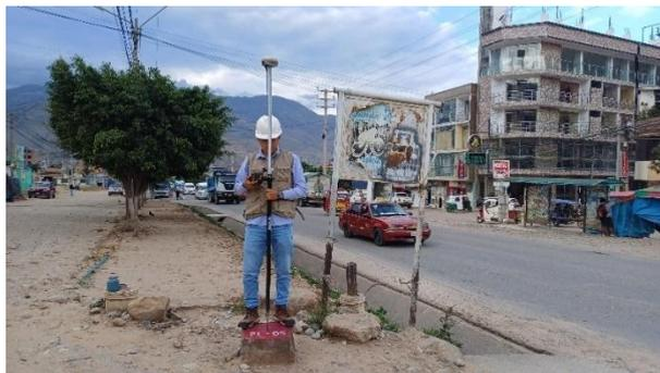
*Nota.* En la imagen se puede apreciar la medición en el punto de control con el código PC-05 con el receptor Galaxy G3.
