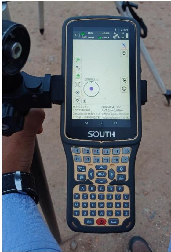
*Nota. En la imagen se puede apreciar como actúa como una interfaz de usuario para sistemas de posicionamiento South, permitiendo la recolección de datos de campo.*
