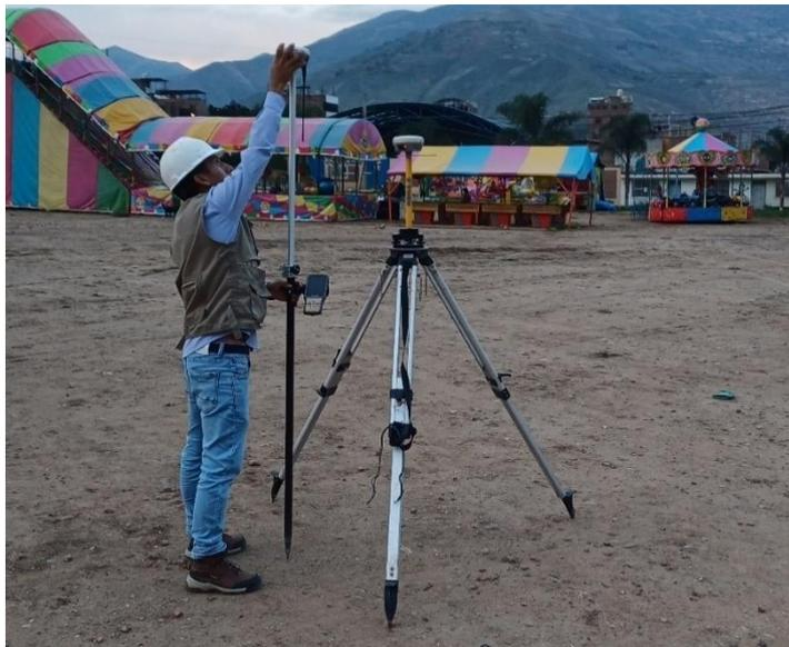
*Nota.* En la imagen se puede apreciar la colocación del receptor en un bastón y ajusta la altura para alcanzar el ángulo de elevación correcto.
