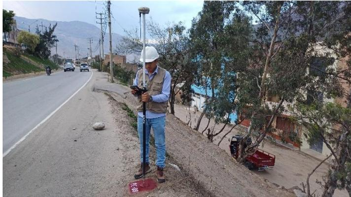
*Nota.* En la imagen se puede apreciar la medición en el punto de control con el código PC-09 con el receptor Galaxy G3.
