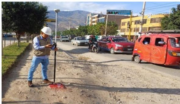
*Nota.* En la imagen se puede apreciar la medición en el punto de control con el código PC-02 con el receptor Galaxy G3.
