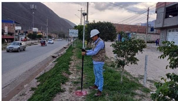
*Nota.* En la imagen se puede apreciar la medición en el punto de control con el código PC-07 con el receptor Galaxy G3.
