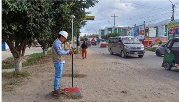
*Nota.* En la imagen se puede apreciar la medición en el punto de control con el código PC-03 con el receptor Galaxy G3.
