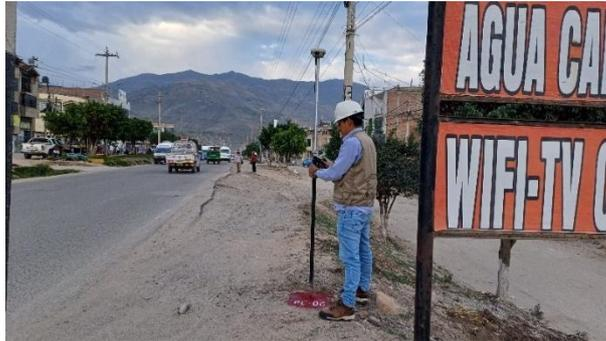
*Nota.* En la imagen se puede apreciar la medición en el punto de control con el código PC-06 con el receptor Galaxy G3.
