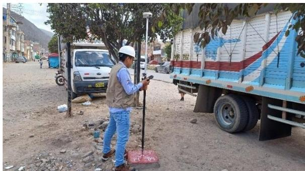
*Nota.* En la imagen se puede apreciar la medición en el punto de control con el código PC-04 con el receptor Galaxy G3.
