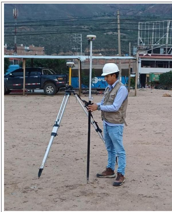
*Nota.* El GPS diferencial (DGPS) es un método de localización relativa que mejora la precisión del receptor GPS al corregir sus datos utilizando información de uno o varios receptores GPS estacionarios (DGPS - Differential Global Positioning System).
