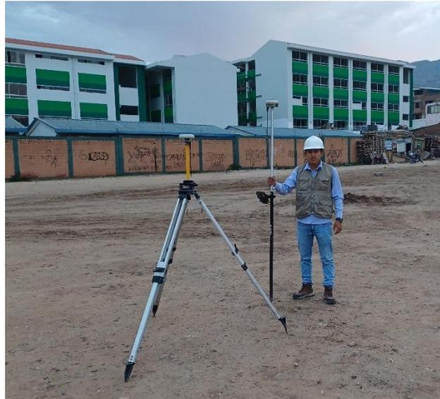
*Nota.* En la imagen se puede apreciar la colocación de la estación base en una posición estable y segura. Puede ser montada en un trípode para facilitar su ajuste y estabilidad.
