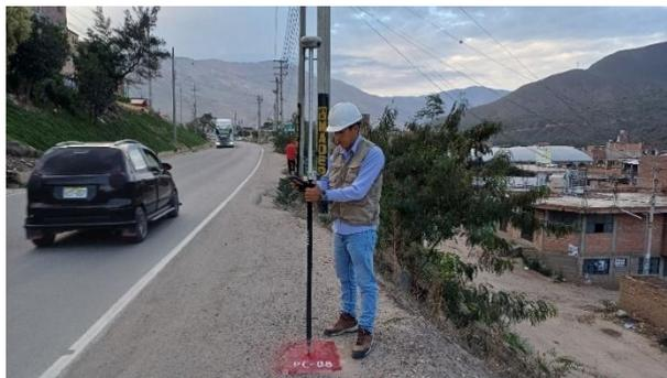
*Nota.* En la imagen se puede apreciar la medición en el punto de control con el código PC-08 con el receptor Galaxy G3.
