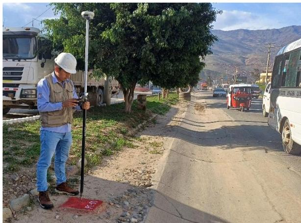
*Nota.* En la imagen se puede apreciar la medición en el punto de control con el código PC-01 con el receptor Galaxy G3.
