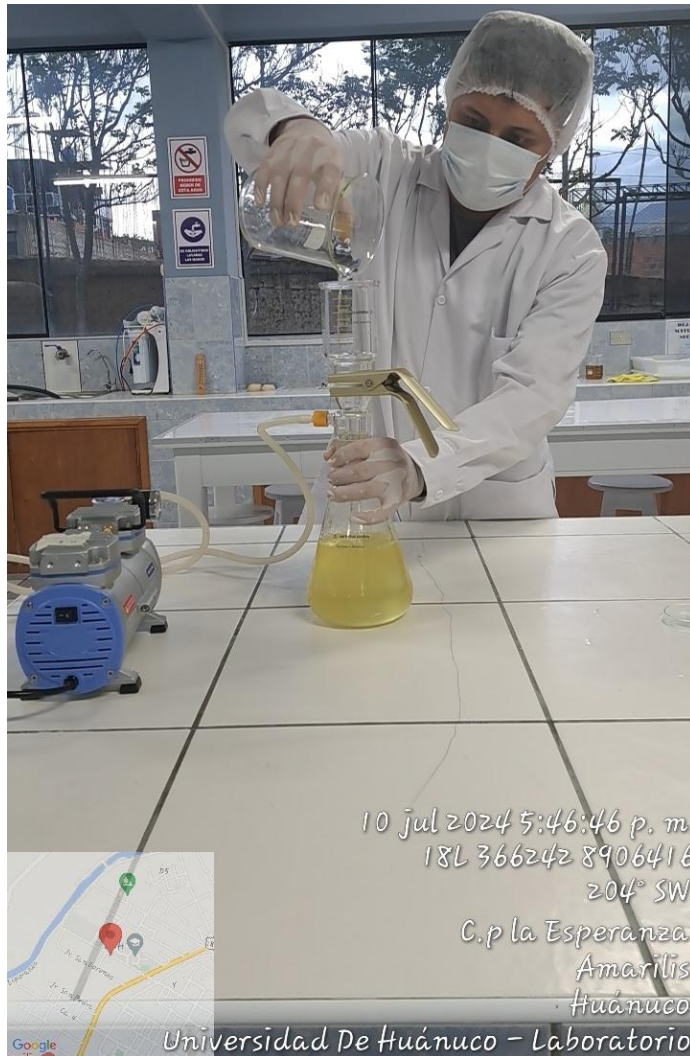
Proceso de Filtrado por Bomba al Vacío para la obtención del biodiésel pecuario.
