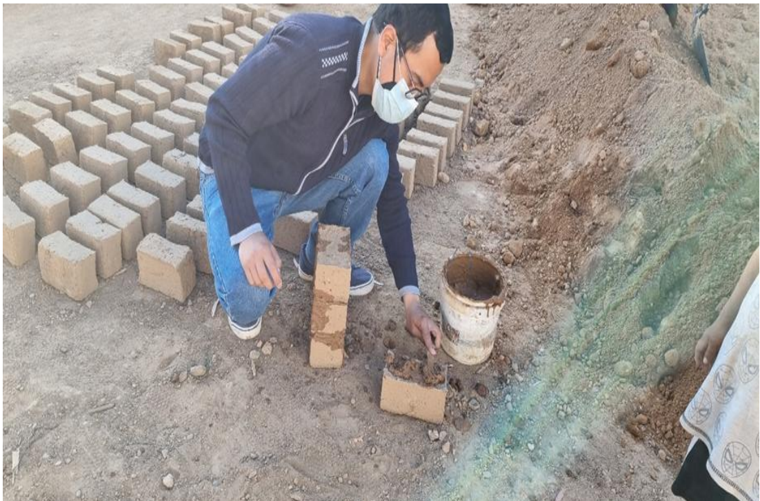
Fotografía. - Proceso de elaboración de los muretes apilando 3 bloques de adobe con adición de polietileno de baja densidad.
