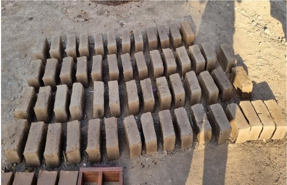
Fotografía. - Proceso de secado de los adobes con la adición de polietileno de baja densidad.
