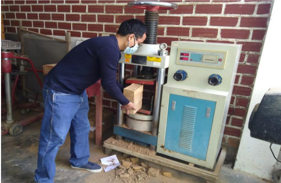
Fotografía. - Colocación de las muestras de muretes de adobe hacia la prensa hidráulica
