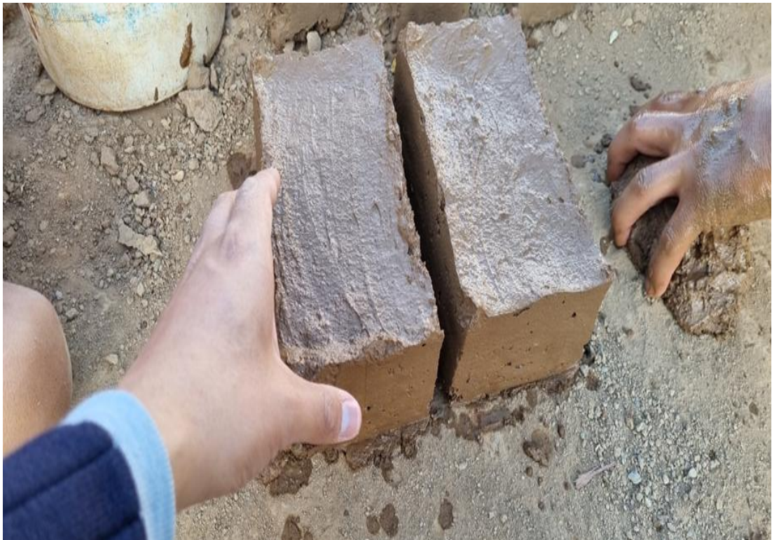
Fotografía. - Proceso final del moldeado del adobe
