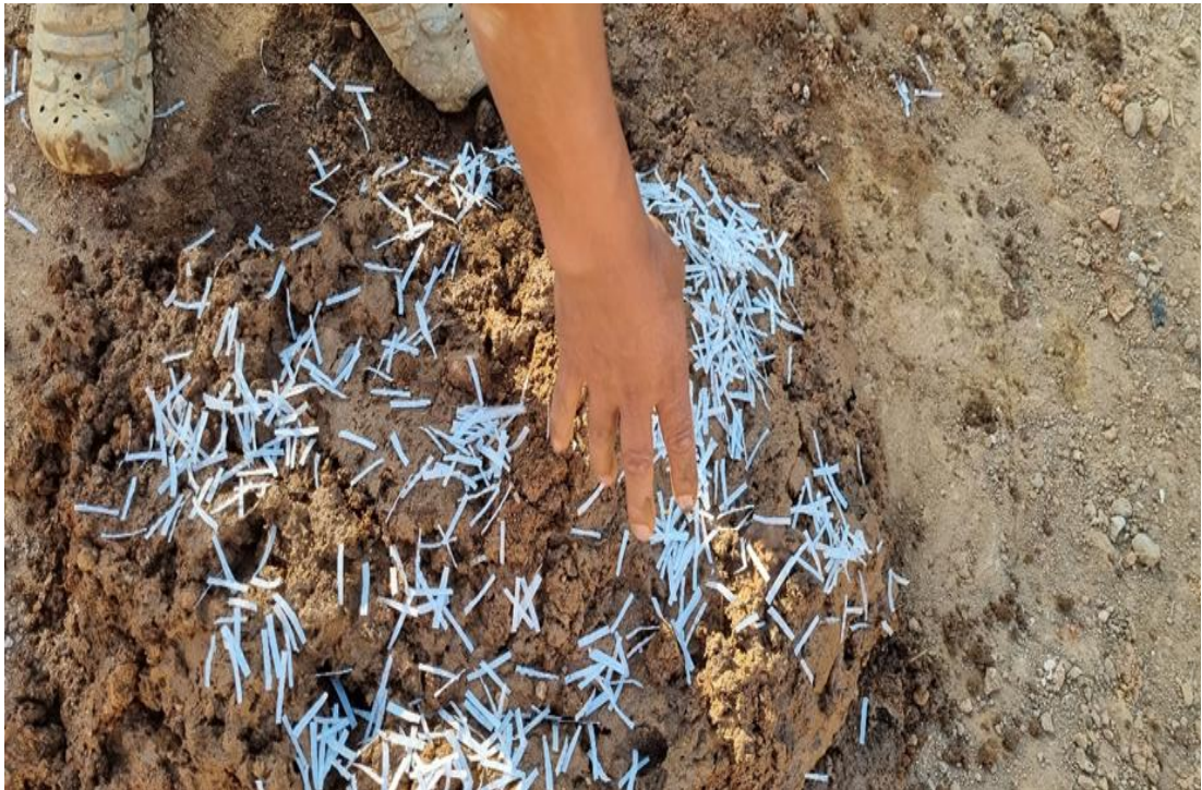
Fotografía. - En la mezcla de barro para el adobe se le añade el polietileno de baja densidad
