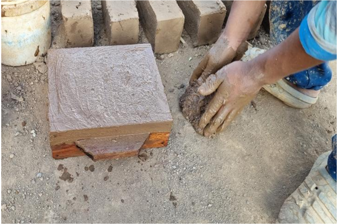
Fotografía. - Proceso de moldeo del adobe
