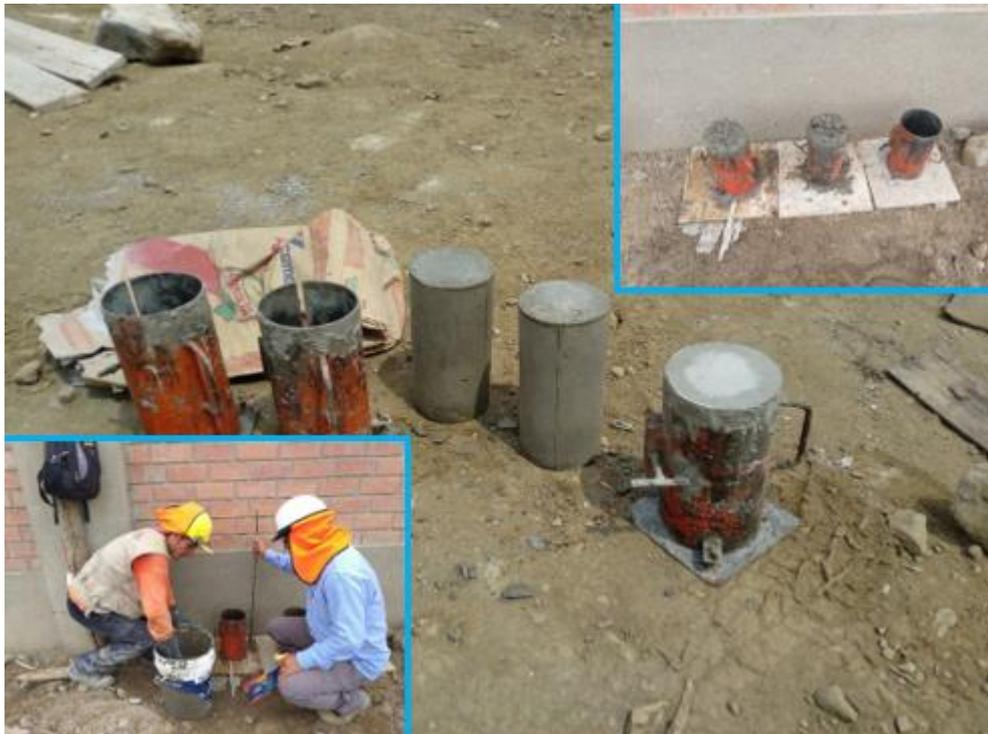
Vista de la toma de muestras de Testigos para pruebas de compresión.
