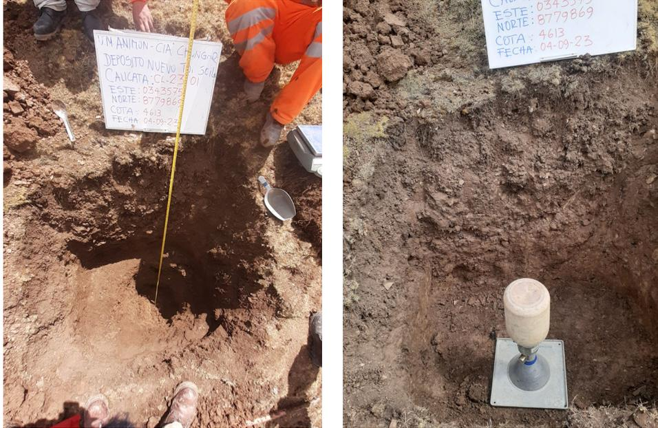
Ensayo de permeabilidad en campo en la calicata CL-23-01
