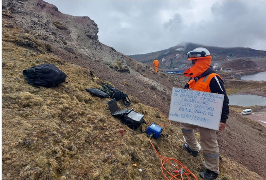
Vista de adquisición de los ensayos sísmicos, línea RS-L-02 / MW-L-05
