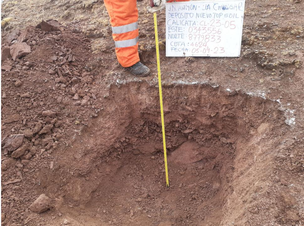
Ensayo de permeabilidad en campo en la calicata CL-23-05
