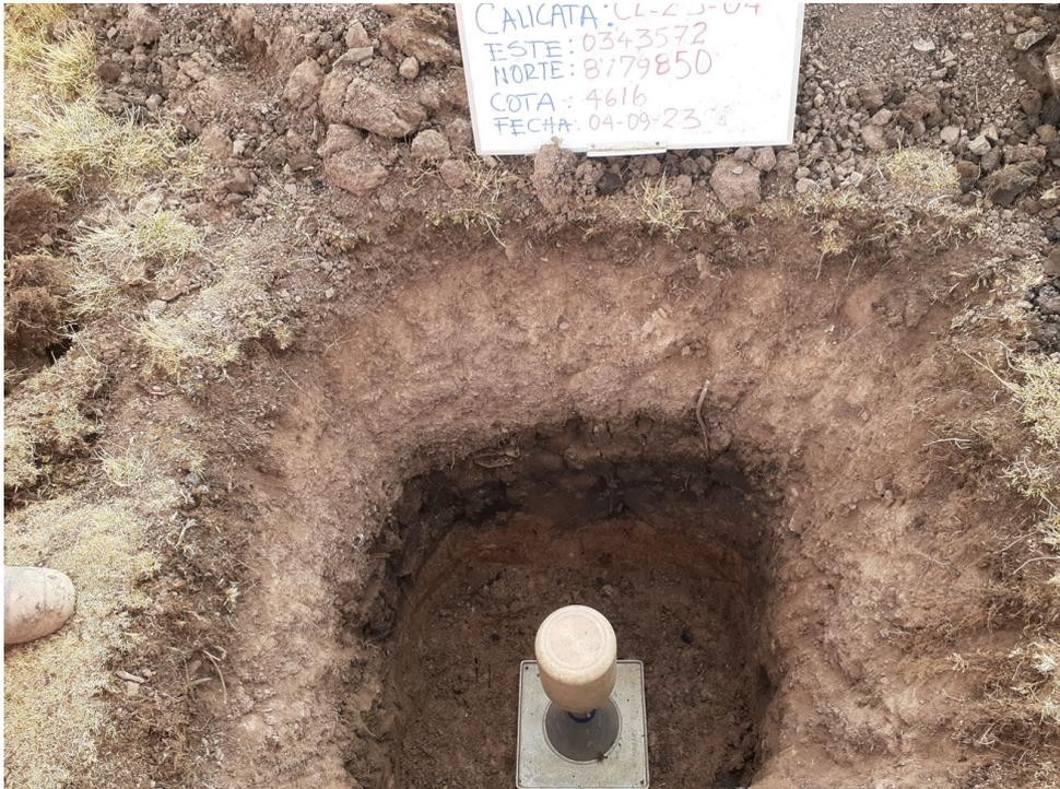
Ensayo de permeabilidad en campo en la calicata CL-23-04
