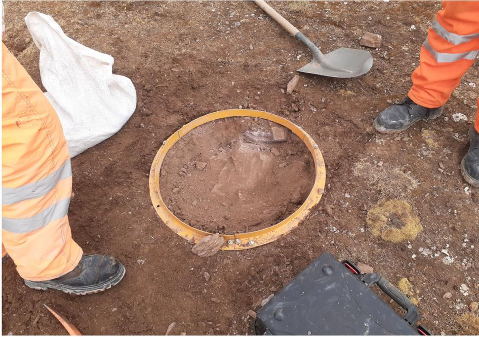
Ensayo de permeabilidad en campo en la calicata CL-23-06
