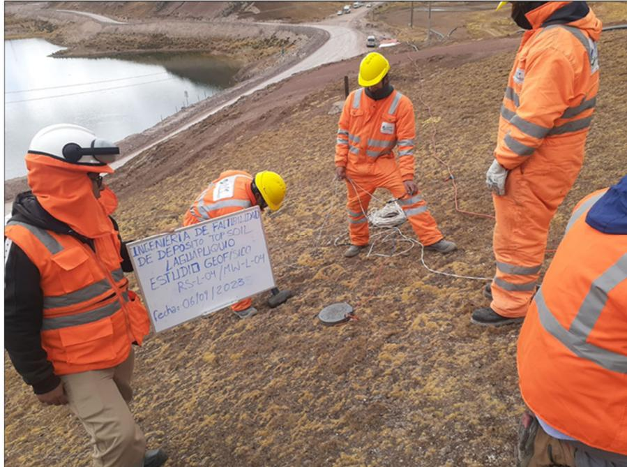
Vista de adquisición del ensayo geoelectrico. Línea TG-L-01
