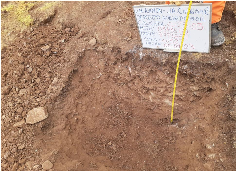
Ensayo de permeabilidad en campo en la calicata CL-23-03
