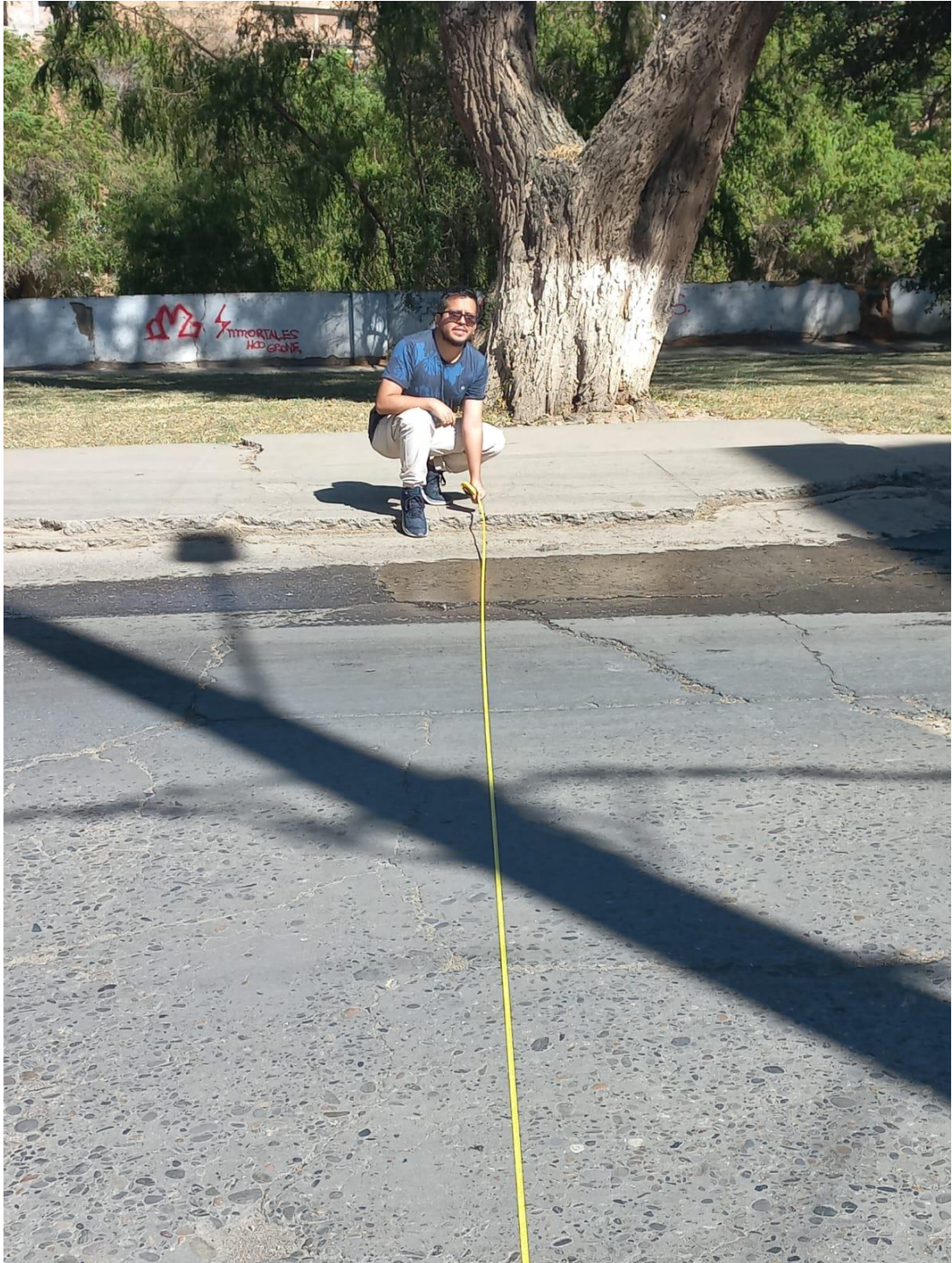
Medición del ancho de la vía
