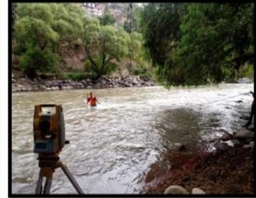
*Se puede apreciar al personal técnico realizando el levantamiento topográfico de las profundidades del centro del río Huallaga*
