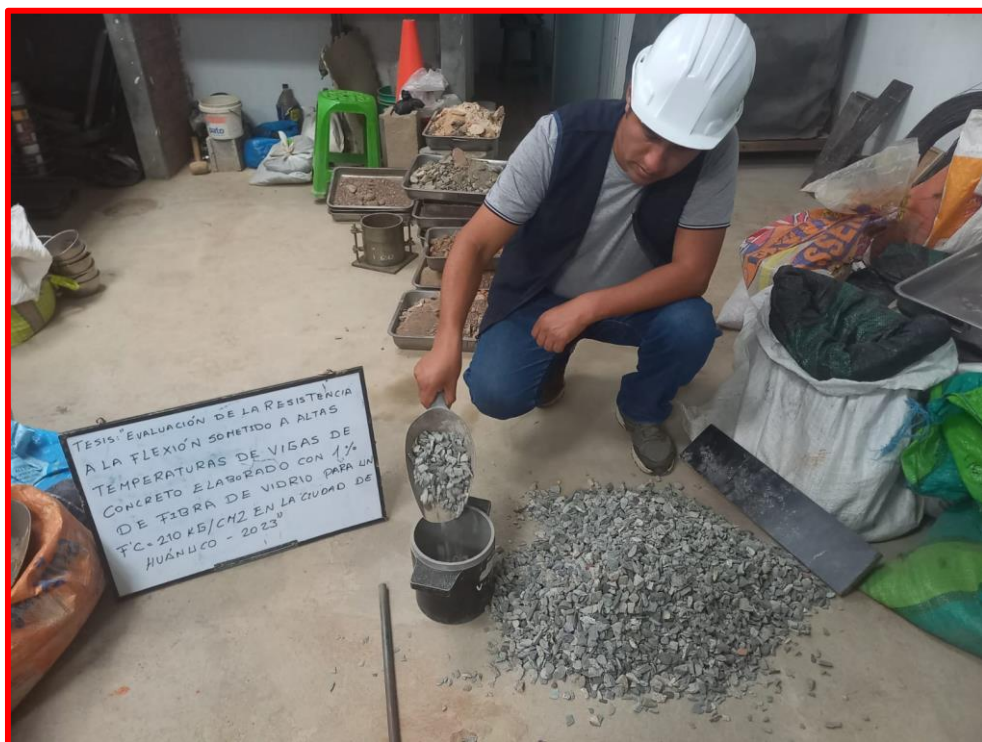
Ensayo del peso volumétrico del agregado grueso
