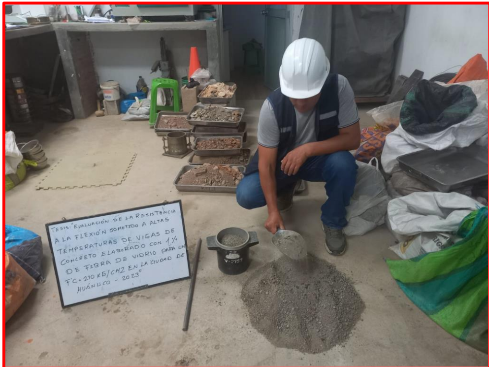
Ensayo del peso volumétrico de los agregados finos
