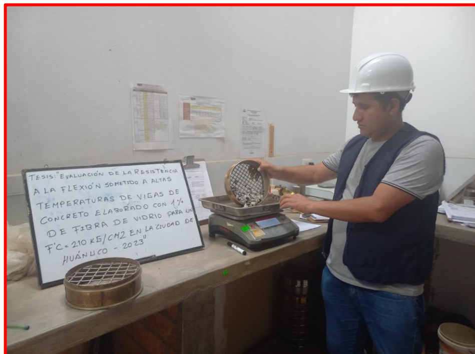
Ensayo de granulometría del agregado grueso
