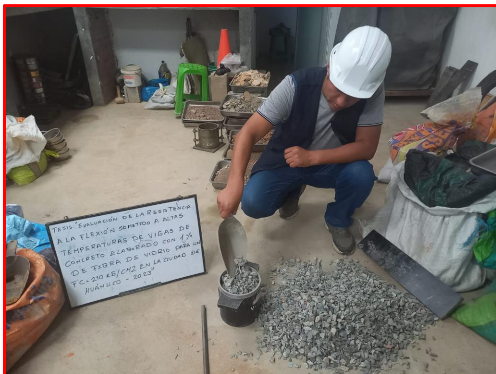
Ensayo del peso volumétrico del agregado grueso
