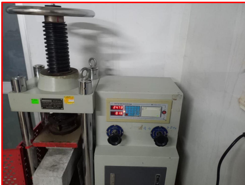
Ensayo de rotura a flexión
