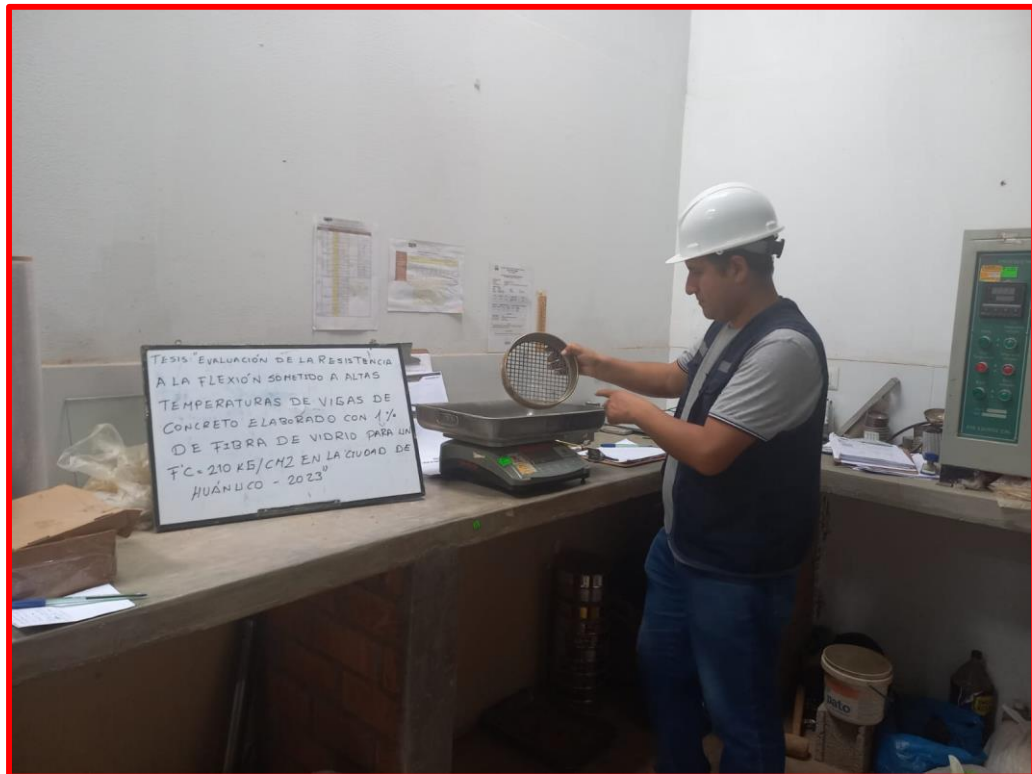
Ensayo de granulometría de los agregados finos
