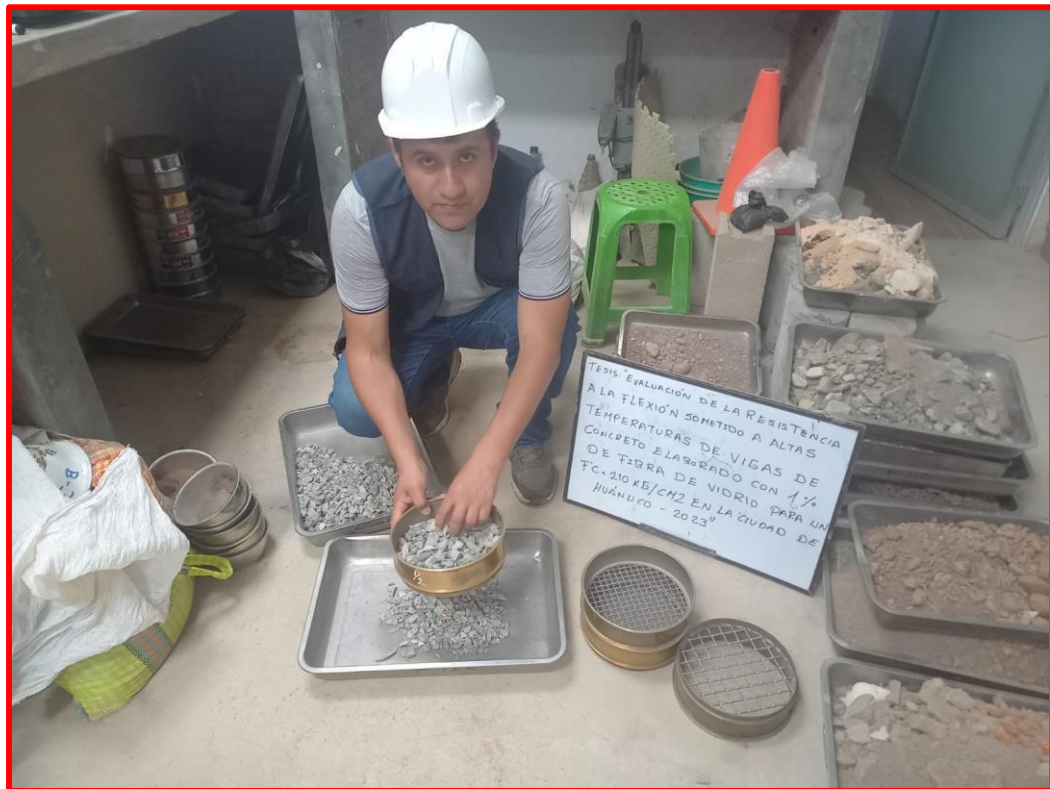
Ensayo de granulometría del agregado grueso
