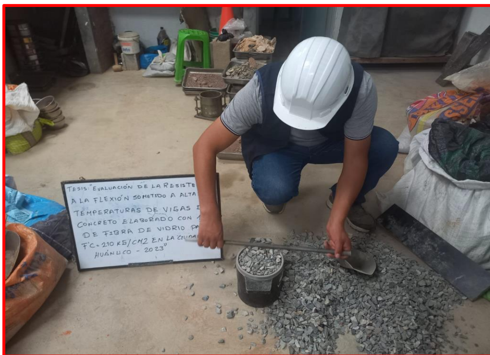
Ensayo del peso volumétrico del agregado grueso
