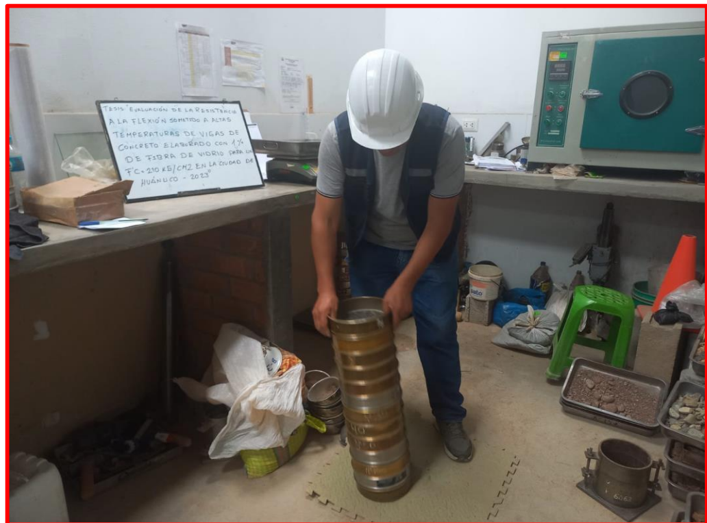
Ensayo de granulometría de los agregados finos
