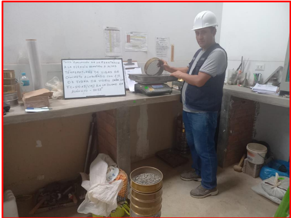
Ensayo de granulometría de los agregados finos
