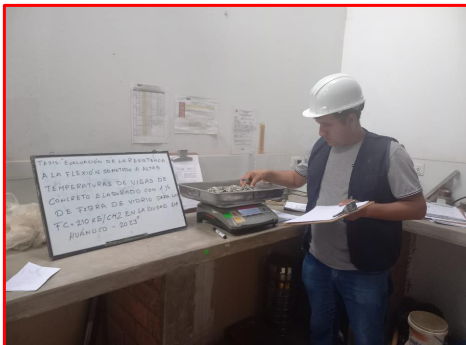
Pesado de los agregados gruesos
