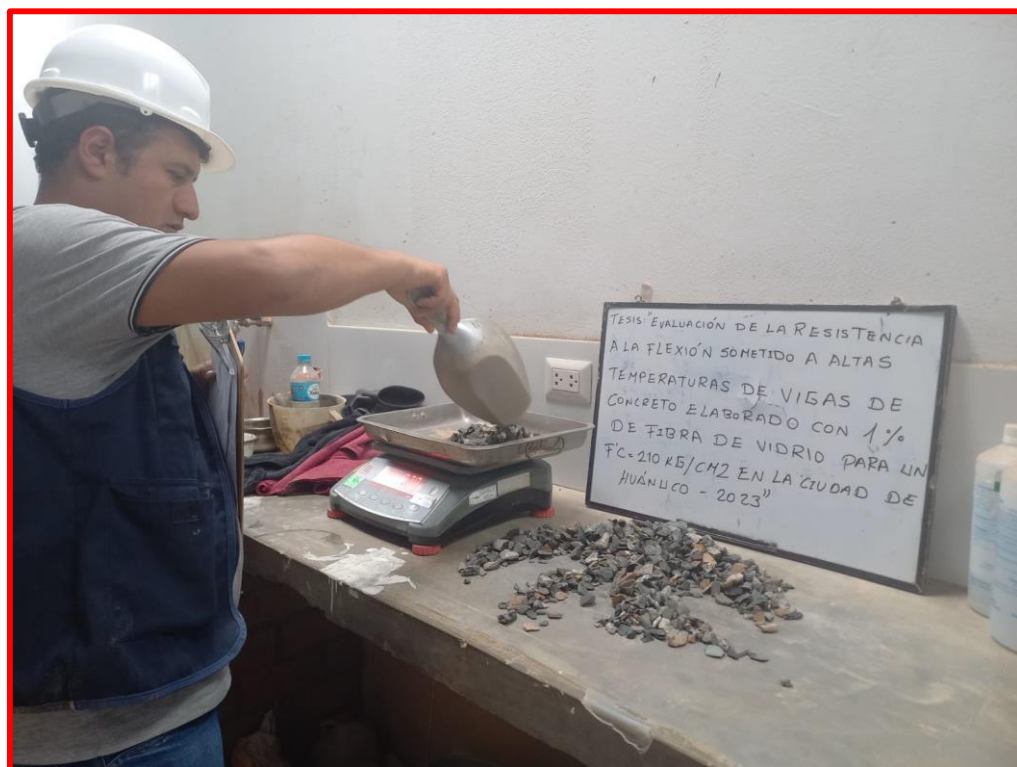
Ensayo de contenido de humedad
