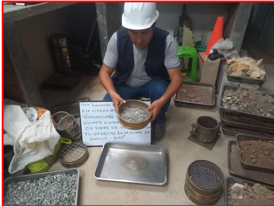
Ensayo de granulometría del agregado grueso
