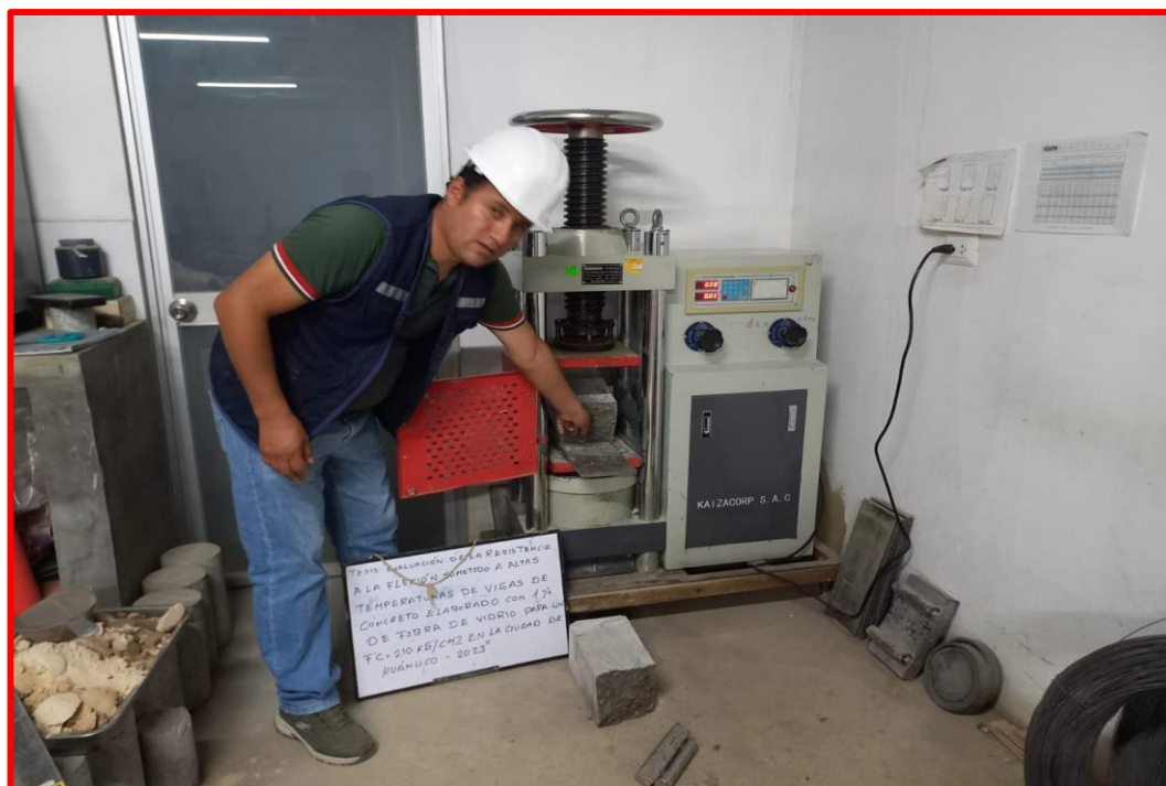
Ensayo de rotura a flexión
