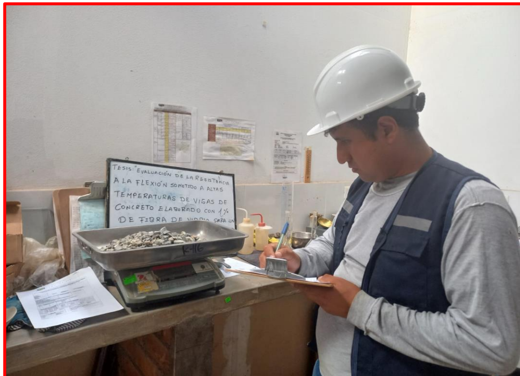
Ensayo de desgaste de los ángeles
