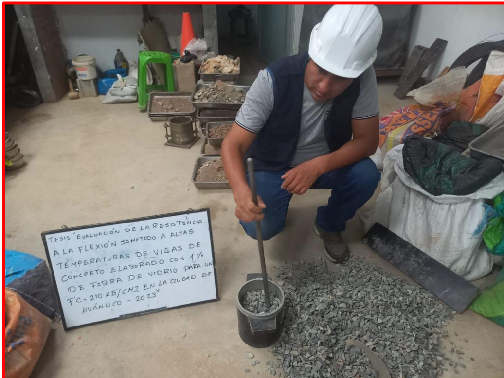
Ensayo del peso volumétrico del agregado grueso
