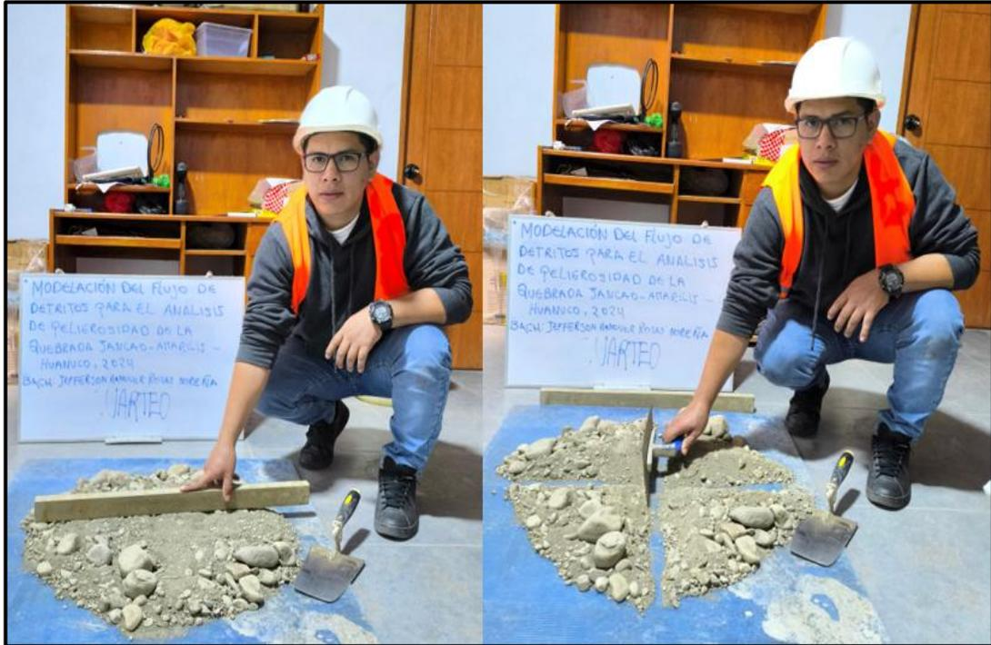
*Nota.* Se aplana la pila cónica hasta darle una base circular de tal manera cada cuarto tenga el material original los materiales de uso según la NTP 339.128.
