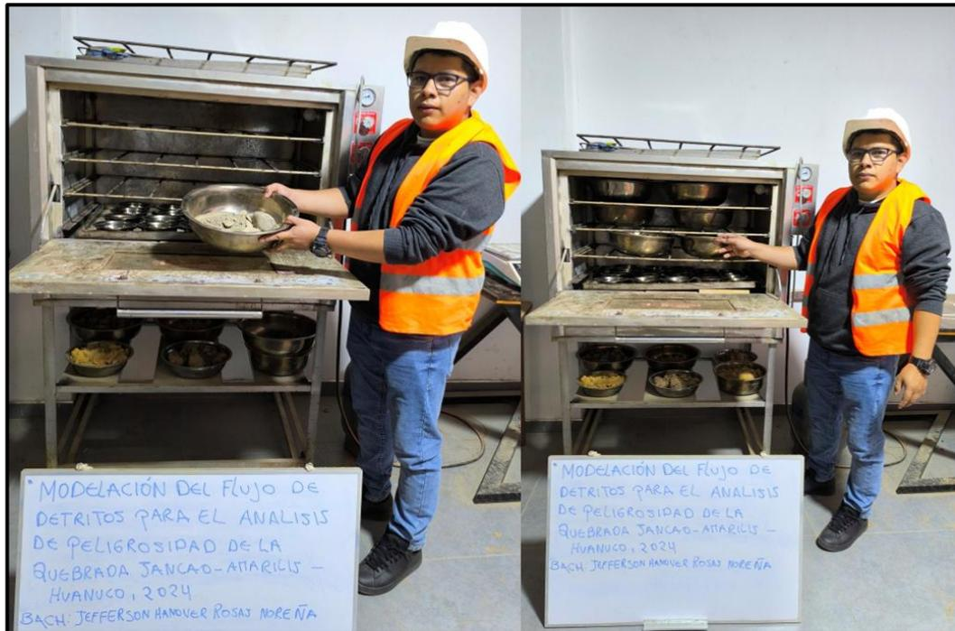
*Nota.* Se secará el material del suelo en el horno durante un periodo de 24 horas según la norma NTP 339.128.
