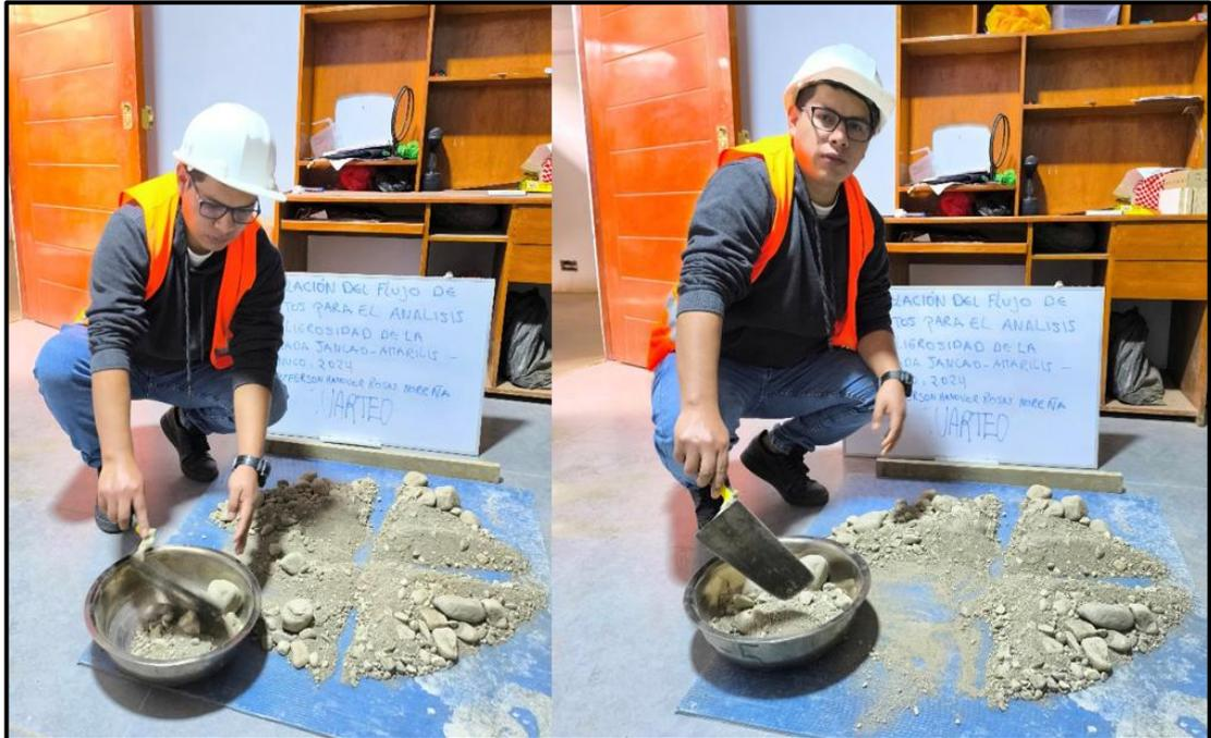
*Nota.* Se aplanan la pila cónica hasta darle una base circular de tal manera cada cuarto tenga el material original los materiales de uso según la NTP 339.128.
