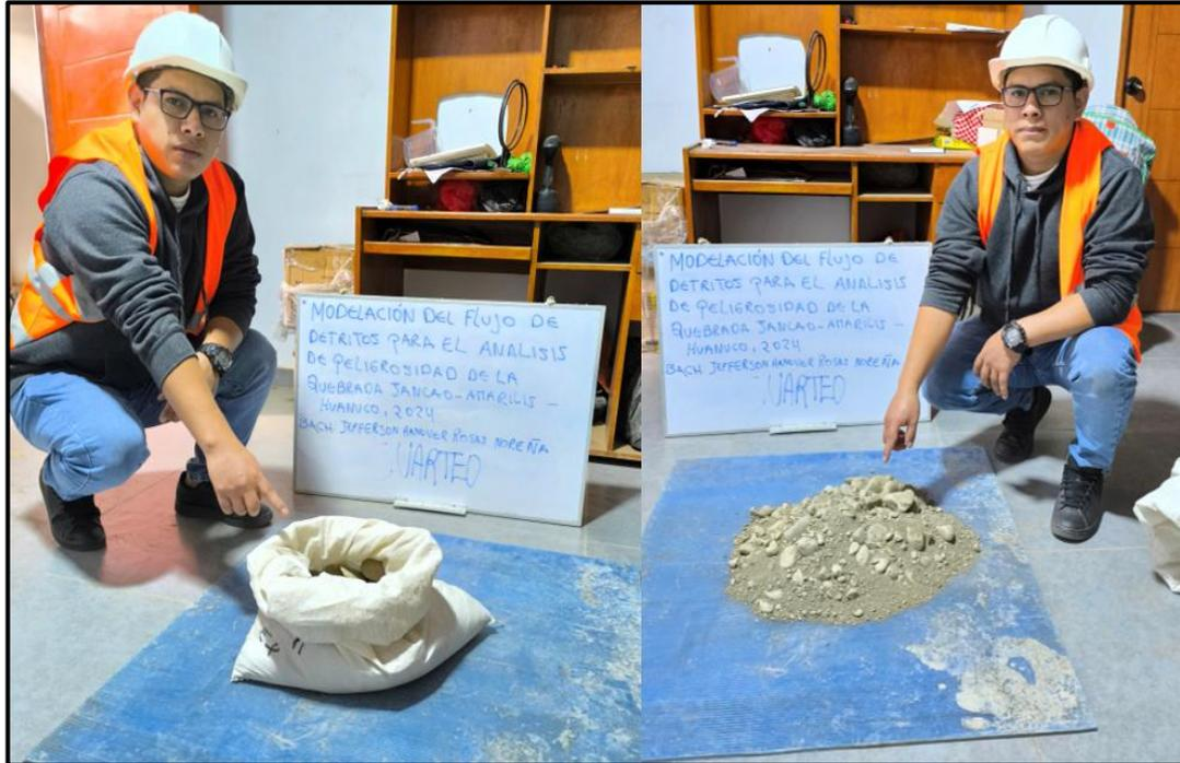
*Nota.* Se coloca el suelo sobre una superficie dura, limpia y horizontal evitando cualquier pérdida de material o la adición de sustancias extrañas según la NTP 339.128.
