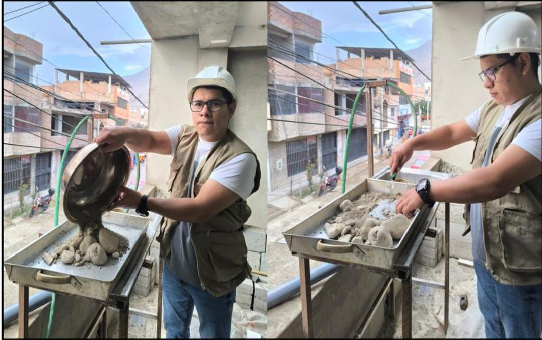
*Nota.* Se lavará la muestra de suelo por la malla N°200 según la norma NTP 339.128.
