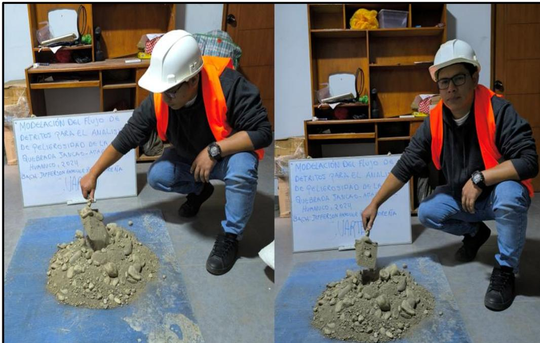
*Nota.* Se apilará el material de forma cónica de modo que el material caiga uniforme por los lados de lo mismo según la NTP 339.128.
