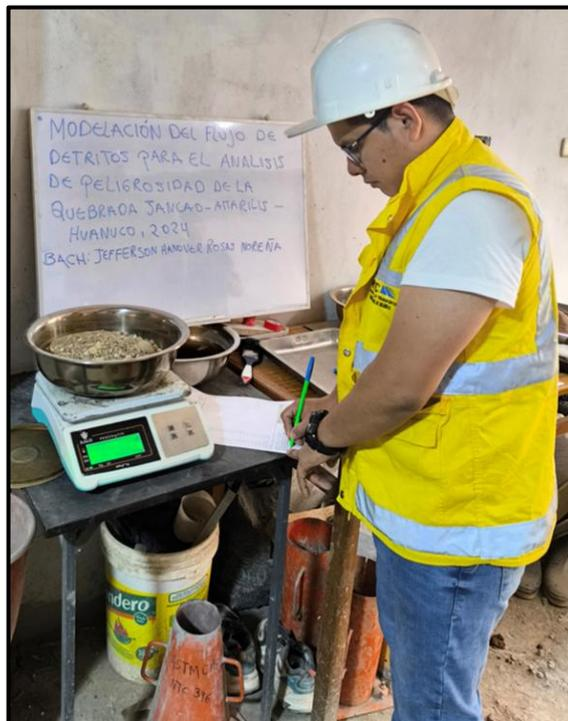
*Nota.* Se pesará el suelo seco después de haber estado en el horno por un periodo de 24 horas según la norma NTP 339.128.
