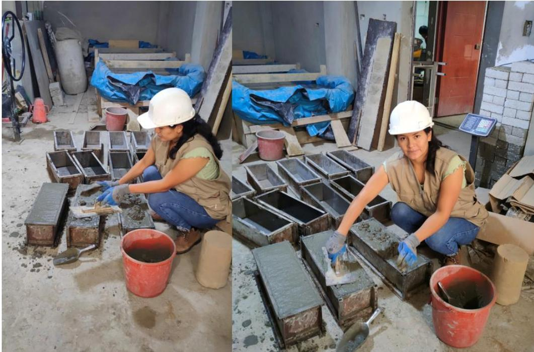
*Nota.* Se nivelará el concreto al ras con una plancha de pulir según lo indica la NTP. 339.079.
