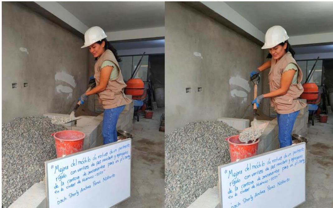
Nota. Se recolectó el agregado grueso de la cantera de Andabamba para la dosificación de mezcla de las vigas con  $F'c= 210 \text{ kg/cm}^2$ .
