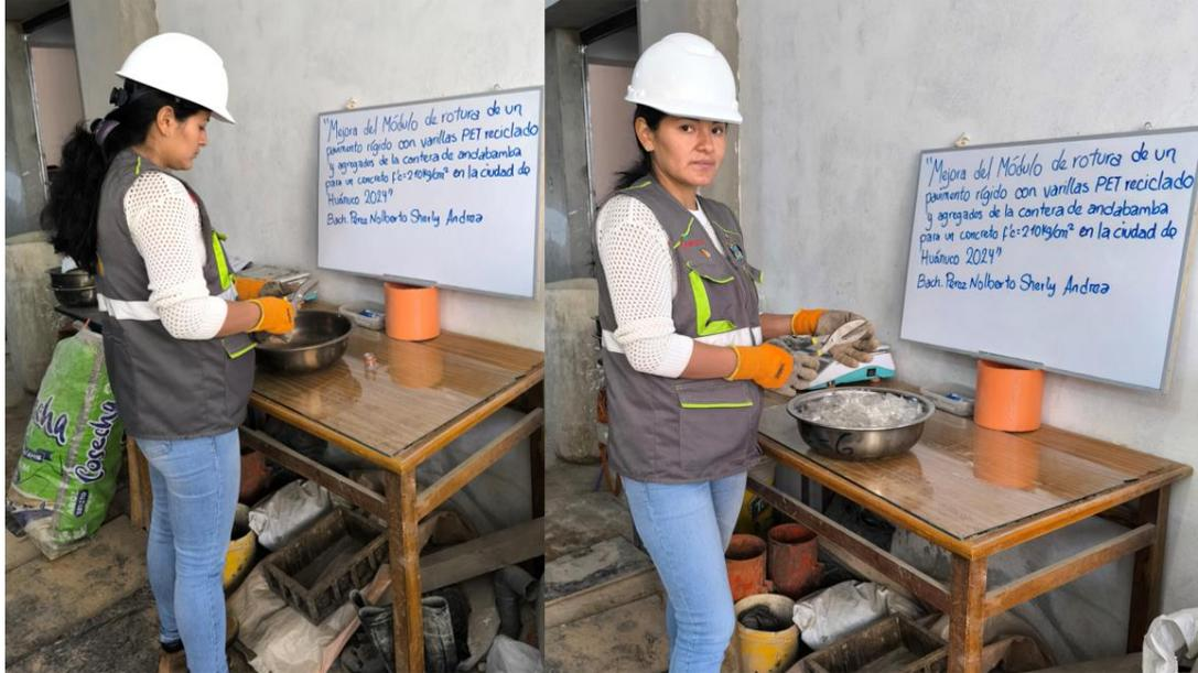
*Nota.* Se cortará en trozos pequeños los plásticos PET para la utilización de la fundición de las varillas.
