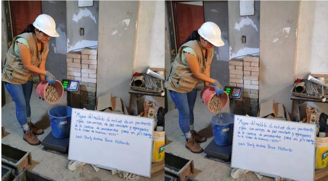
*Nota.* Se pesó el agregado fino según la dosificación de la mezcla con  $F'c= 210 \text{ kg/cm}^2$  como lo indica la norma ACI 211.
