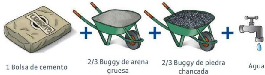
*Nota:* Se muestra la dosificación del concreto manual. Fuente: Manual Aceros Arequipa (2010).
