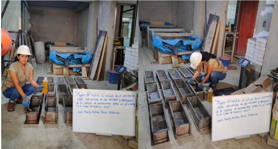
*Nota.* Se le cubrirá las paredes de los moldes de las vigas con un desmoldante para mayor facilidad para desencofrar.
