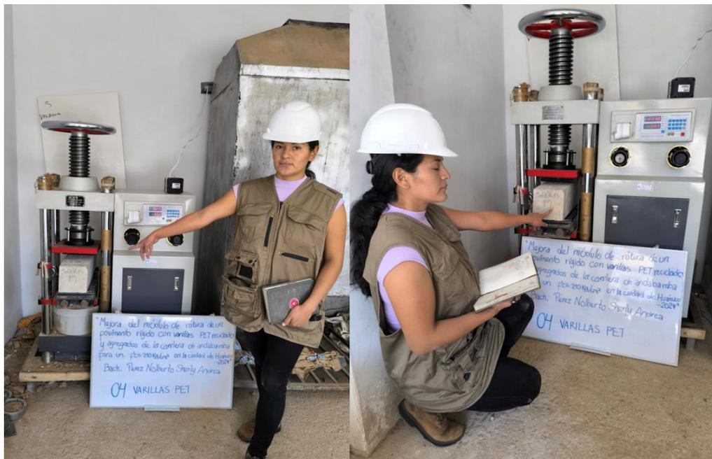
*Nota.* Se aplicará una carga constante de una velocidad de  $0,9 \text{ MPa/min}$  y  $1,2 \text{ MPa/min}$  de a las vigas de concreto con 4 varillas de refuerzo con una resistencia  $F_c= 210 \text{ kg/cm}^2$  como lo estipula la NTP 339.079
