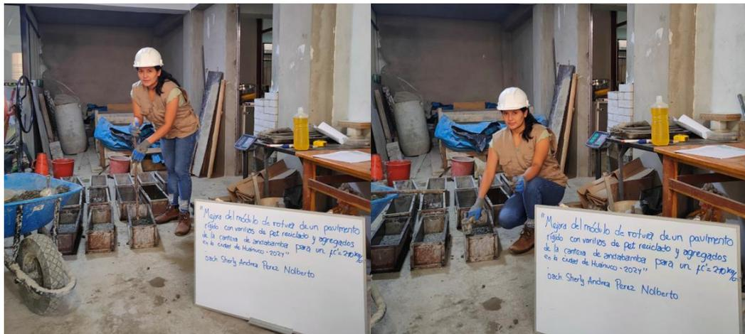
**Nota.** Proceso de elaboración de vigas con  $F'c=210 \text{ kg/cm}^2$ , se compactará a cada 1/2 de volumen por capa usando un hierro redondeado de 16mm de diámetro y aproximado de 600 mm de largo.
