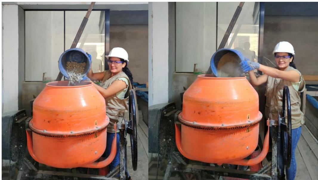
*Nota.* Proceso de elaboración de la mezcla de concreto con  $F'c= 210$   $kg/cm^2$  como lo indica la normativa ACI 211, agregado grueso tamaño máximo nominal  $\frac{3}{4}$  in y el agregado fino tamaño máximo nominal nro. 4 según la NTP 400.012.
