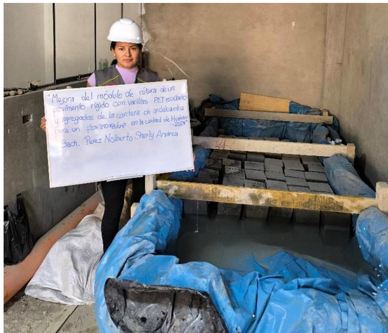
*Nota.* Después del fraguado se pondrá a curar las vigas hasta los días de ensayo de resistencia a la flexión.
