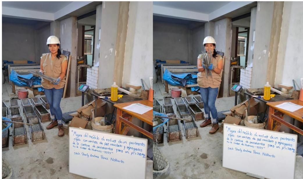
*Nota.* Se muestran las varillas PET con dimensiones 3/8 de diámetro y de largo 45 cm que se usaran como refuerzo en las vigas con  $F'c= 210 \text{ kg/cm}^2$ .
