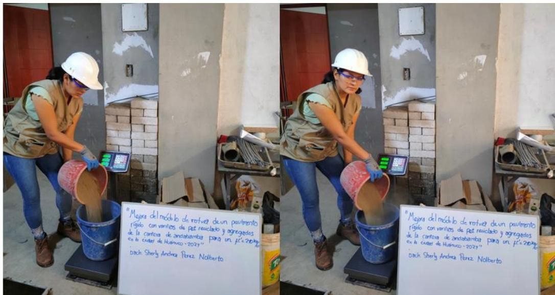
Nota. Se pesará el agregado fino según la dosificación de mezcla con un  $F'c= 210 \text{ kg/cm}^2$  como lo indica la norma ACI 211.
