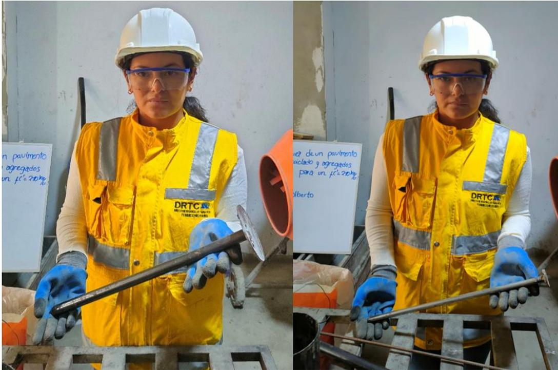
*Nota.* El pisón metálico se usará para empujar a presión el PET fundido.
