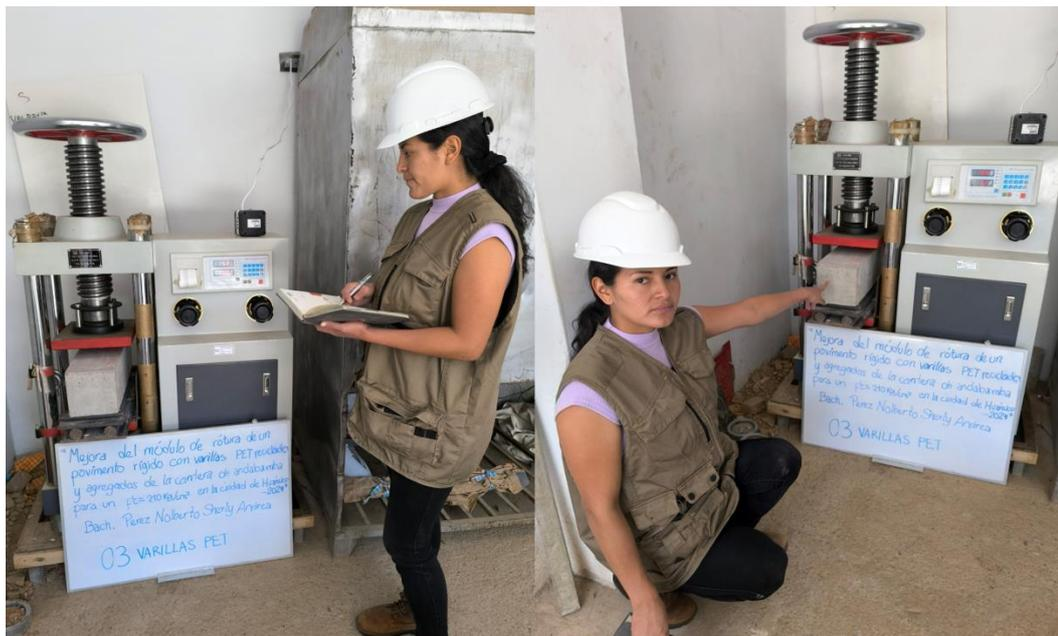
*Nota.* Se aplicará una carga constante de una velocidad de  $0,9 \text{ MPa/min}$  y  $1,2 \text{ MPa/min}$  de a las vigas de concreto con 3 varillas de refuerzo con  $F'c= 210 \text{ kg/cm}^2$  como lo estipula la NTP 339.079.
