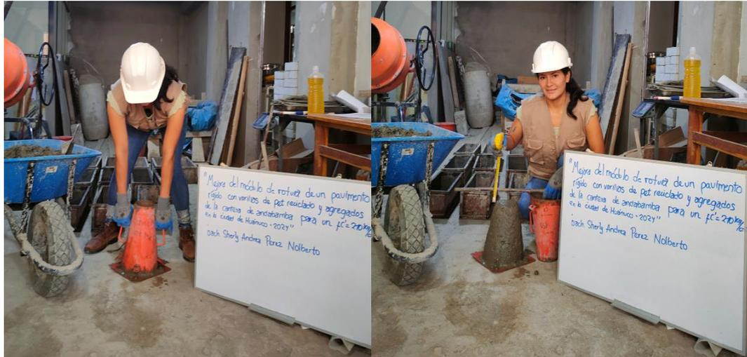
**Nota.** Proceso del ensayo del Slump al terminar la compactación de los 25 golpes por cada capa 1/3 se levantará el molde y se invertirá para poder medir desde su base y poder determinar su asentamiento lo cual dio una medida de 3 in (plástica) según lo indica la NTP. 339.035.
