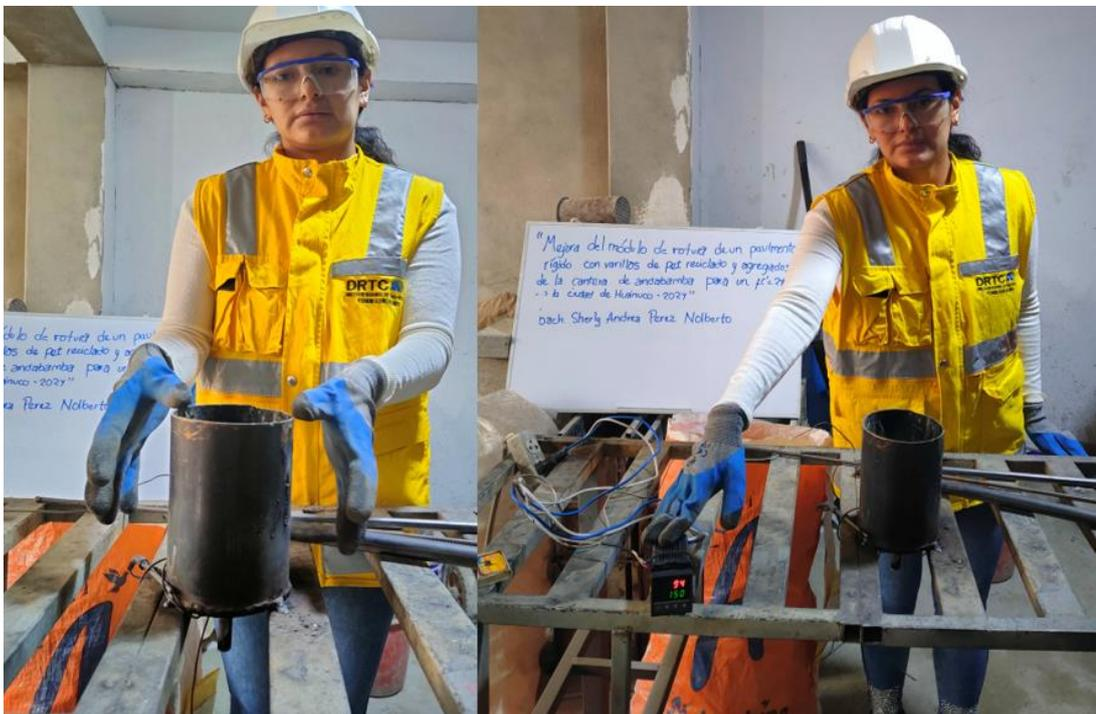
*Nota.* Para la elaboración de las varillas PET se usará el termostato para controlar su temperatura.
