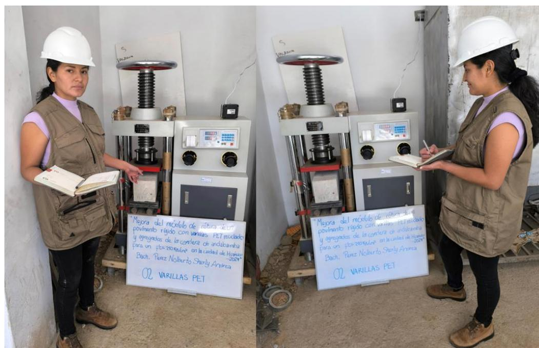
*Nota.* Se aplicará una carga constante de una velocidad de  $0,9 \text{ MPa/min}$  y  $1,2 \text{ MPa/min}$  de a las vigas de concreto con 2 varillas de refuerzo con una resistencia  $F'c= 210 \text{ kg/cm}^2$  como lo estipula la NTP 339.079.
