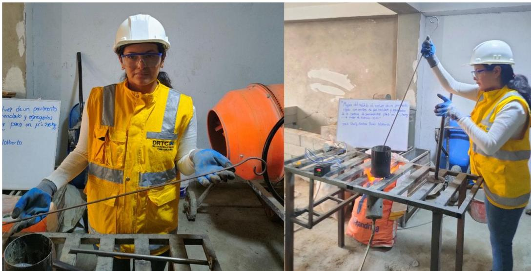
*Nota.* Se usará la varilla metálica para mezclar y remover el plástico PET fundido.
