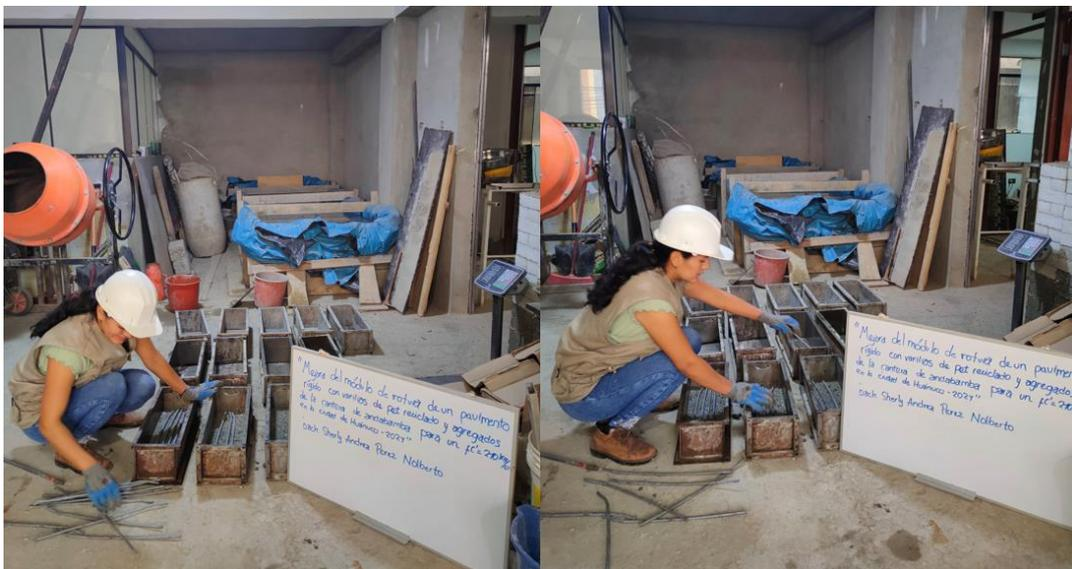
*Nota.* Se usan en las vigas con una resistencia  $F'c= 210 \text{ kg/cm}^2$  4 varillas PET como refuerzo.
