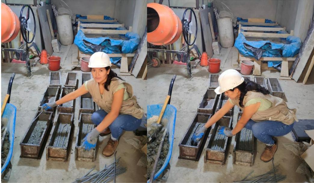
*Nota.* Se usan en las vigas con una resistencia  $F'c= 210 \text{ kg/cm}^2$  3 varillas PET como refuerzo.
