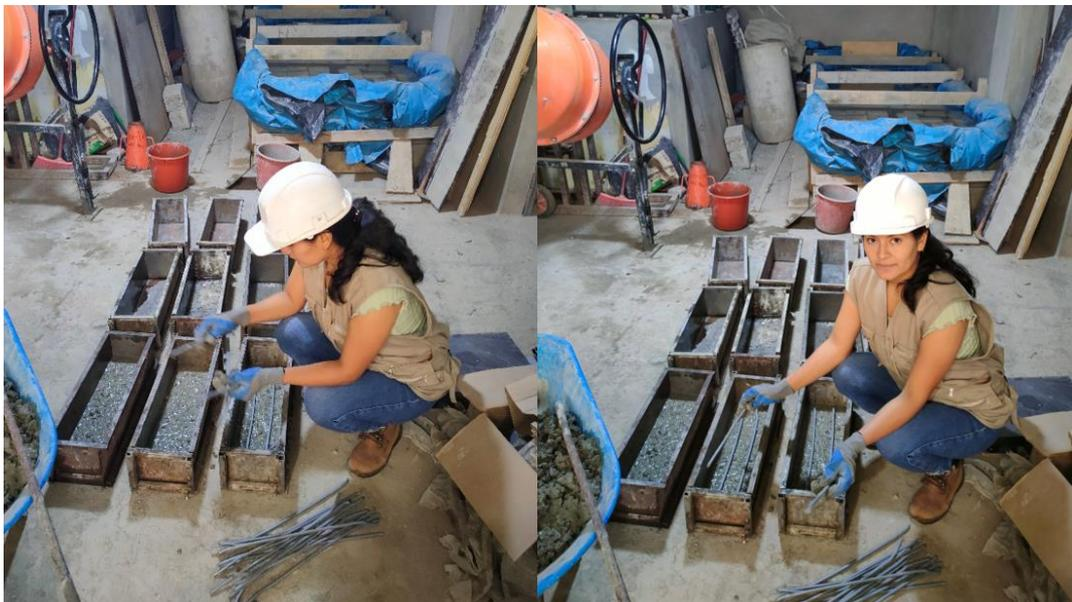
*Nota.* Se usan en las vigas con una resistencia  $F'c= 210 \text{ kg/cm}^2$  2 varillas PET como refuerzo.
