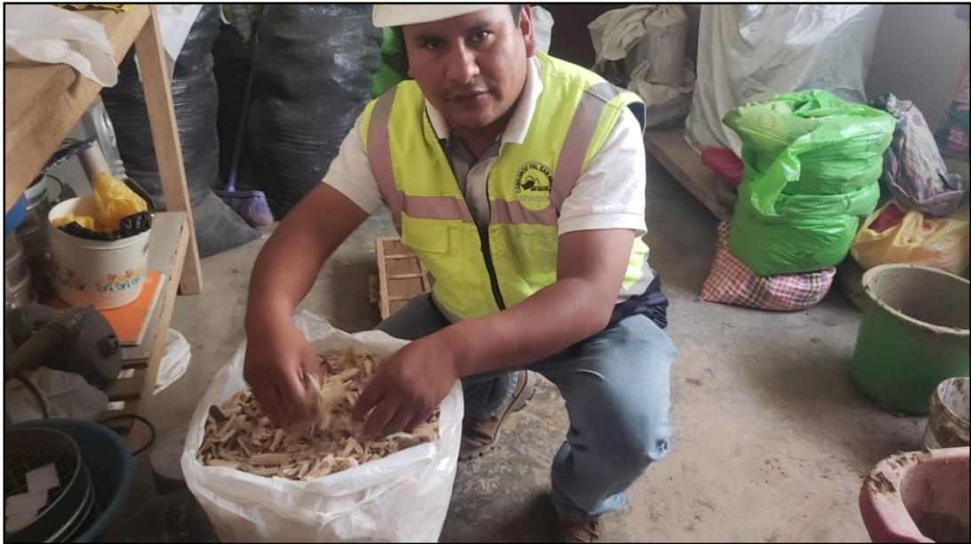
*Nota. La figura muestra las fibras provenientes del bagazo de caña*
