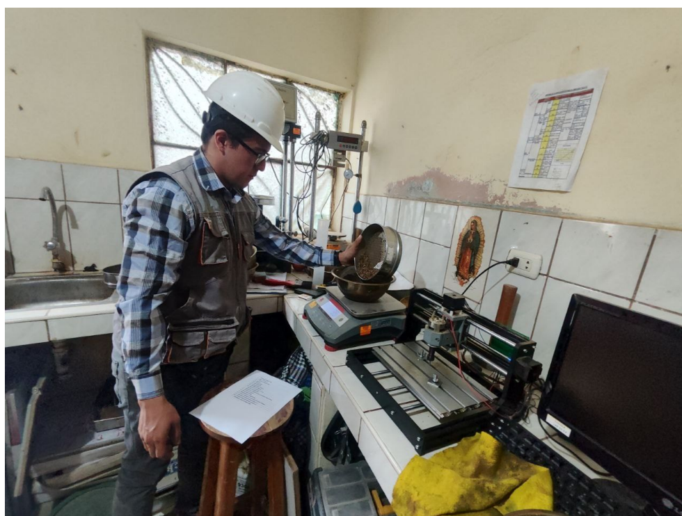
Pesaje de cada material retenido en cada malla
