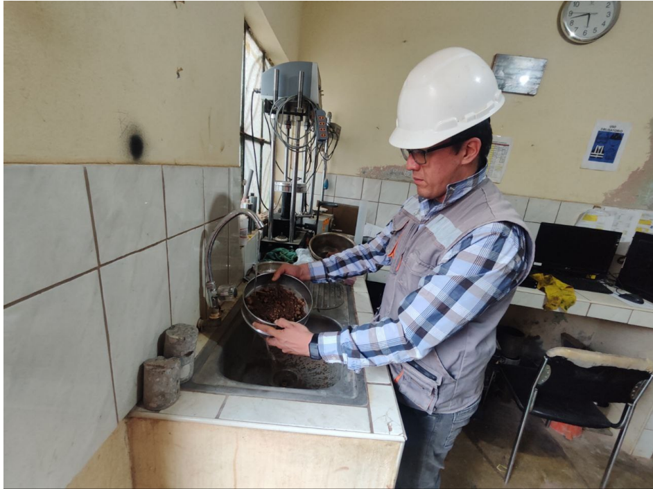
Lavado de la muestra, partículas que pasan la malla N°200
