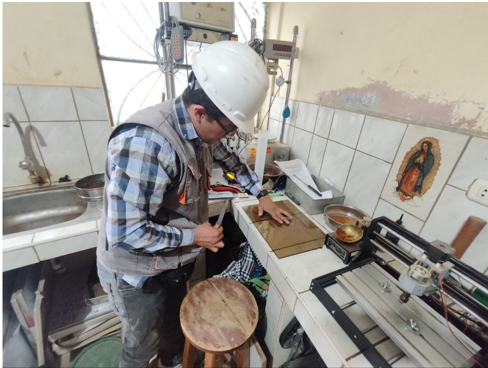
Preparación del material para la determinación del límite plástico
