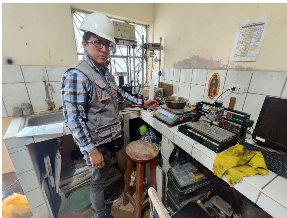
Pesado posterior al secado de la muestra, obtención del contenido de humedad
