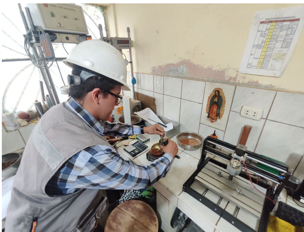
Ensayo de plasticidad, equipo utilizado: copa de Casagrande
