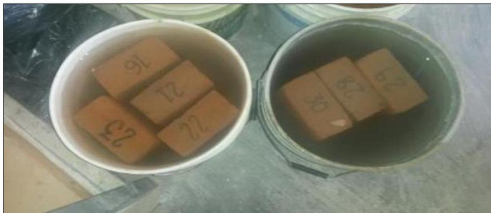
*Nota.* Proceso del ensayo de absorción del adobe. Fuente: (Gonzales y Lizarraga, 2015).
