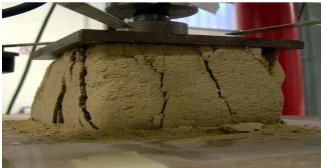
*Nota.* Ensayo de compresión del adobe. Fuente: Imagen sacada del sitio web researchgate.net.
