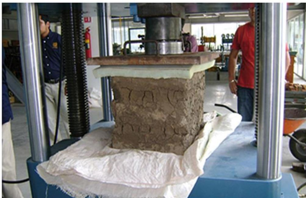
*Nota.* Ensayo de compresión del adobe. Fuente: Imagen sacada del sitio web espacioimasd.unach.mx.
