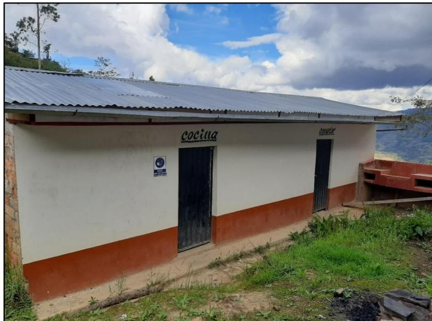
Lavaderos 01, 02, 03 y 04, construido mediante ladrillo King Kong de 13cm. de ancho con acabado pulido. las estructuras que lo conforman se encuentran parcialmente deterioradas, pero operativas.
