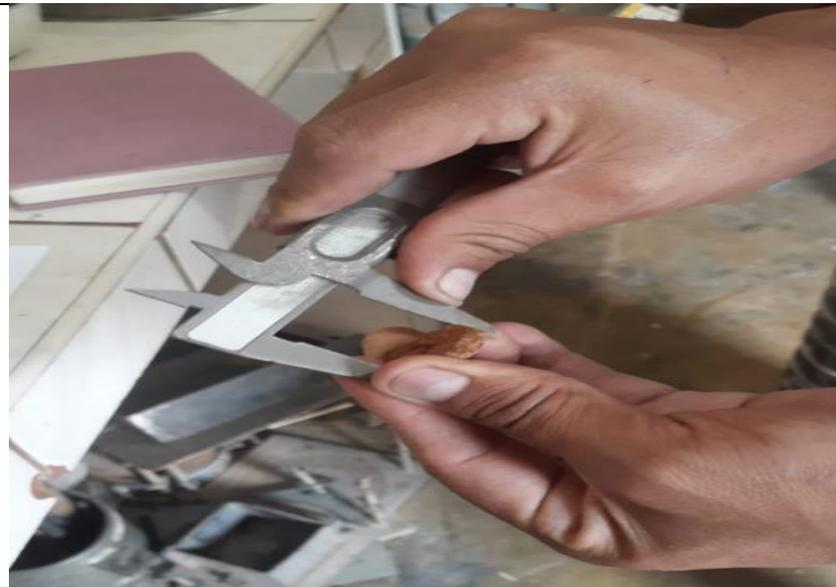
1. CANTIDAD DE MUESTRA: según la muestra que se sacó se procedió a medir y nos dio 3/8 por lo tanto se extrajo una muestra de 500 g para realizar el ensayo de granulometría.
