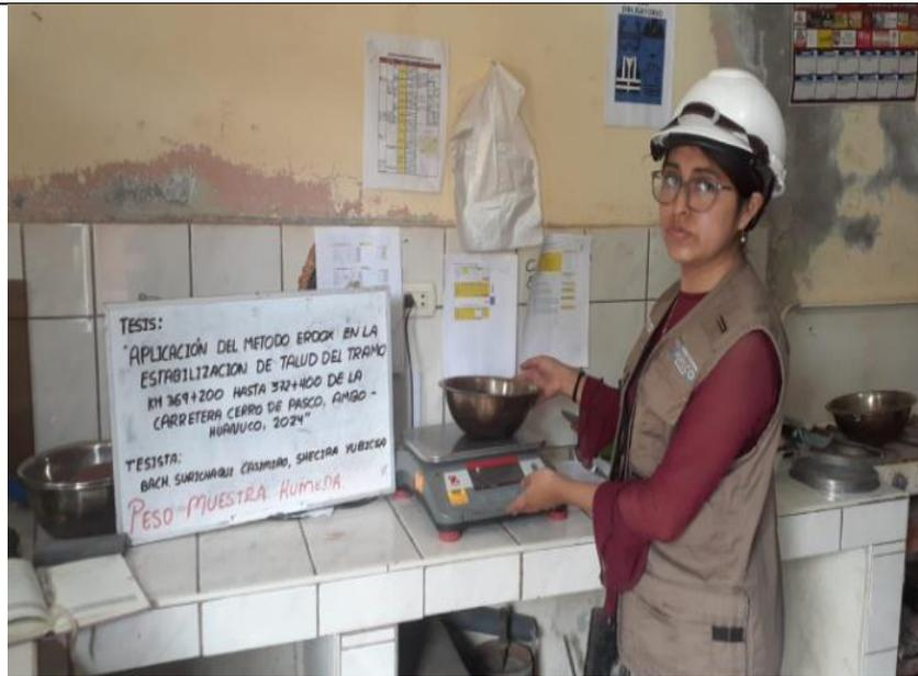
1. PESO MUESTRA HUMEDA: se realiza el peso de la muestra húmeda, (se tomó una muestra de 500 g), esto debido a que se midió la muestra y se encontró un límite de 3/8.
