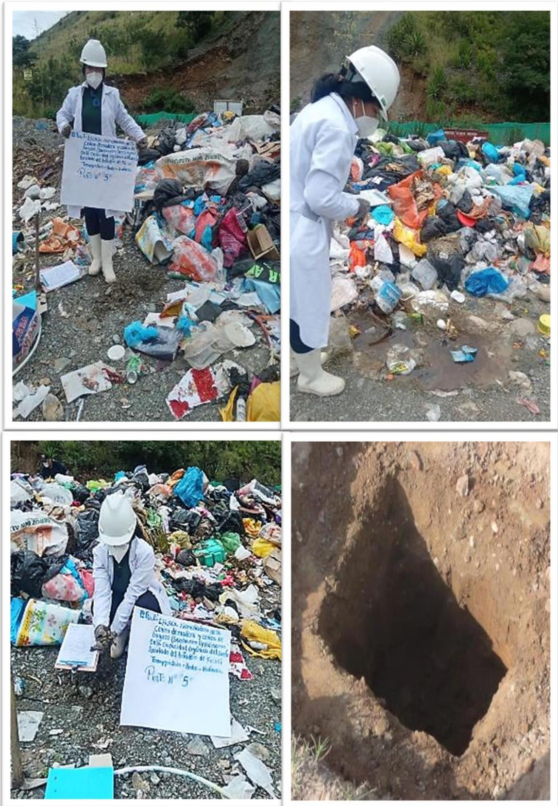
**FOTO:** Elección de puntos para excavación según la guía para el muestreo de suelos Minam\_2014, punto n°5 de muestra de suelo profundidad de excavación de 1 metro.
