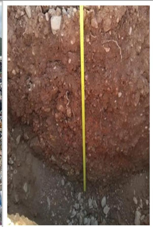
**FOTO:** Elección de puntos para excavación según la guía para el muestreo de suelos Minam\_2014, punto n°1 de muestra de suelo profundidad de excavación de 1 metro.
