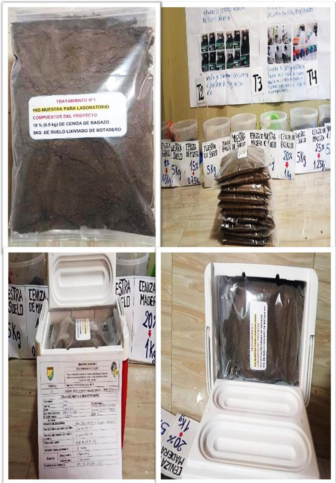
**FOTO:** Colocación de muestras de tratamiento en un cooler con su respectivo formato, las muestras con sus etiquetas correspondientes de los porcentajes en las bolsas de Ziploc de doble cierre.
