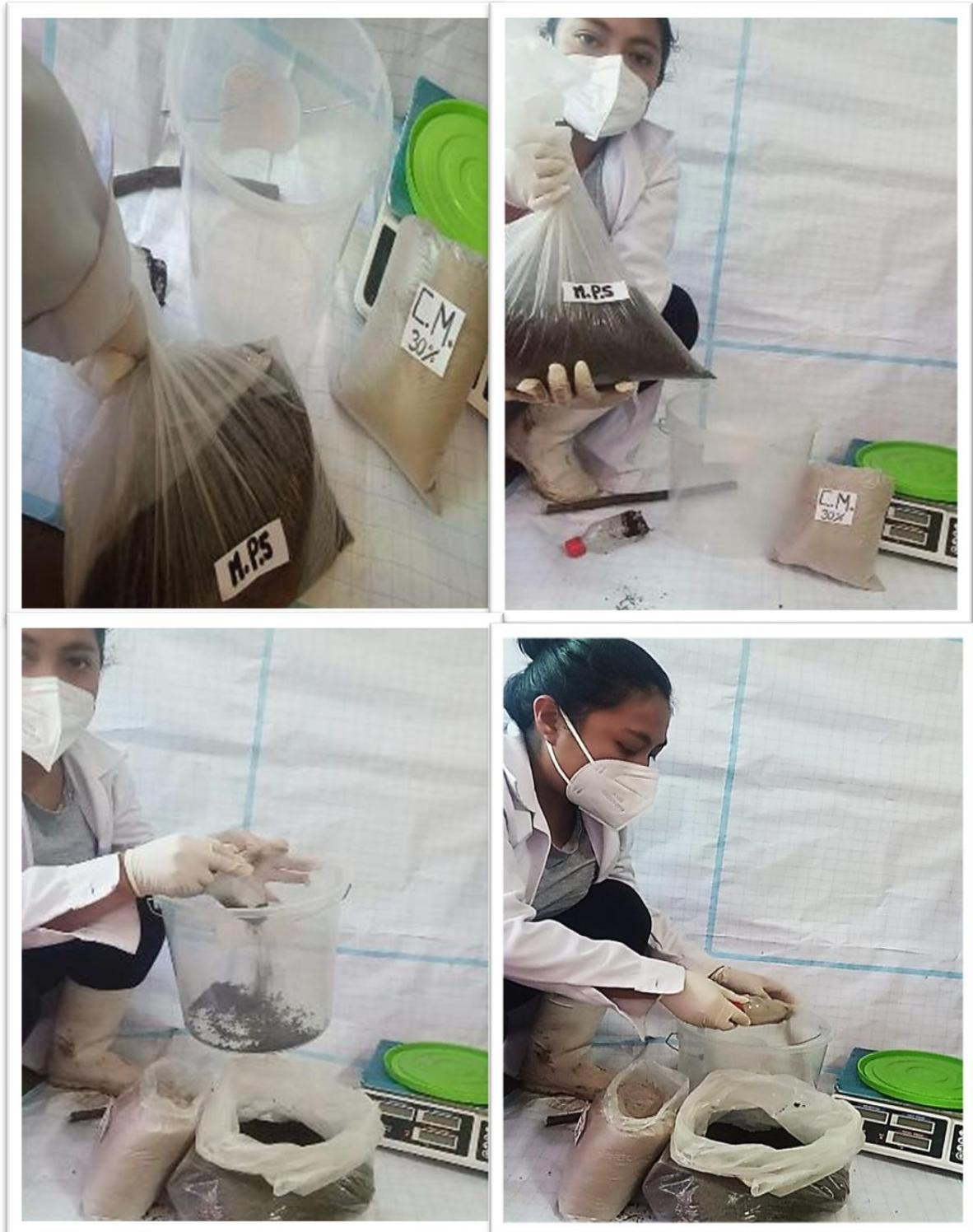
**FOTO:** Homogenización en recipiente del suelo lixiviado con ceniza de madera y ceniza de bagazo.
