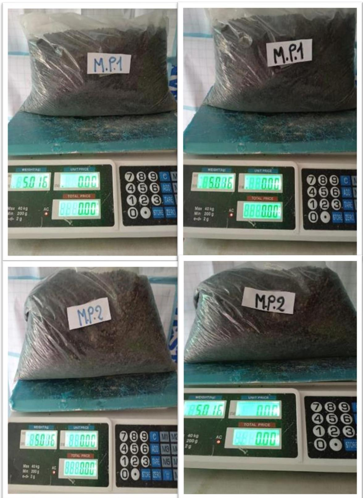
**FOTO:** Cada muestra ya zarandeada fueron colocados en bolsas polietileno de 5kg con sus respectivas etiquetas.
