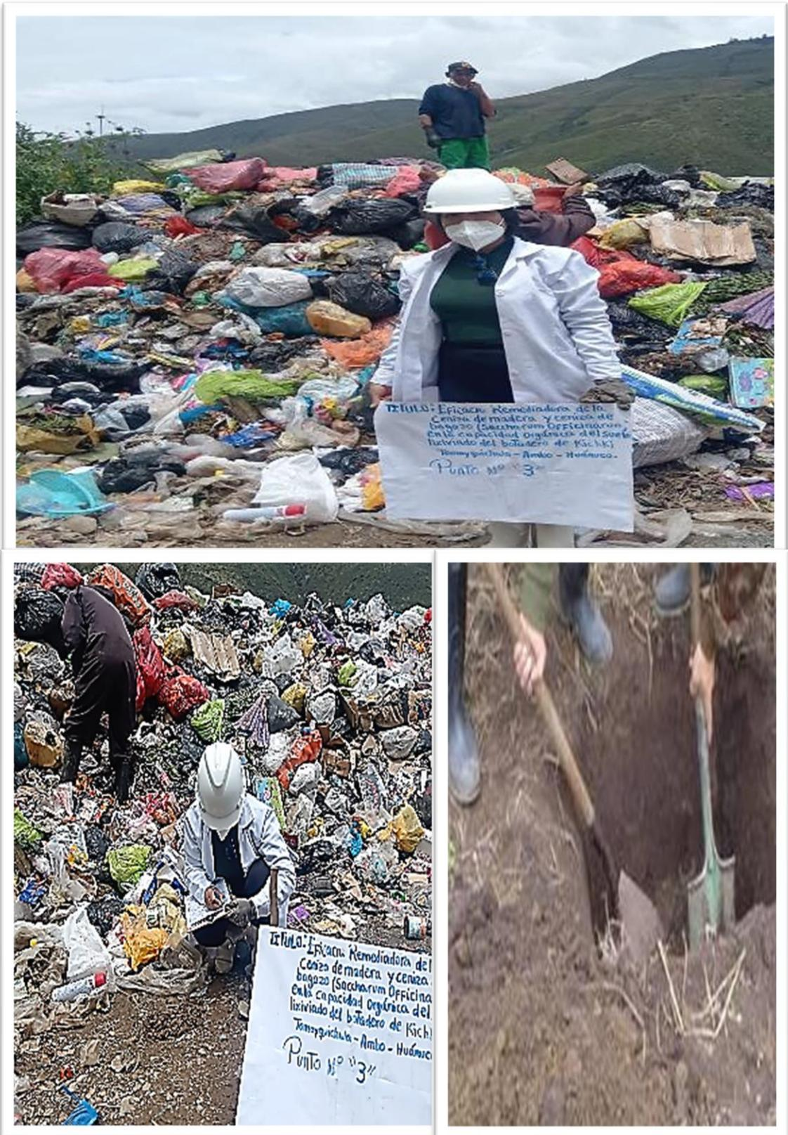
**FOTO:** Elección de puntos para excavación según la guía para el muestreo de suelos Minam\_2014, punto n°3 de muestra de suelo profundidad de excavación de 1 metro.
