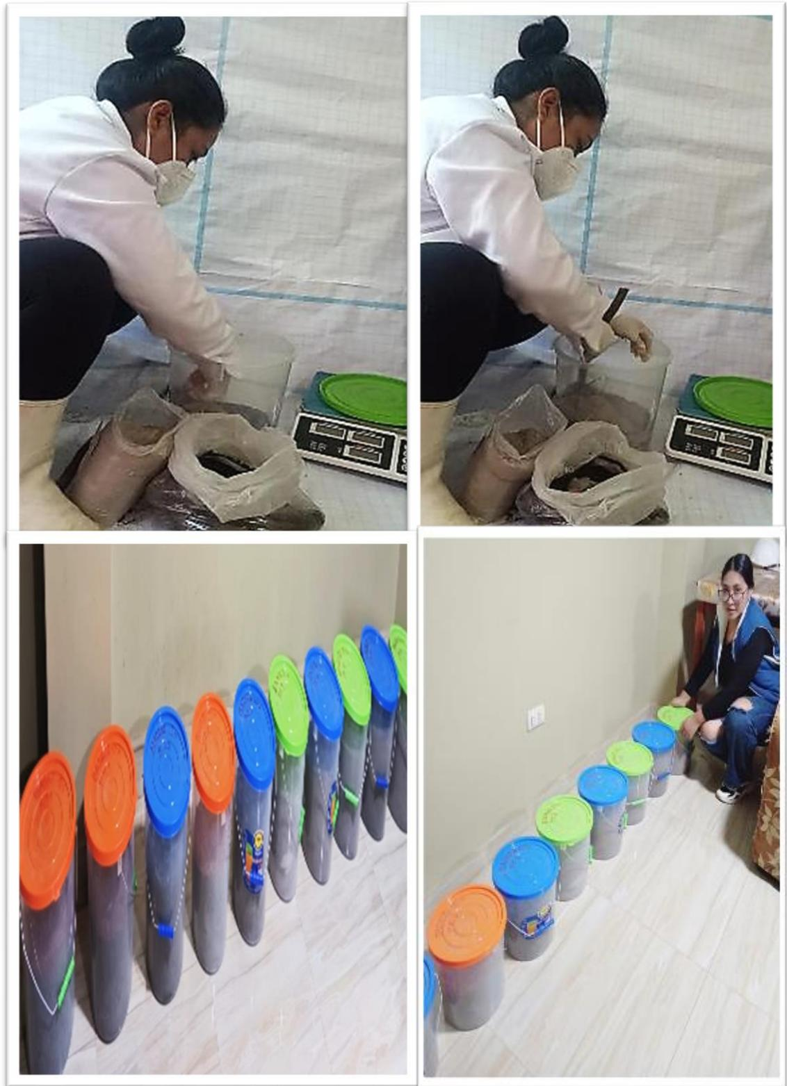
**FOTO:** Homogenización del suelo lixiviado con ceniza de madera y ceniza de bagazo en los recipientes según tratamiento en recipiente se marcó en las tapas el tratamiento y porcentaje correspondiente.
