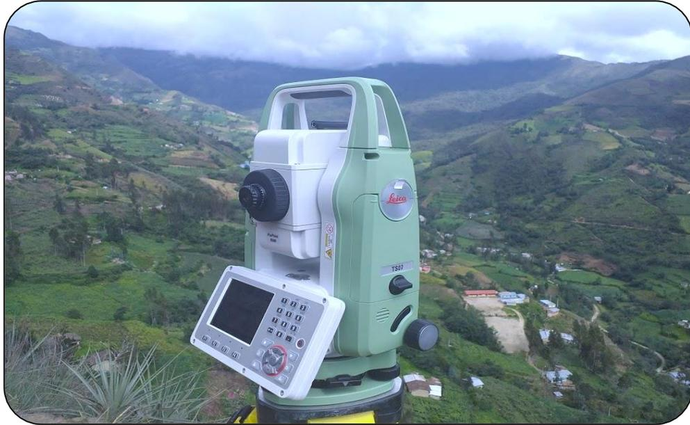
*Nota.* Levantamiento topográfico de la localidad de Montehuasi (desde la Localidad de Cochato). Con la estación total Leica TS 07.
