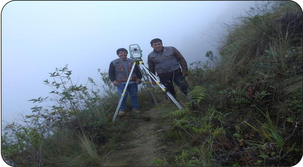
*Nota.* Levantamiento topográfico desde la ubicación del reservorio en la parte alta de Montehuasi. Con la estación total Leica TS 07.
