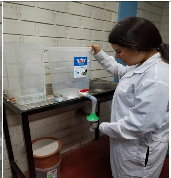
Elaboración del dispensador que alimentara al filtro.
