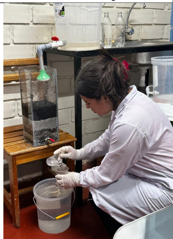
Toma de muestra del agua filtrada.
