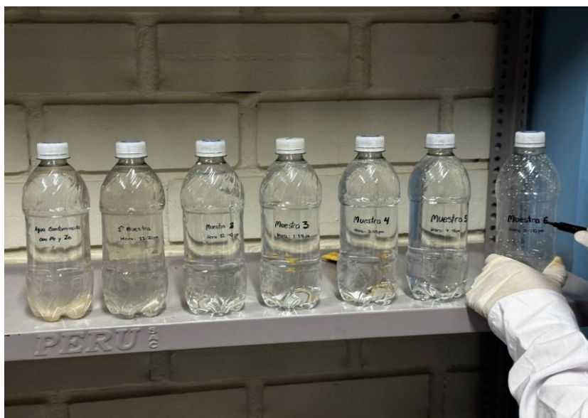
Muestras de agua contaminad (inicial) y filtradas.
