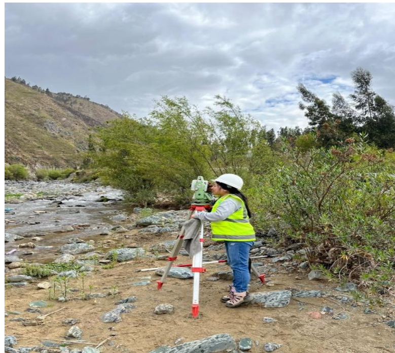
Fotografía: Se visualiza el levantamiento topográfico de la cuenca donde se realizando el estudio de trabajo de investigación.
