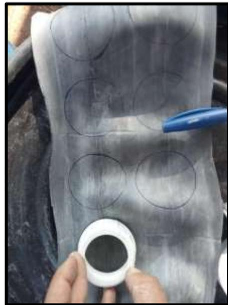
Uso de adaptadores pvc 1/2" en modelo para envoltura de jebe simulando una huacha de jebe
