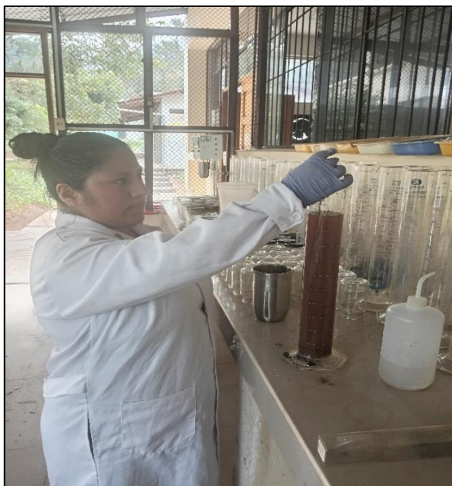
Fotografía 13: Análisis físicos del suelo (método de la probeta).
