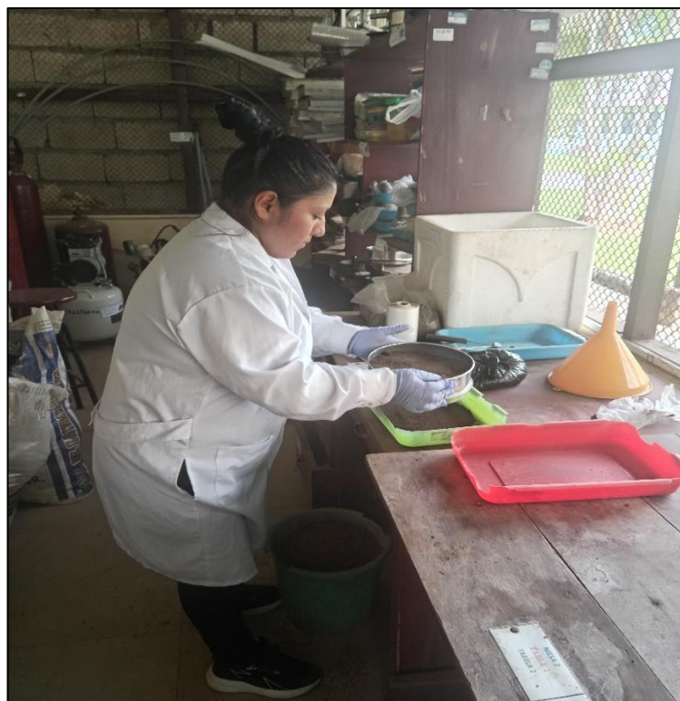
Fotografía 12: Tamizado de suelo en el laboratorio para el análisis físicos y químicos.
