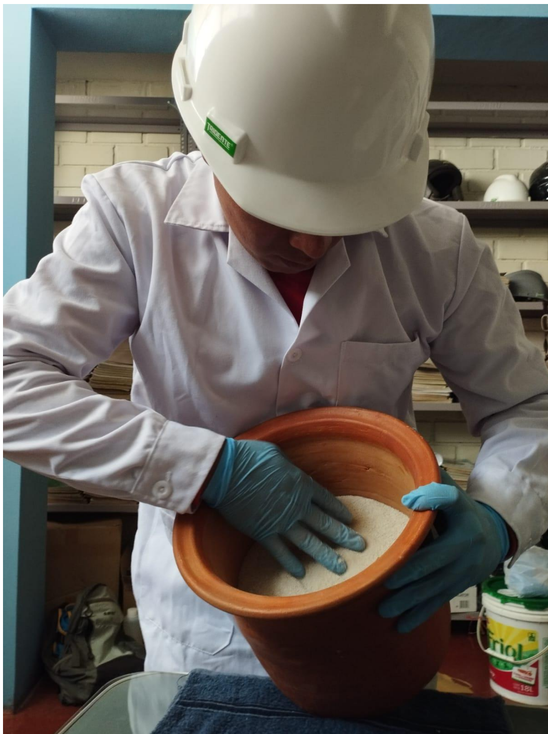
ARMADO DE CAPAS CON ARENA DE CUARZO EN EL ARCI - FILTRO
