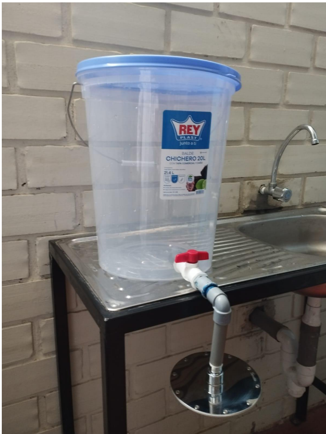
TANQUE DE ALMACENAMIENTO PARA EL AGUA CONTAMINADA DE 20LT
