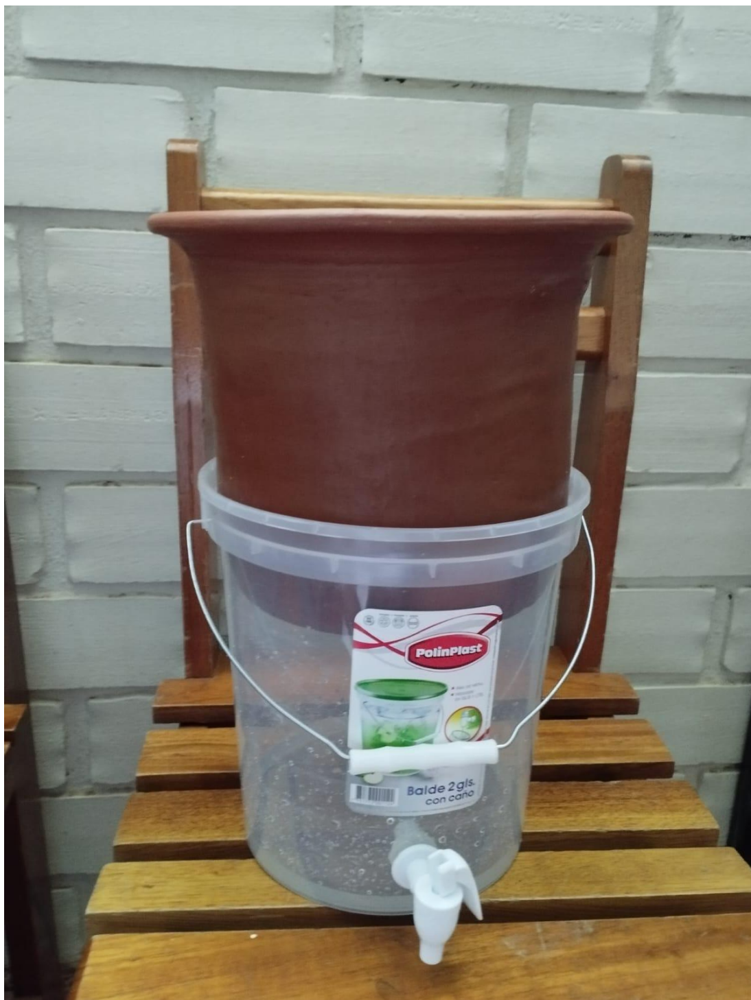
ARMADO COMPLETO DEL ARCI – FILTRO Y EL TANQUE DE ALMACENAMIENTO DE 20LT
