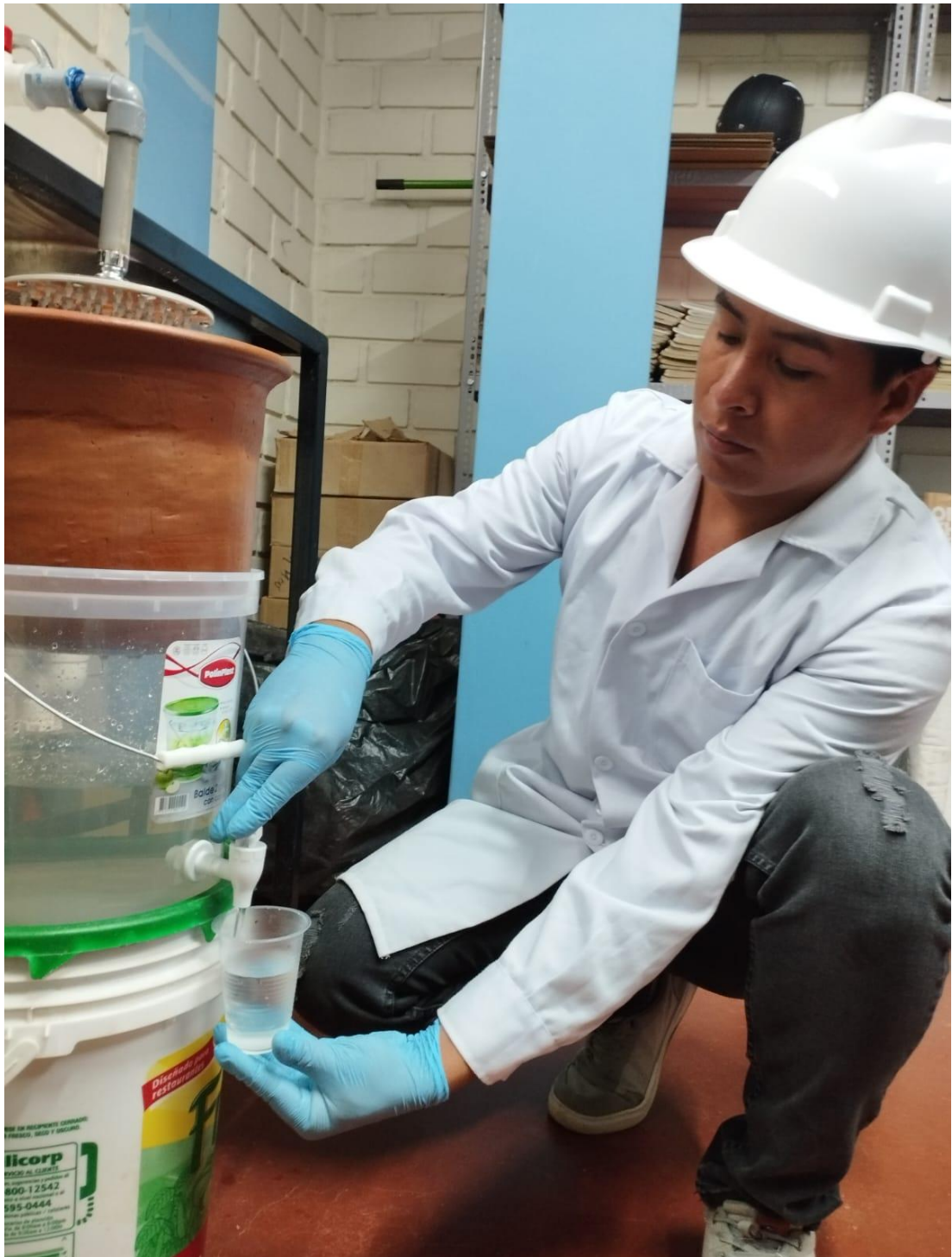
TOMA DE MUESTRA DE AGUA FILTRADA A LOS 30 MINUTOS PARA MEDIR LOS DIFERENTES PARÁMETROS
