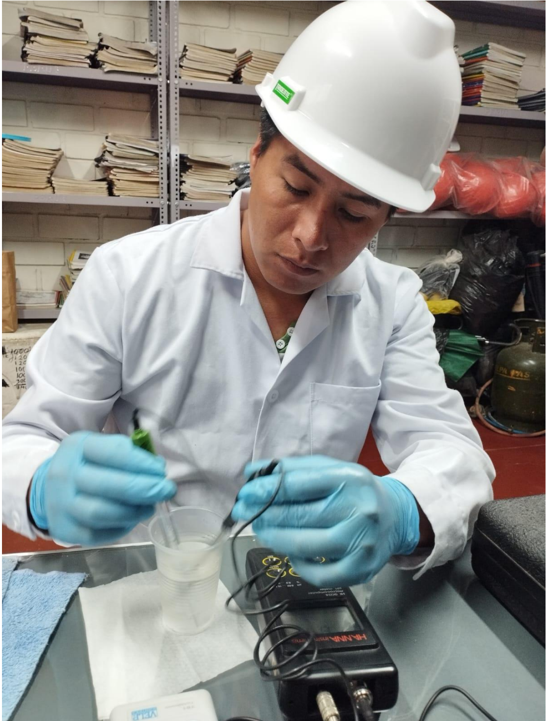
ANALIZANDO LOS PARÁMETROS DE Ph Y TEMPERATURA
