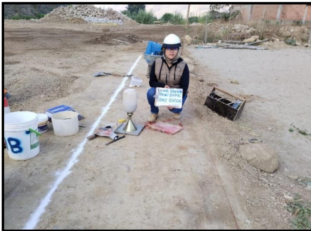
FOTOGRAFÍA N°15: VERIFICACIÓN DEL ENSAYO DE DENSIDAD DE CAMPO EN VEREDAS
