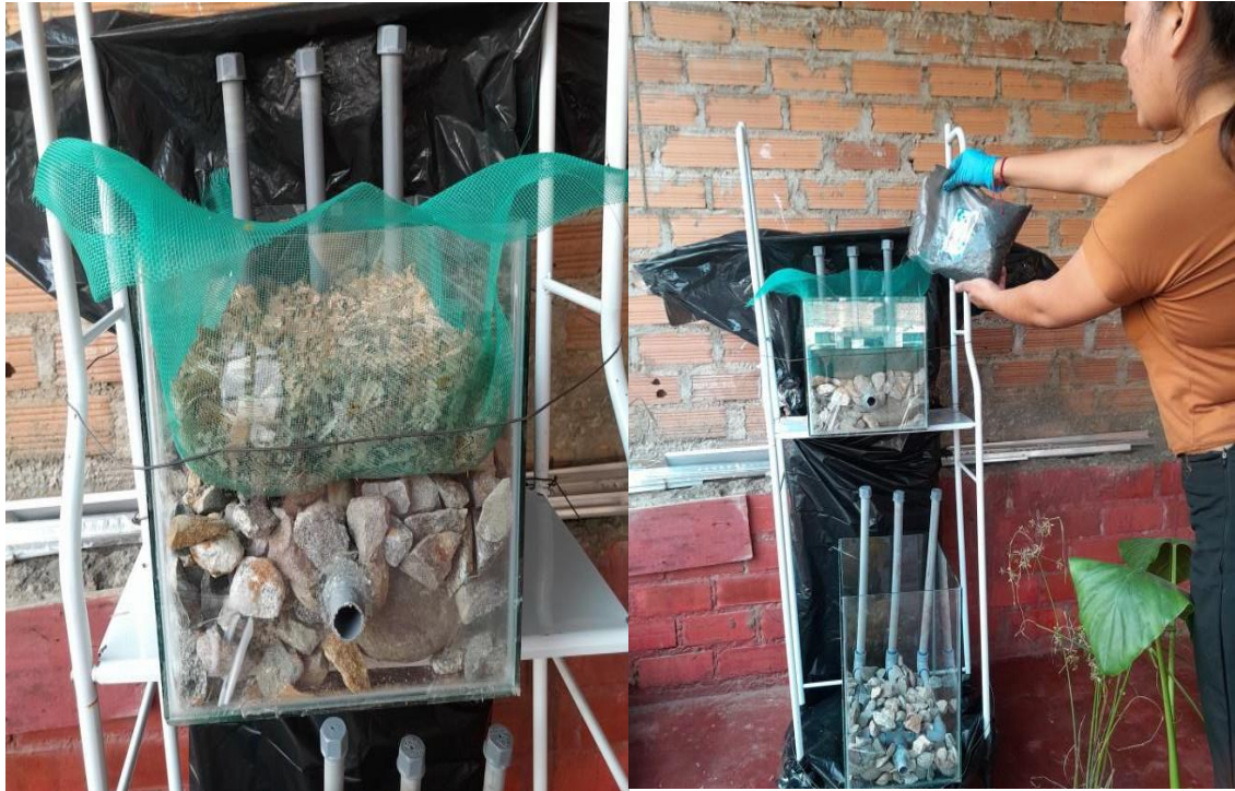
Imagen 11: Se procedió a la colocación de los materiales en el lombrifiltro, considerando las medidas que debe de tener cada estrato
