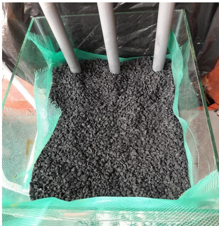
Imagen 13: Cabe mencionar que se puso una malla rachel entre la grava y el carbón activo, esto con la finalidad de impedir que las lombrices pasen a otros estratos.
