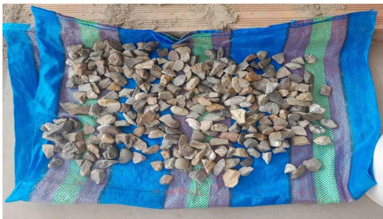
Imagen 10: Las piedras de río y grava fueron previamente lavadas y todos los materiales fueron cuidadosamente manejados, para evitar que algún factor externo altere nuestro sistema y por consecuencia los resultados de su eficacia
