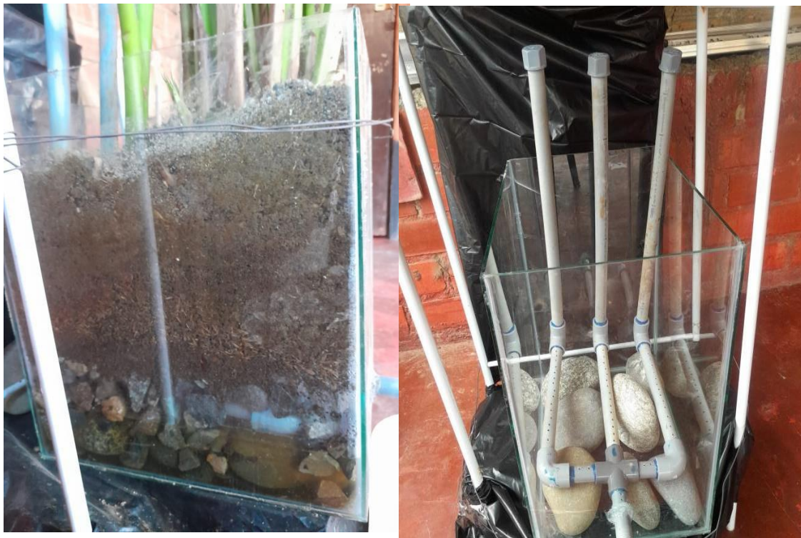
Imagen 12: Se procedió a la colocación de los materiales en el humedal artificial, considerando las medidas que debe de tener cada estrato
