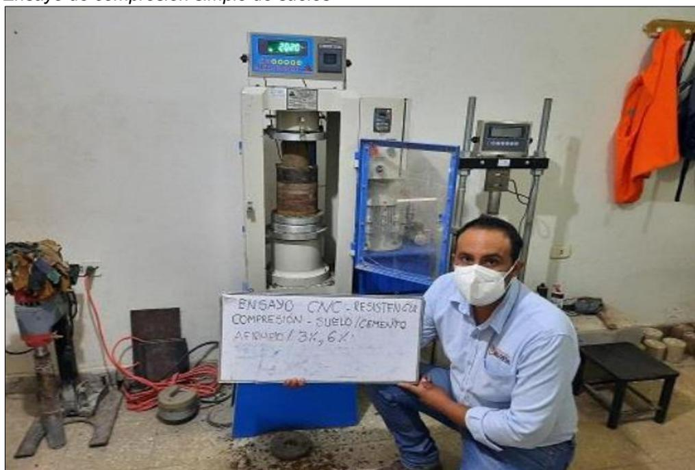
*Nota.* Ensayo de compresión simple para suelos. Fuente: Sacada de la tesis “Influencia del cemento Quisqueya, Inka y Viaforte en la estabilización de suelos para subrasante en los distritos de Huanchaco y Trujillo” (Cruzado Sagástegui, 2021).
