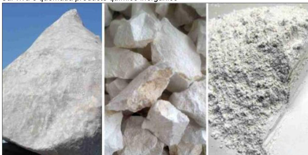
*Nota.* El proceso de calcinación, la piedra caliza se somete a temperaturas elevadas, generalmente por encima de los 900 grados Celsius. Fuente: (Caltek, 2022).
