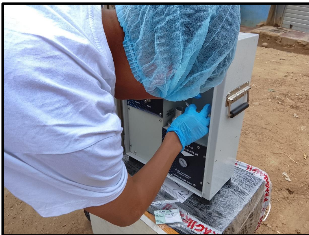
CAMBIO DE FILTRO DE PM10 EN EL MUESTREADOR DE PARTICULAS - ECS - LOWVOL
