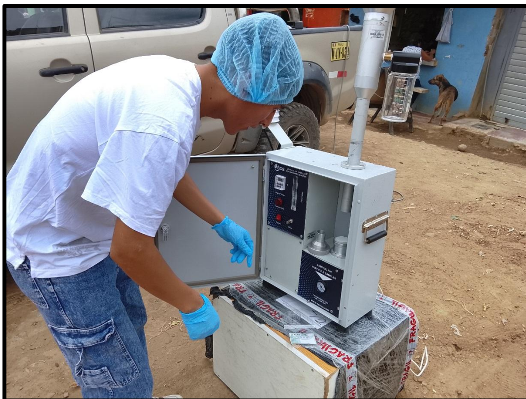
CAMBIO DE FILTRO DE PM10 EN EL MUESTREADOR DE PARTICULAS - ECS - LOWVOL
