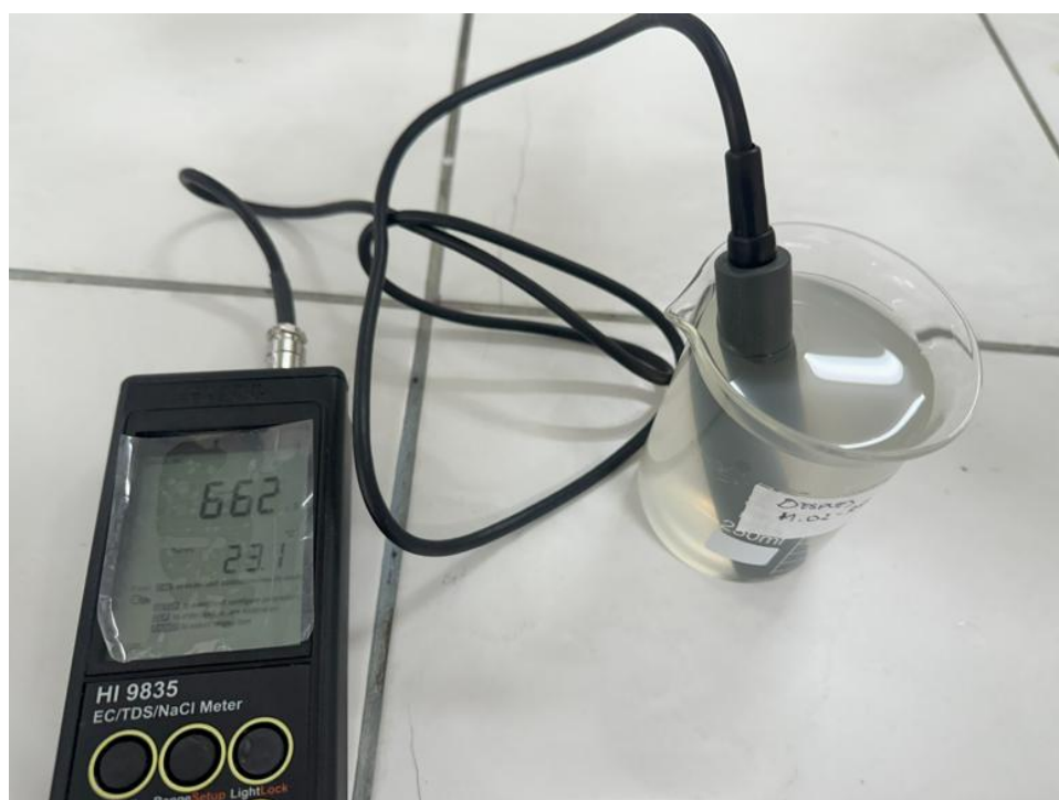
Medición de conductividad eléctrica tras filtración de la muestra tratada con coagulante de lúcuma al 50 %.
