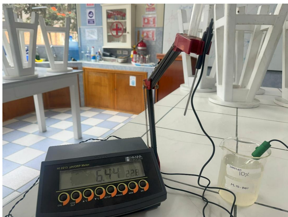
Medición del pH tras filtración de la muestra tratada con coagulante de lúcuma al 10 %.
