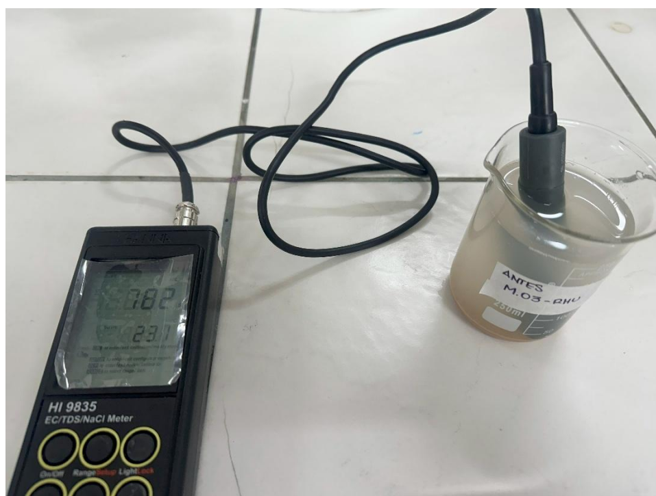
Medición de conductividad eléctrica de la muestra tratada con coagulante de lúcuma al 25 %.
