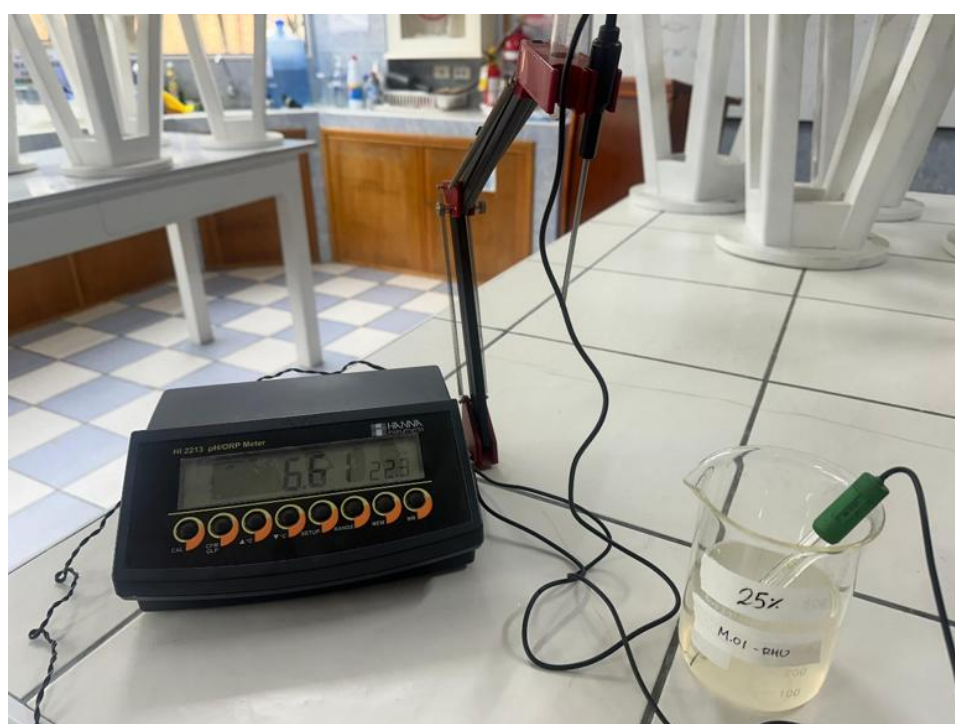
Medición del pH tras filtración de la muestra tratada con coagulante de lúcuma al 25 %.
