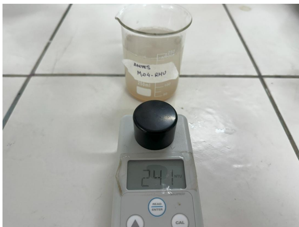
Medición de turbidez de la muestra tratada con coagulante de lúcuma al 25 % (m/V).
