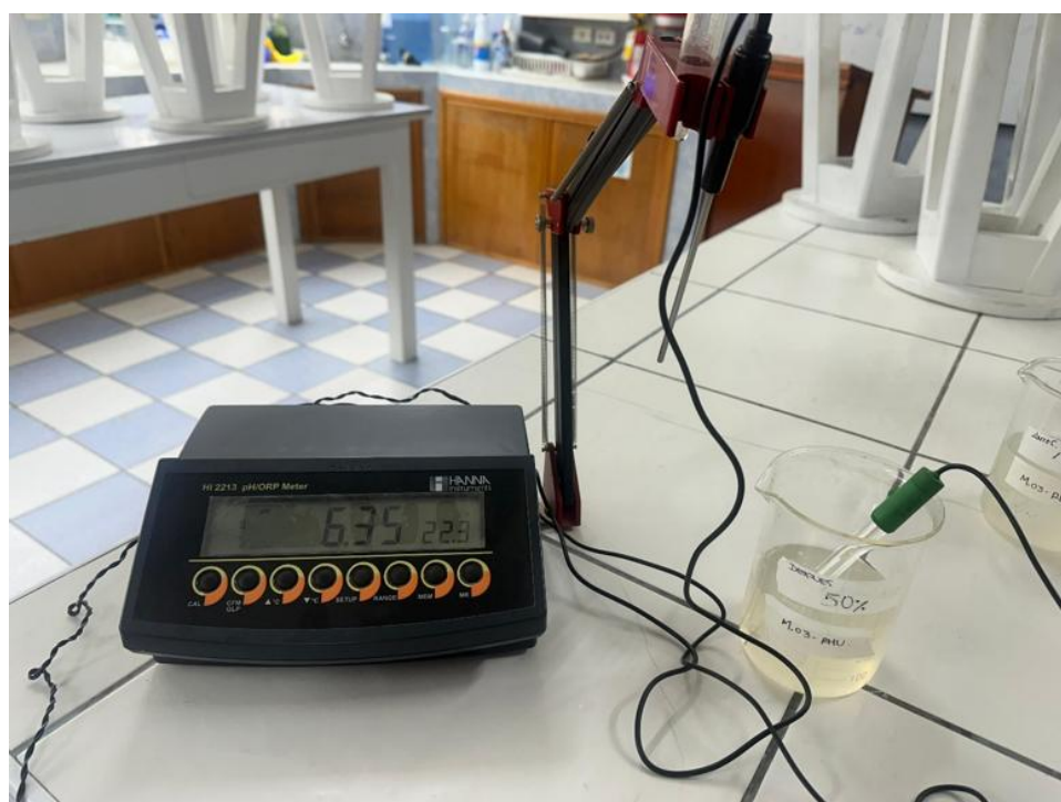
Medición del pH tras filtración de la muestra tratada con coagulante de lúcumá al 50 %.
