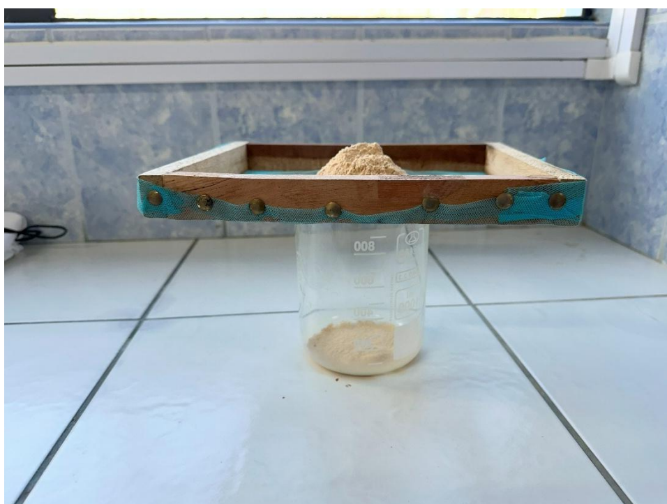
Tamizado del polvo de semillas de lúcuma ( Pouteria lucuma ) para obtención de fracción fina homogénea.
