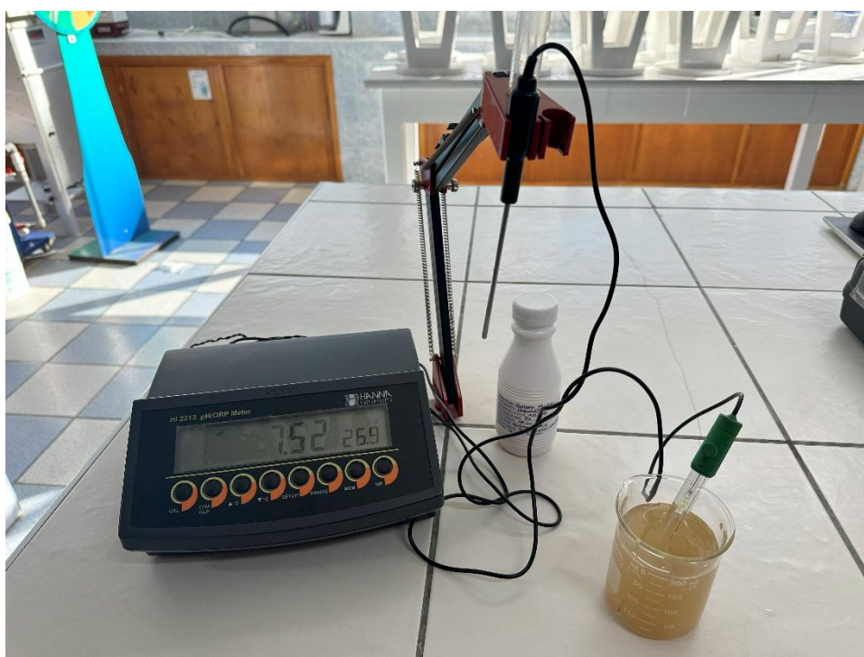
Determinación del pH inicial de la muestra de agua.
