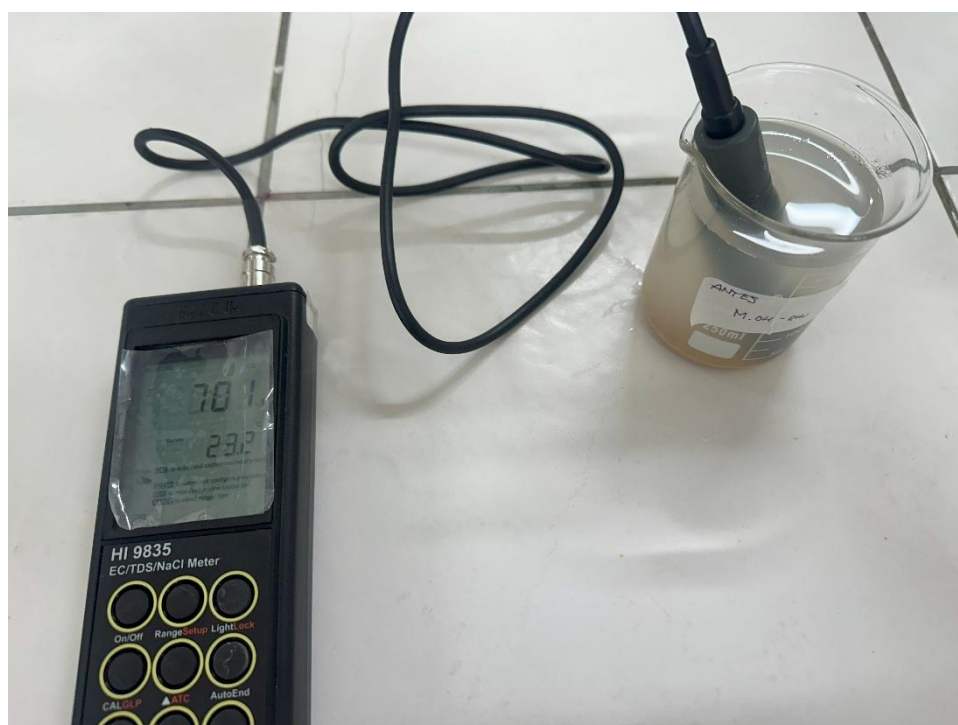
Medición de conductividad eléctrica de la muestra tratada con coagulante de lúcuma al 50 %.
