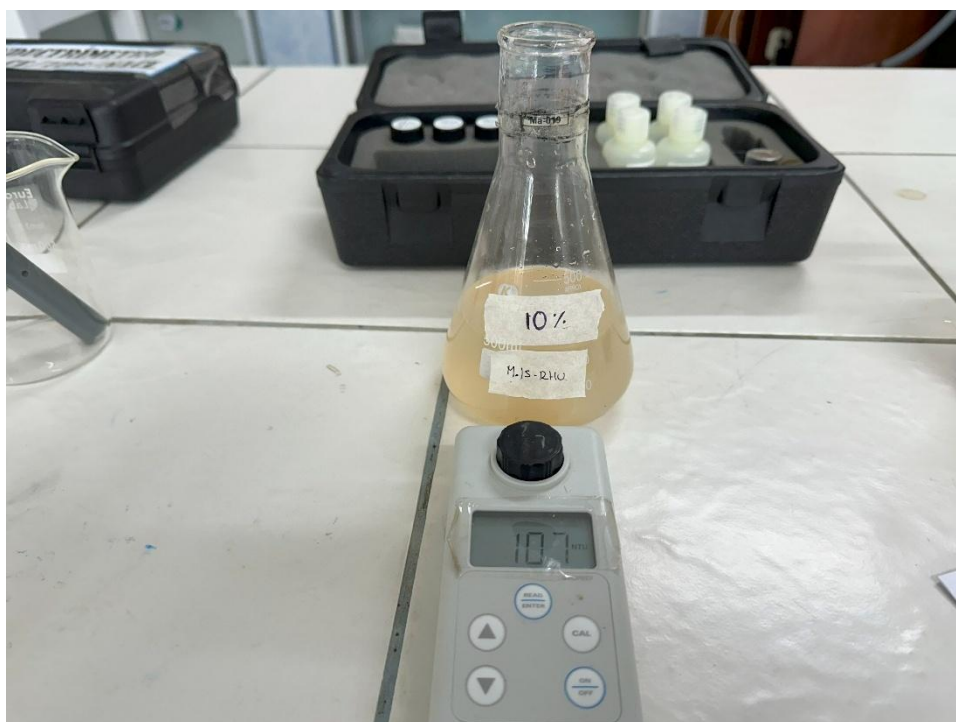
Medición de turbidez tras filtración de la muestra tratada con coagulante de lúcum a 10 %.
