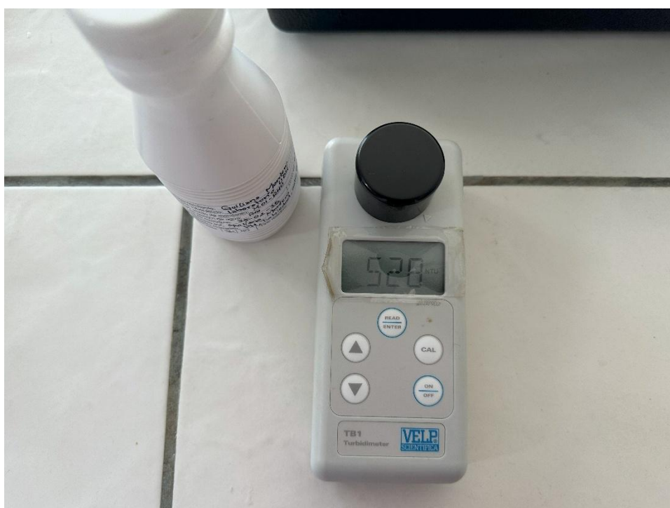
Fotografía 10: Medición de turbidez inicial de la muestra de agua.
