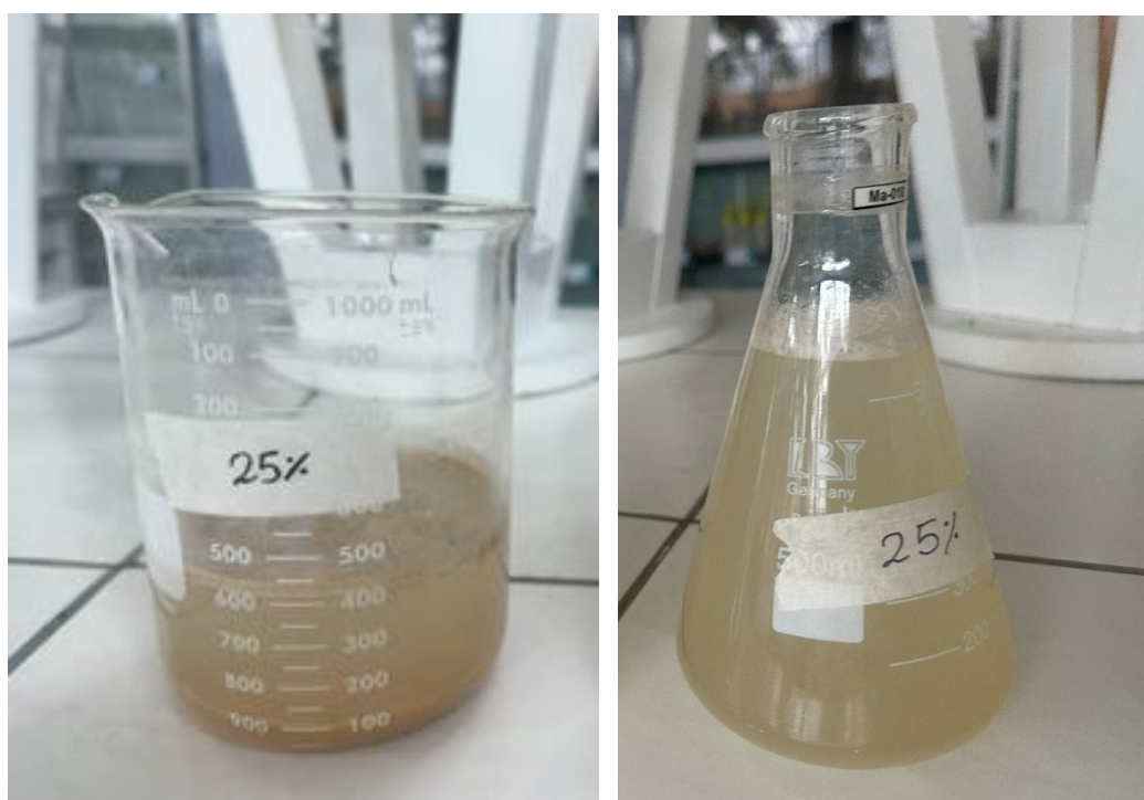
Comparación de la muestra de agua tratada con coagulante de lúcura al 25 % (m/V) antes y después de la filtración.
