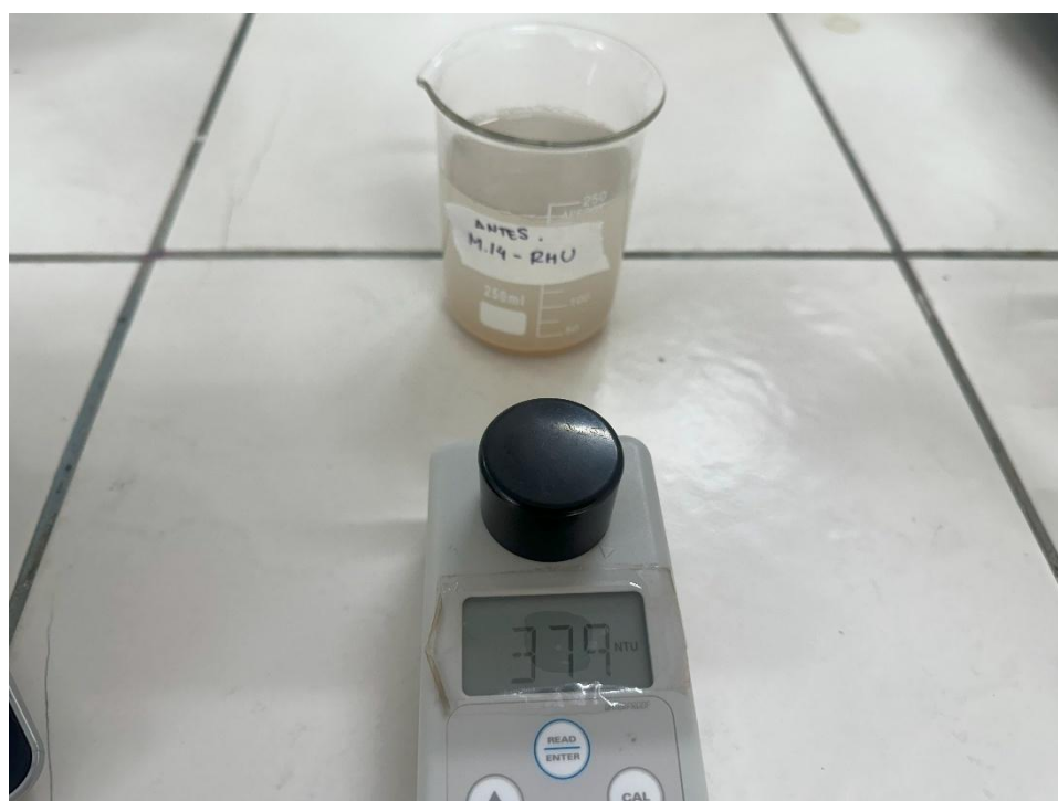
Medición de turbidez de la muestra tratada con coagulante de lúcuma al 50 % (m/V).
