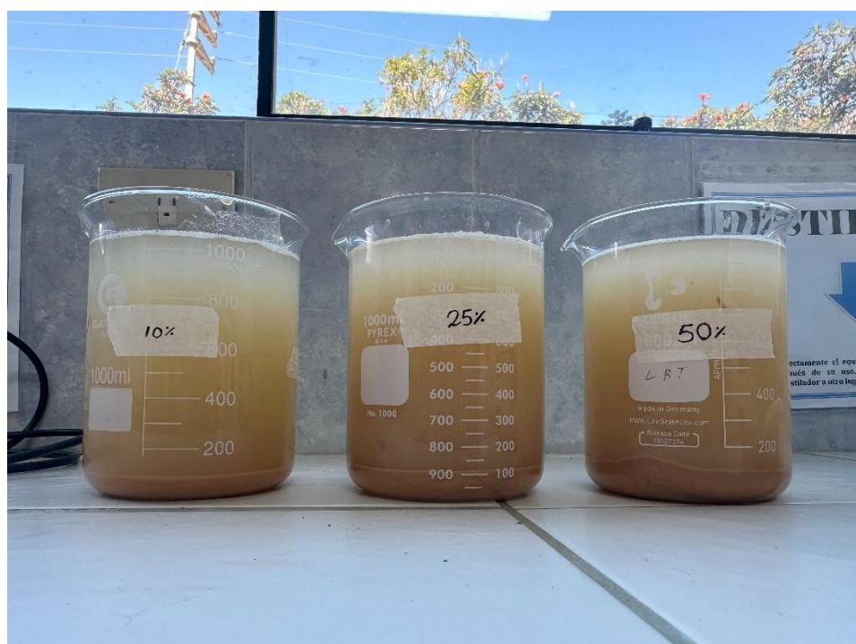
Aplicación del coagulante de lúcumo ( Pouteria lucuma ) a concentraciones del 10 %, 25 % y 50 % (m/V) en muestras de agua.
