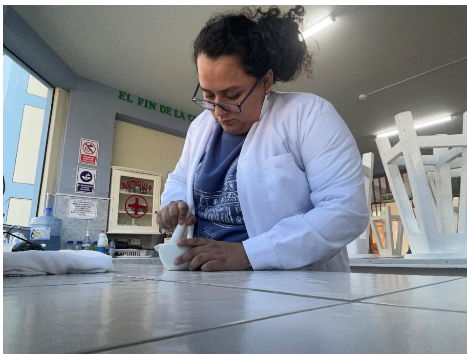
Triturado de láminas de semillas de lúcuma ( Pouteria lucuma ) en mortero con pistilo para obtención de polvo fino.
