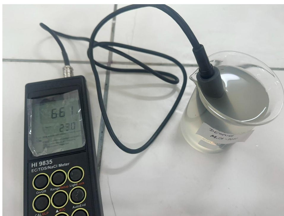
Medición de conductividad eléctrica tras filtración de la muestra tratada con coagulante de lúcuma al 25 %.
