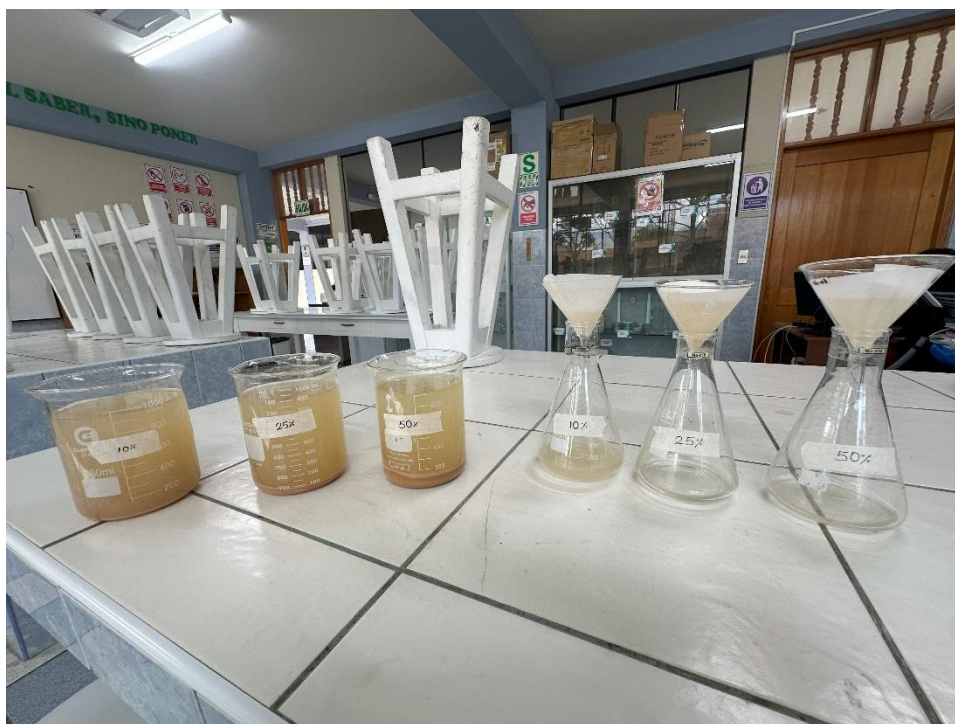
Muestras tratadas con coagulante de lúcumá ( Pouteria lucuma ) a concentraciones del 10 %, 25 % y 50 % (m/V) y sus filtrados correspondientes.
