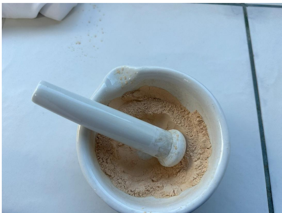
Polvo fino de semillas de lúcuma ( Pouteria lucuma ) obtenido tras trituración en mortero
