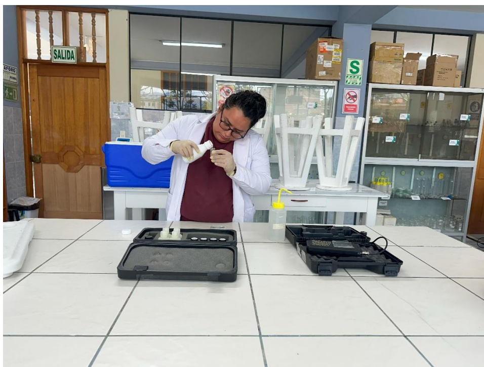
Llenado de la celda del turbidímetro con muestra de agua.
