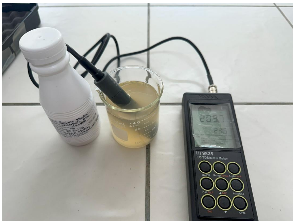
Medición de la conductividad eléctrica inicial de la muestra de agua.
