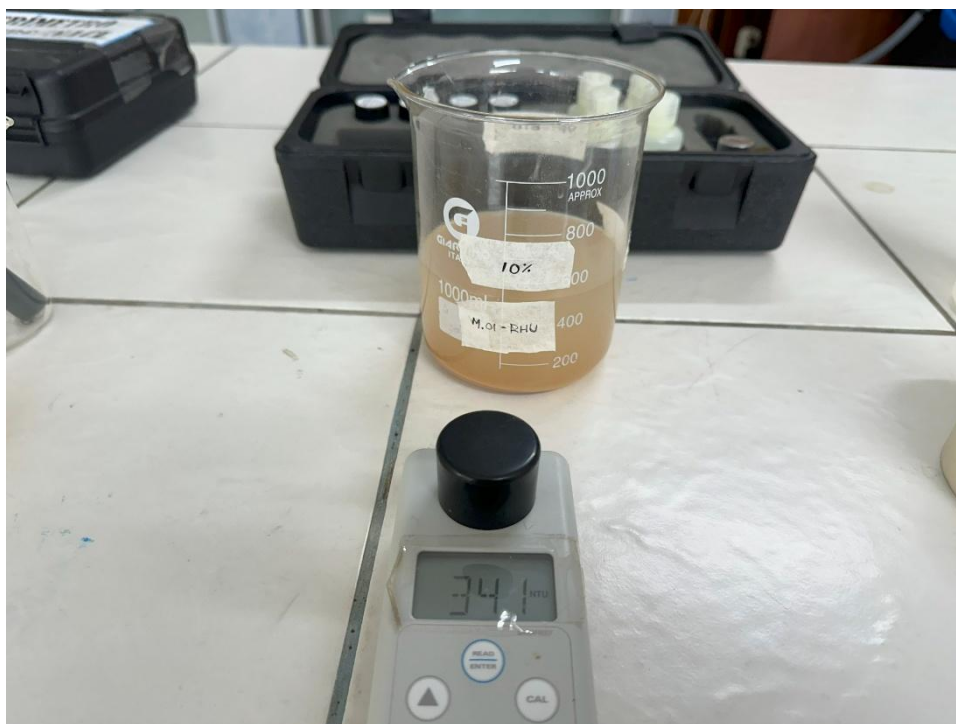
Medición de turbidez de la muestra tratada con coagulante de lúcum a 10 % (m/V).
