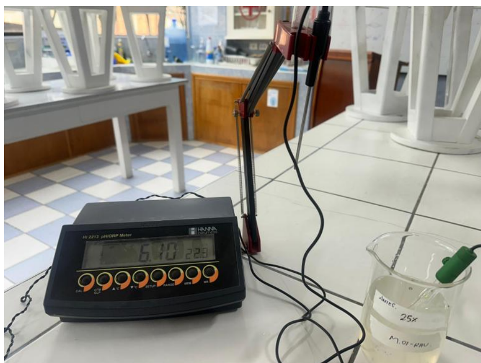
Medición del pH de la muestra tratada con coagulante de lúcuma.
