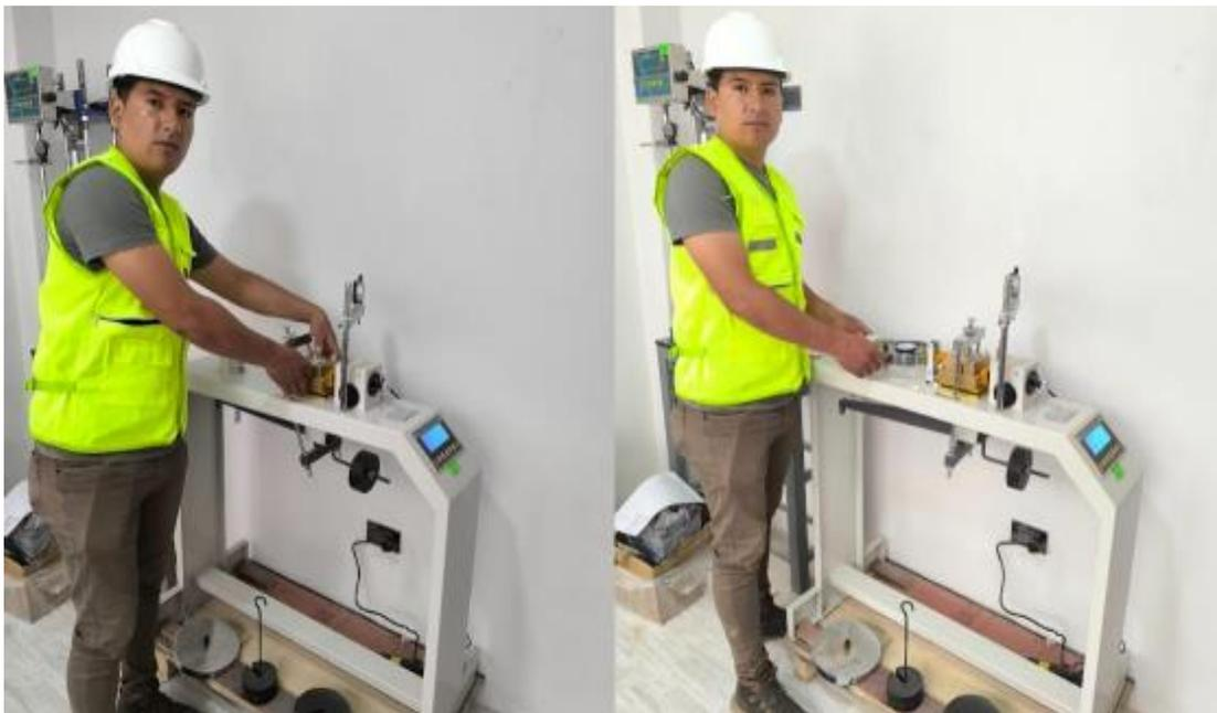
*Nota.* Se realiza el ensayo de la misma densidad, se ensambla la caja de corte, se obtiene la sección de la muestra y se coloca la muestra de suelo en la caja junto al dial de carga y la piedra porosa como indica la NTP 339.171.
