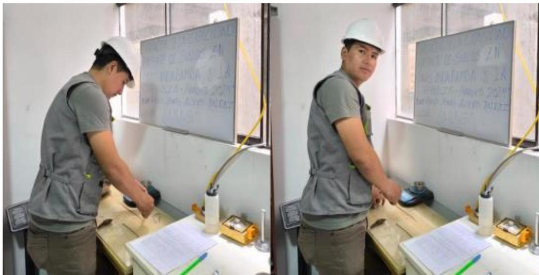
*Nota.* Se pesará 3 muestras de 6 gr de las muestras elipsoides del suelo después se llevará al horno de  $110^{\circ}\text{C} \pm 5^{\circ}\text{C}$  por un periodo de 16 horas para determinar su humedad promedio como lo estipula la NTP 339.129.
