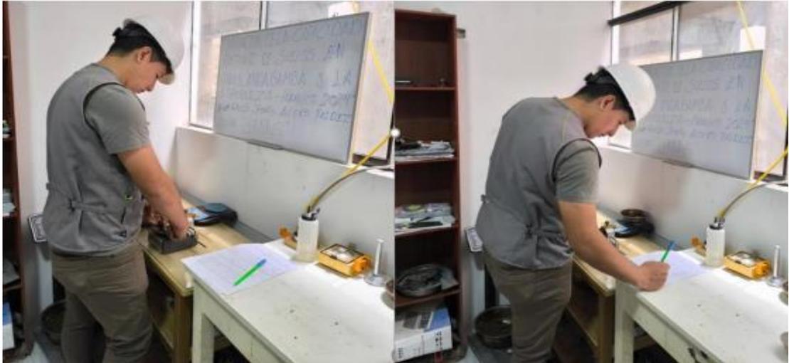
*Nota.* Pesaje de la muestra de suelo al cerrarse tendrá que tener una medida de 13 mm donde después se retirará una muestra representativa de la parte del fondo de la copa y se hará el ensayo de contenido de humedad con la ayuda de la NTP 339.127 como lo estipula la NTP 339.129.
