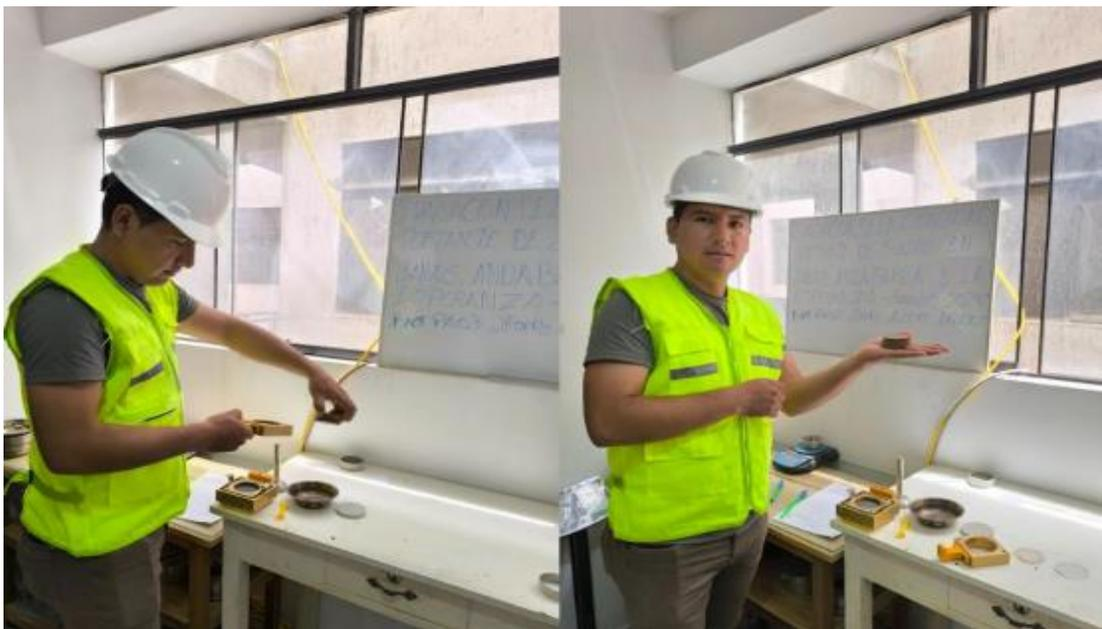
*Nota.* Se muestra la tasa de deformación unitaria que debe ser del orden de 0,5 a no más de 2 mm/min, y deberá ser tal que la muestra falle entre 3 y 5 minutos, se repite el procedimiento por lo menos en dos muestras utilizando un valor distinto de carga vertical (se sugiere doblar la carga) como indica la norma NTP 339.171.
