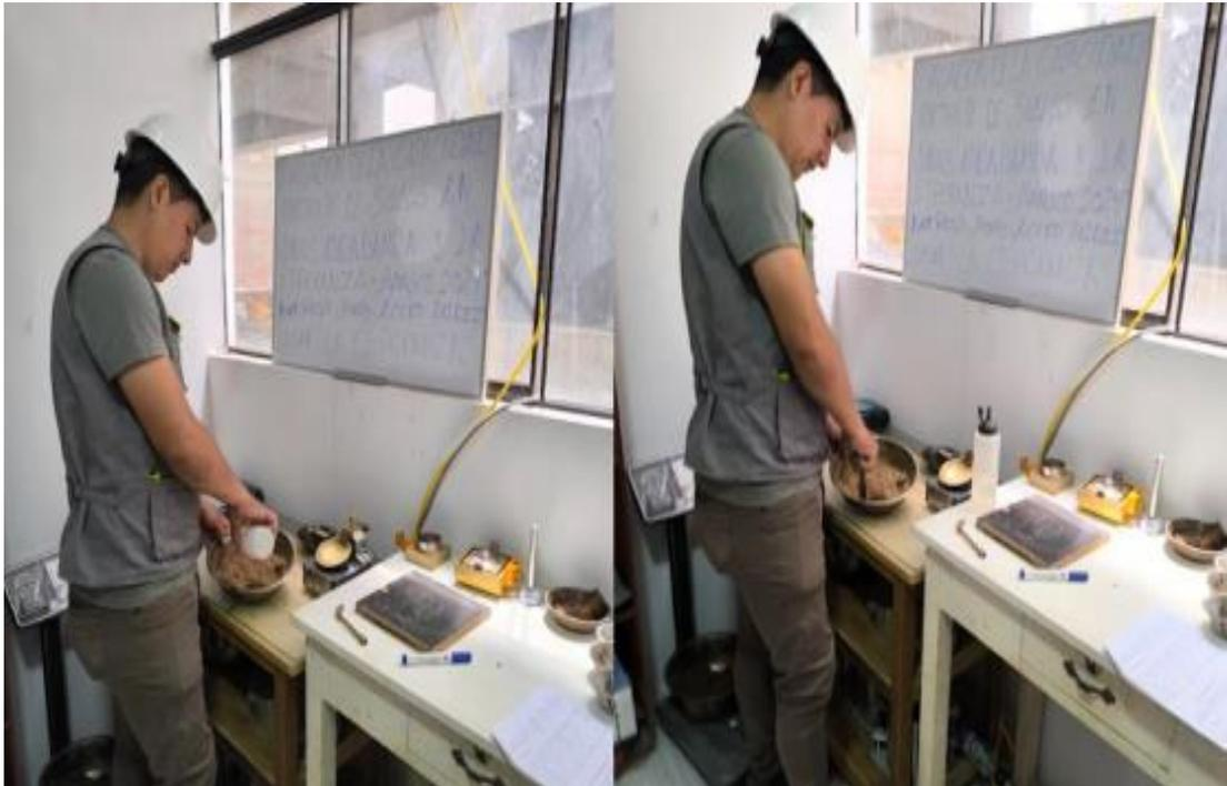
*Nota.* Se prepara una pasta maleable con agua destilada y con la muestra pesada del suelo pasante del tamiz N° 40 como lo estipula la NTP 339.129.
