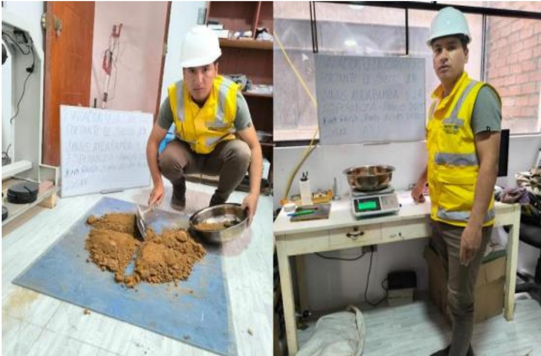
Nota: Se selecciona el material uniforme y conglomerado de suelo y luego se procede con el pesaje de la muestra natural para ser trasladado al horno.
