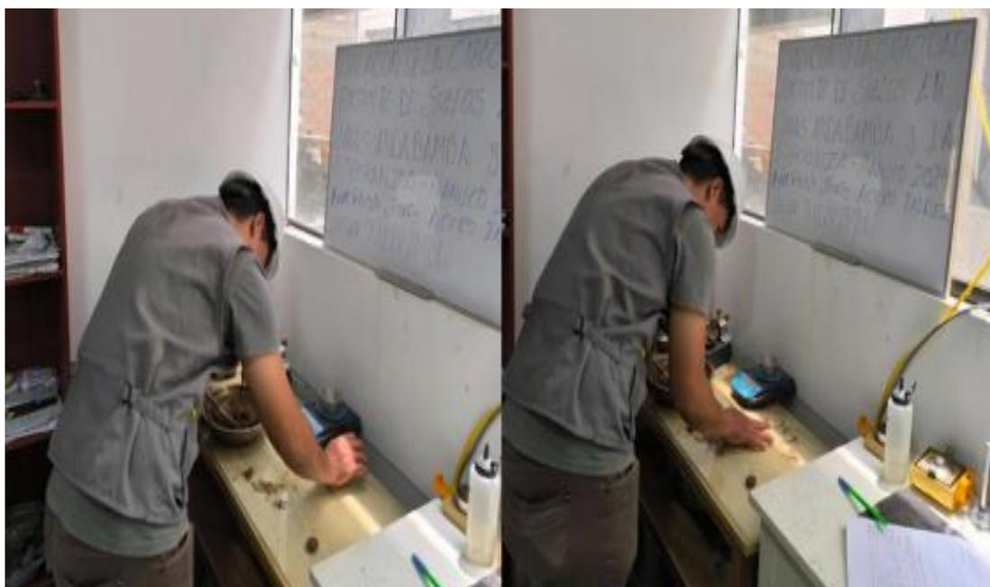
*Nota.* Se enrollará la masa entre la palma o los dedos y la placa de vidrio con la presión necesaria para enrollar la masa en un hilo de diámetro uniforme en toda su longitud, la muestra elipsoide debe ser formada hasta que tenga un diámetro de 3,2 mm como lo estipula la NTP 339.129.
