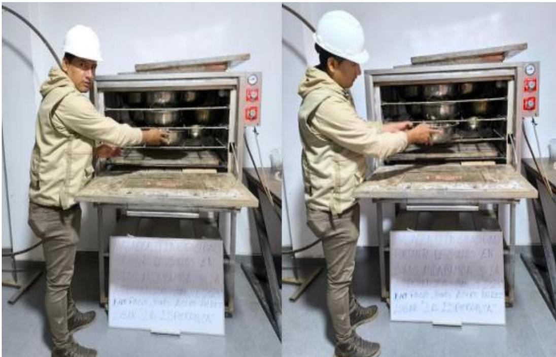
*Nota.* Se coloca al horno de  $110^{\circ}\text{C} \pm 5^{\circ}\text{C}$ , la muestra de suelo durante un tiempo determinado de 24 horas como indica la norma NTP 399.128.
