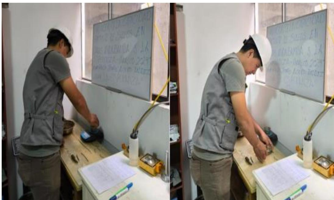
*Nota.* Se pesará 3 muestras de 6 gr de las muestras elipsoides del suelo después se llevará al horno de  $110^{\circ}\text{C} \pm 5^{\circ}\text{C}$  por un periodo de 16 horas para determinar su humedad promedio como lo estipula la NTP 339.129.
