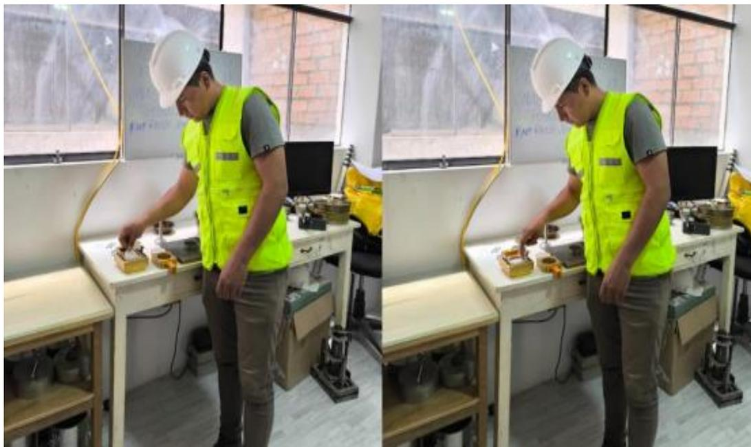
*Nota.* Se realiza el armado del aparato de cizalladura directo con un disco de calibración de espesor aproximadamente igual al del espécimen de ensayo deseado y alrededor de 5 mm más pequeño en diámetro o anchura como indica la norma NTP 339.171.
