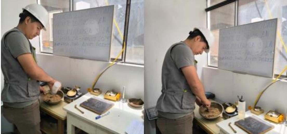
*Nota.* Se prepara una pasta maleable con agua destilada y con la muestra pesada del suelo pasante del tamiz N° 40 como lo estipula la NTP 339.129.
