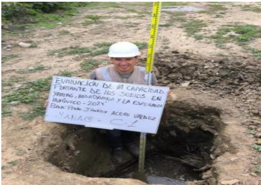
*Nota.* Excavación y extracción de la muestra del suelo de la localidad de Yanag C-1 a 2.15 m
