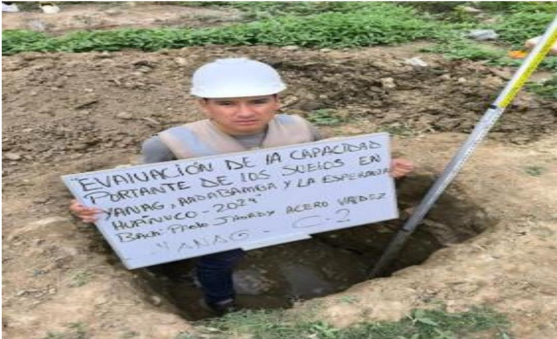
*Nota. Excavación y extracción de la muestra del suelo de la localidad de Yanag C-2 a 2.10 m.*
