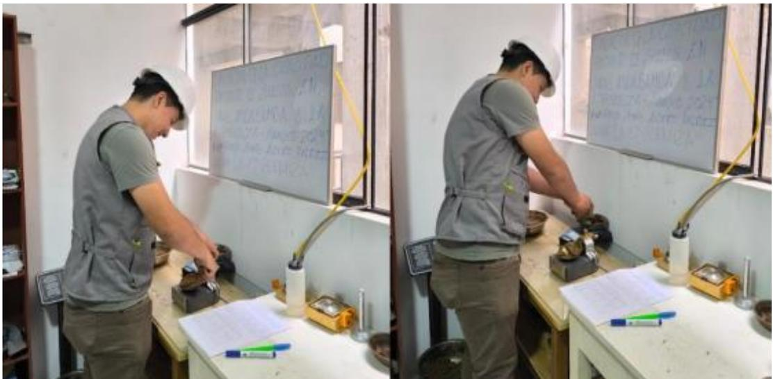
Nota. Pesaje de la muestra de suelo al cerrarse tendrá que tener una medida de 13 mm donde después se retirará una muestra representativa de la parte del fondo de la copa y se ara el ensayo de contenido de humedad con la ayuda de la NTP 339.127 como lo estipula la NTP 339.129.
