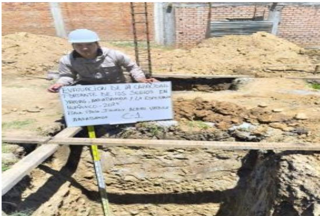
*Nota.* Excavación y extracción de la muestra del suelo de la localidad de Andabamba C-1 a 3.00 m.
