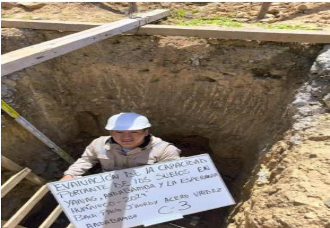
*Nota.* Excavación y extracción de la muestra del suelo de la localidad de Andabamba C-3 a 3.00 m.
