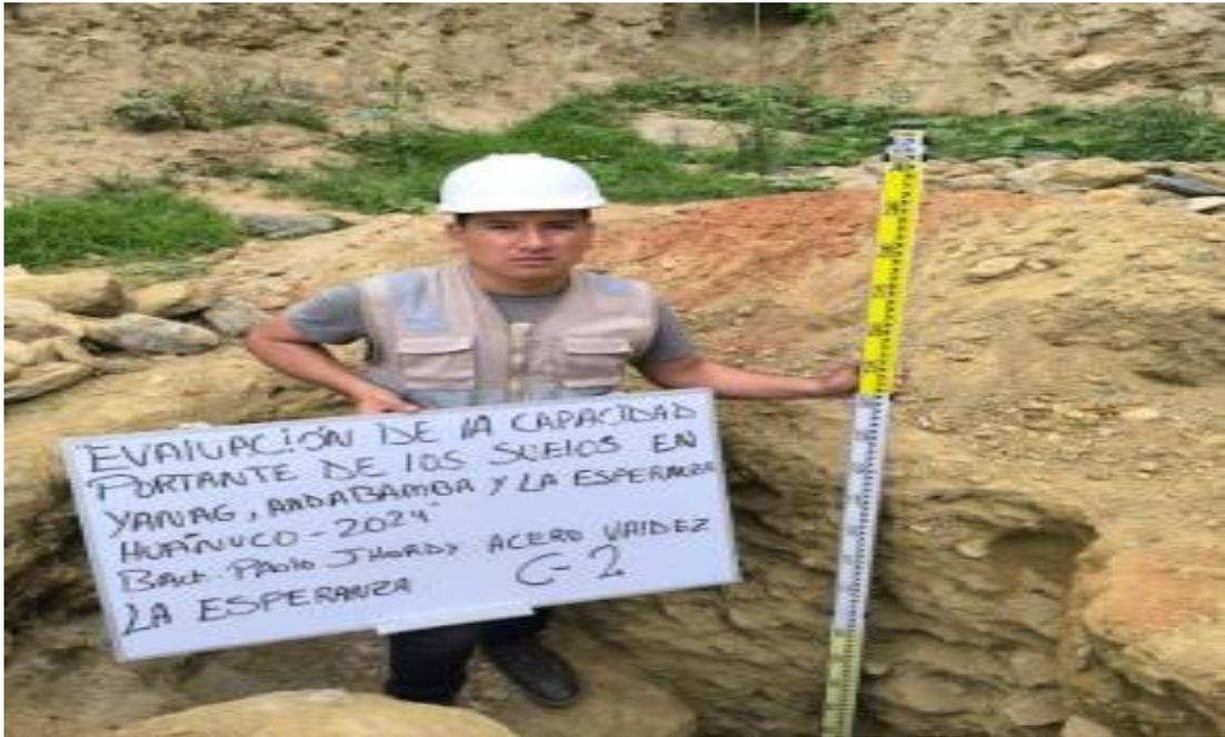
*Nota. Excavación y extracción de la muestra del suelo de la localidad La Esperanza C-2 a 3.00 m*
