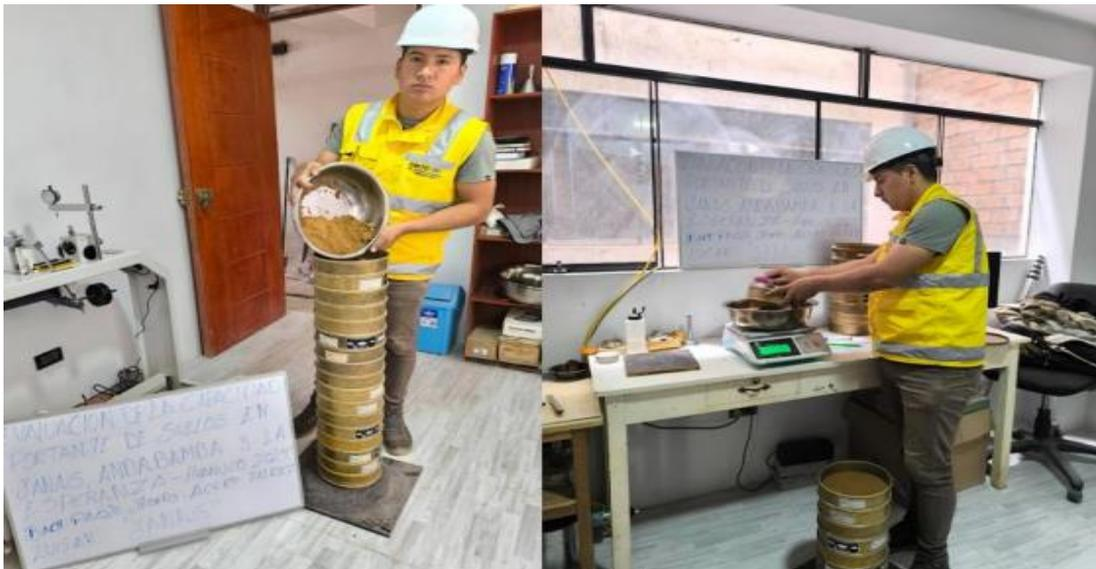
*Nota.* Se hecha la muestra de suelo con un peso de 3 kg para el ensayo granulométrico ordenándose los tamices desde el Tamiz 3" hasta el tamiz N° 200 y se agitará los tamices en un periodo de 10 minutos y luego se procede con el pesaje de cada muestra retenidas del tamiz para determinar la curva granulométrica de la muestra de suelo como lo estipula la NTP 339.128.
