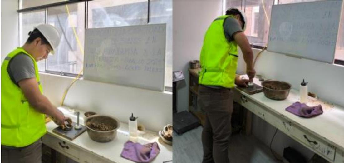
*Nota.* Se realiza el llenado de la muestra en la caja de cizalladura, la compactación debe hacerse con las condiciones de humedad y peso unitario deseado, se puede efectuar directamente en el dispositivo de corte, en un molde de dimensiones iguales al dispositivo de corte o en un molde mayor para recortarlas como indica la norma NTP 339.171.
