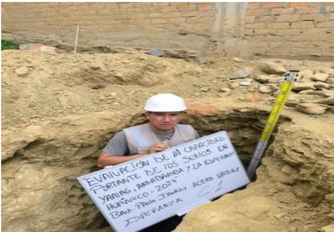
*Nota.* Excavación y extracción de la muestra del suelo de la localidad La Esperanza C-1 a 3.00 m.
