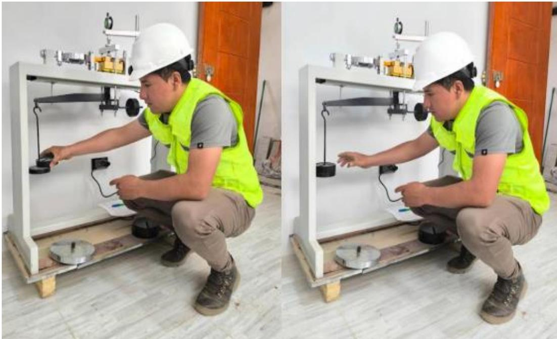
*Nota.* Se aplica la carga horizontal midiendo desde los deformímetros de carga, de cambio de volumen y desplazamiento de cortante como indica la norma NTP 339.171.
