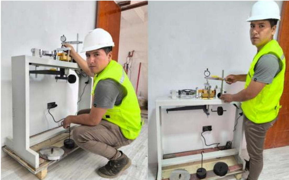
*Nota.* Se aplica la carga vertical y se coloca el dial para determinar el desplazamiento vertical como indica la norma NTP 339.171.
