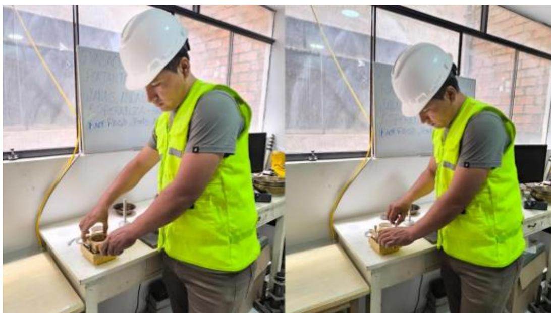
*Nota.* Se coloca y se ajusta adecuadamente el instrumento de medición de desplazamiento horizontal utilizado para medir los desplazamientos de cizalladura como indica la norma NTP 339.171.
