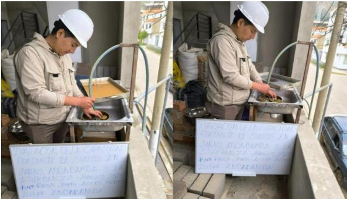
Nota. Se realiza el lavado de la muestra de suelo con la malla N° 200 como estipula la norma NTP 339.128.
