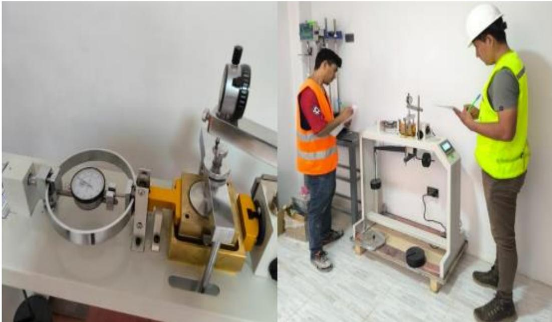
*Nota.* Se realiza el apunte de tipo de deformación controlada del desplazamiento horizontal de 5, 10 cada 10 o 20 unidades como indica la norma NTP 339.171.
