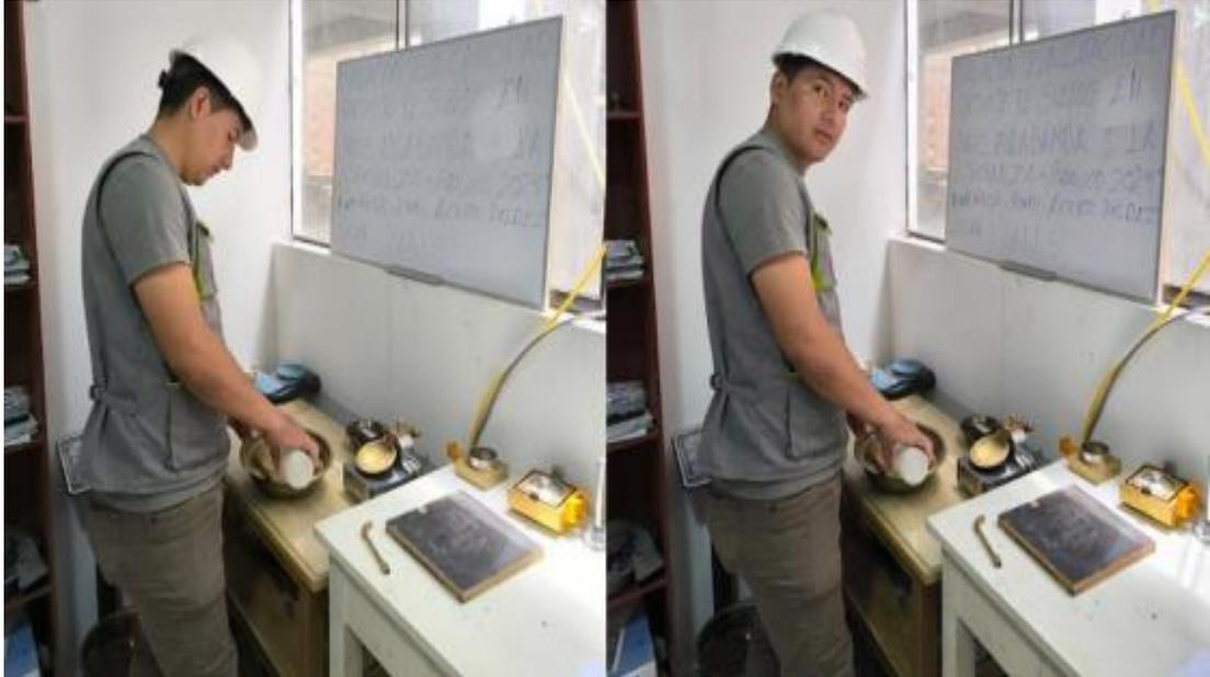
*Nota.* Se prepara una pasta maleable con agua destilada y con la muestra pesada del suelo pasante del tamiz N° 40 como lo estipula la NTP 339.129.
