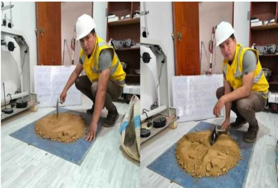
*Nota.* Se aplana la pila cónica hasta darle una base circular de tal manera cada cuarto tenga el material original los materiales de uso según la NTP 3339.128.
