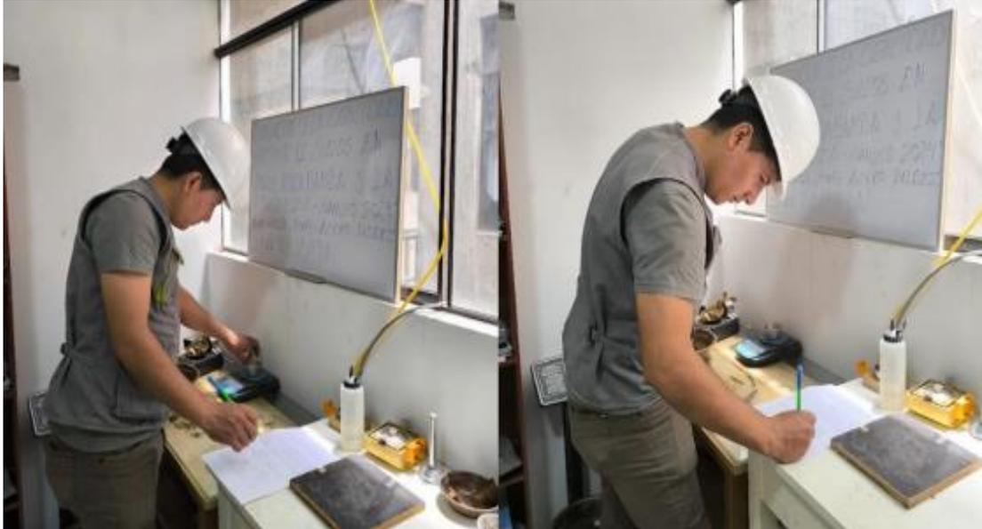
*Nota.* Se pesará 3 muestras de 6 gr de las muestras elipsoides del suelo después se llevará al horno de  $110^{\circ}\text{C} \pm 5^{\circ}\text{C}$  por un periodo de 16 horas para determinar su humedad promedio como lo estipula la NTP 339.129.
