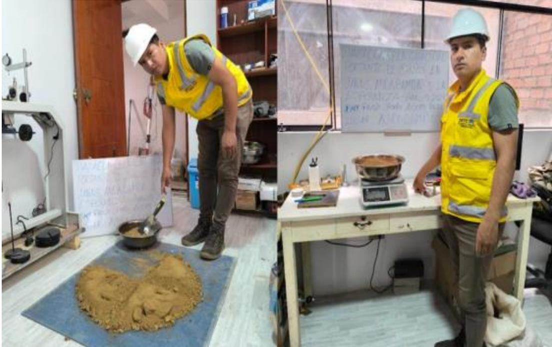
*Nota.* Se selecciona el material uniforme y conglomerado de suelo y luego se procede con el pesaje de la muestra natural para ser trasladado al horno.
