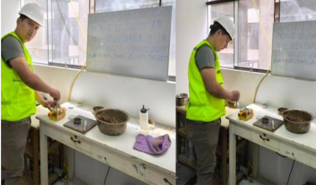
*Nota.* Se muestra el espesor mínimo de la muestra de ensayo, debe ser alrededor de 12 mm (1/2") pero no menor de un sexto al tamaño máximo de las partículas del suelo como indica la norma NTP 339.171.
