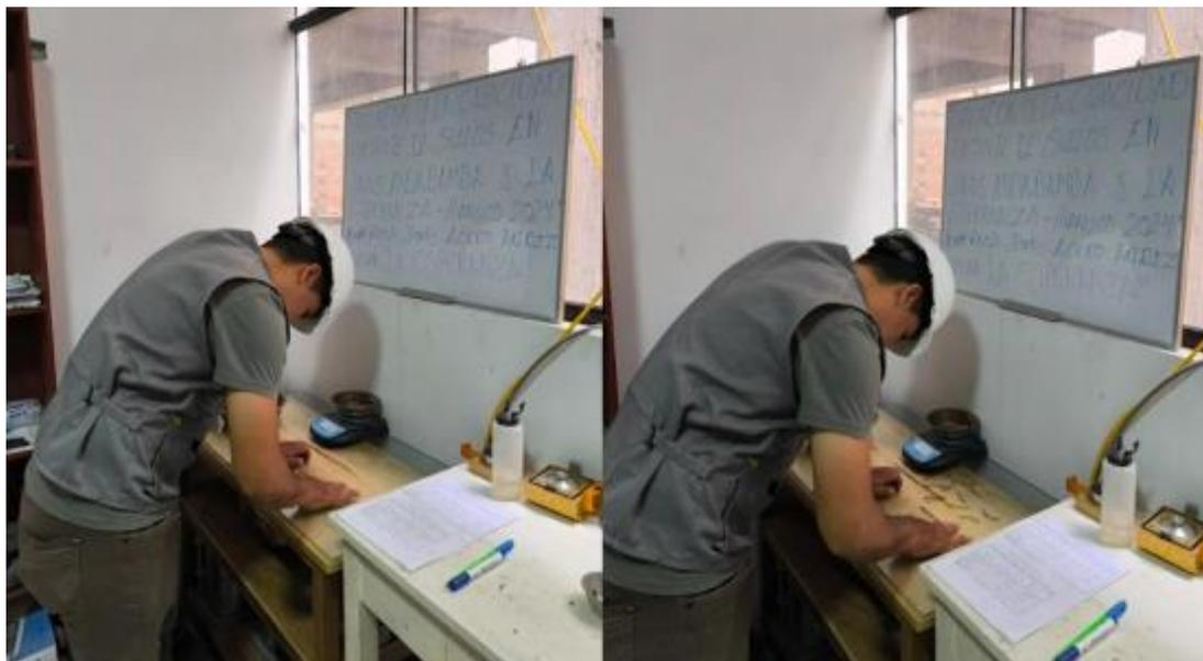
*Nota.* Se enrollará la masa entre la palma o los dedos y la placa de vidrio con la presión necesaria para enrollar la masa en un hilo de diámetro uniforme en toda su longitud, El hilo debe ser deformado en cada movimiento hasta que su diámetro sea de 3,2 mm como lo estipula la NTP 339.129.
