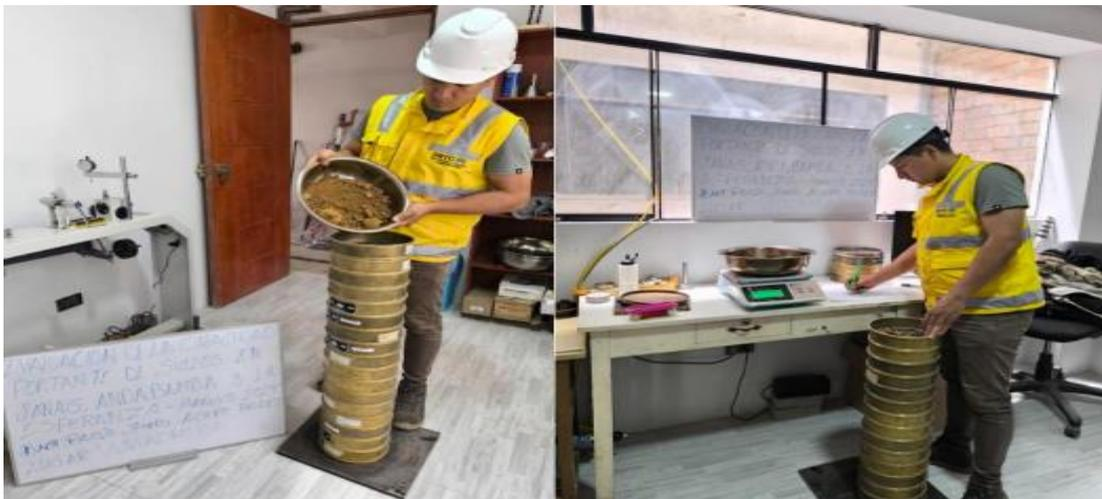
*Nota.* Se hecha la muestra de suelo con un peso de 3 kg para el ensayo granulométrico ordenándose los tamices desde el Tamiz 3" hasta el tamiz N° 200 y se agitará los tamices en un periodo de 10 minutos y luego se procede con el pesaje de cada muestra retenidas del tamiz para determinar la curva granulométrica de la muestra de suelo como lo estipula la NTP 339.128.
