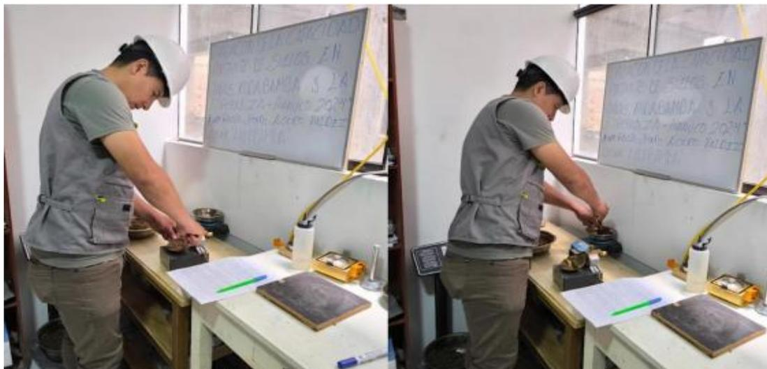
*Nota.* Pesaje de la muestra de suelo al cerrarse tendrá que tener una medida de 13 mm donde después se retirará una muestra representativa de la parte del fondo de la copa y se realizará el ensayo de contenido de humedad con la ayuda de la NTP 339.127 como lo estipula la NTP 339.129.
