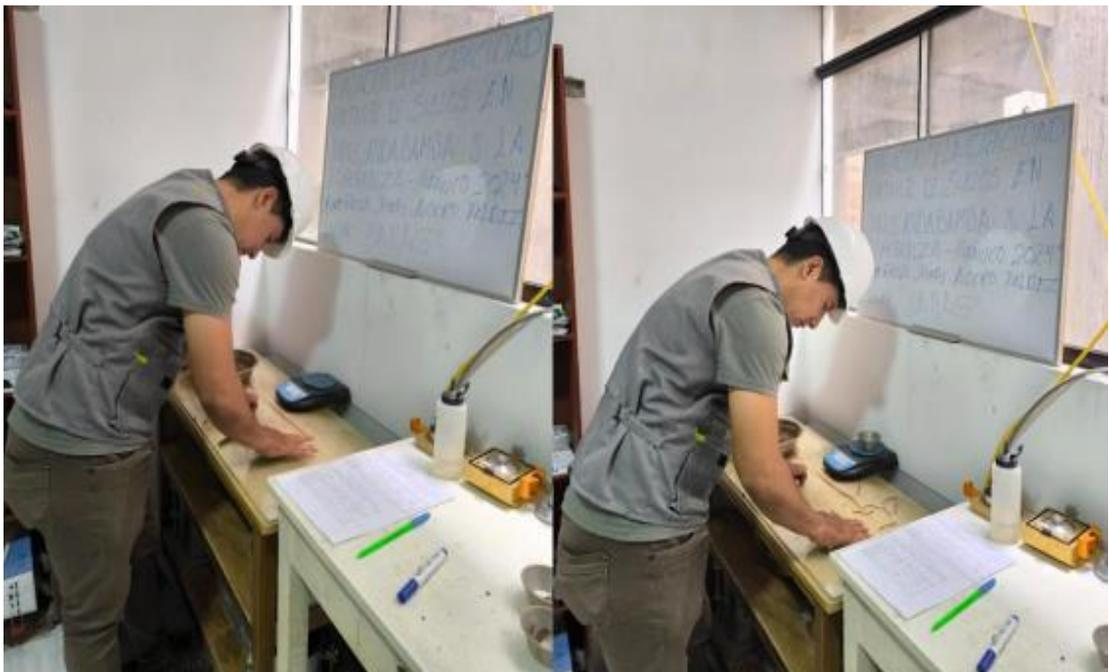
*Nota.* Se enrollará la masa entre la palma o los dedos y la placa de vidrio con la presión necesaria para enrollar la masa en un hilo de diámetro uniforme en toda su longitud, El hilo debe ser deformado en cada movimiento hasta que su diámetro sea de 3,2 mm como lo estipula la NTP 339.129.
