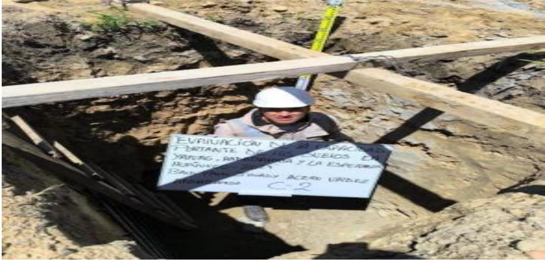
*Nota.* Excavación y extracción de la muestra del suelo de la localidad de Andabamba C-2 a 3.00 m.
