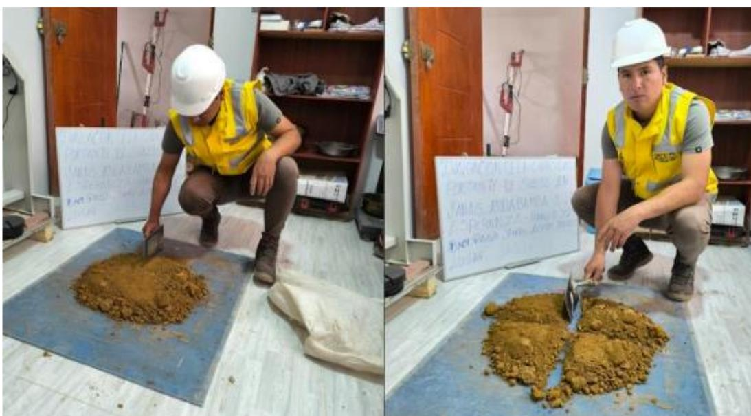
*Nota.* Se aplana la pila cónica hasta darle una base circular de tal manera cada cuarto tenga el material original los materiales de uso según la NTP 3339.128.
