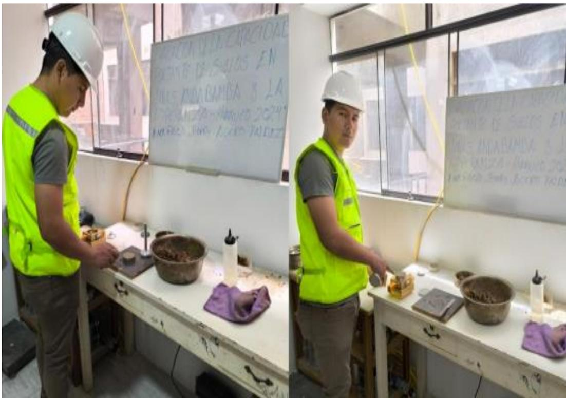
*Nota.* Se muestra el diámetro obtenido de las muestras que deben ser por lo menos 5 mm (Tamiz N° 4) menor que el diámetro del tubo como indica la norma NTP 339.171.
