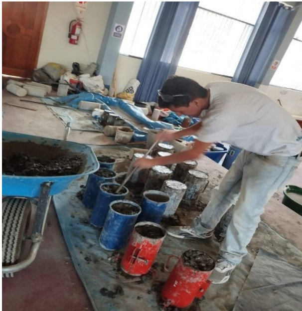
Figura 27 Vaciado de mezcla de concreto en las probetas
