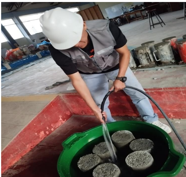
Figura 29 Curado del concreto
