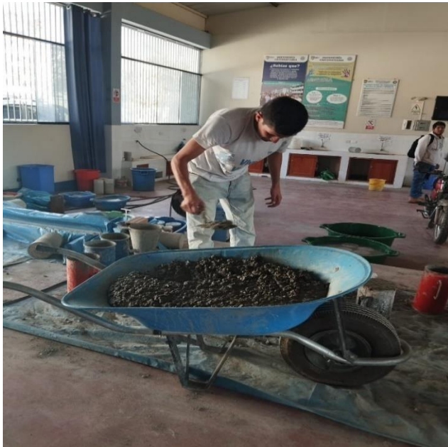
Figura 26 Elaboración de las probetas de concreto
