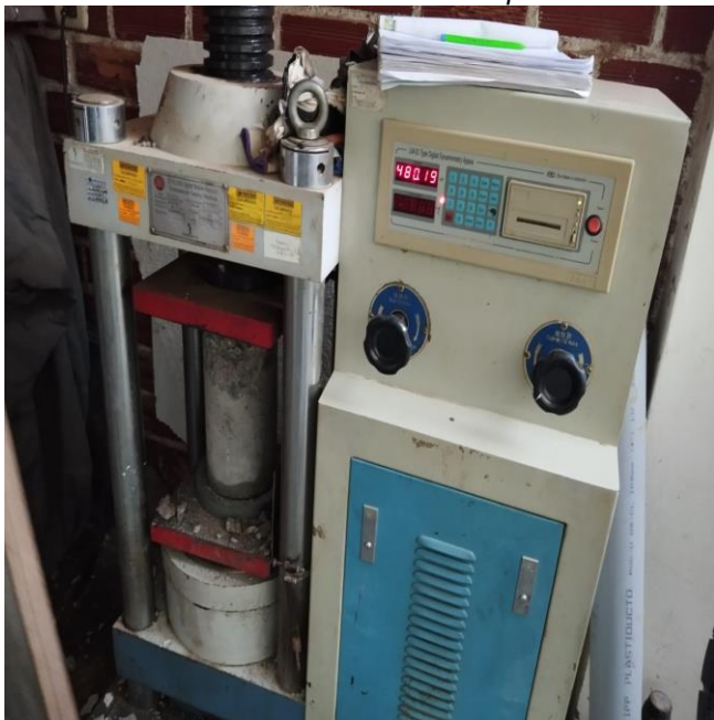
Figura 31 Concreto sometido a esfuerzos con la prensa hidráulica.
