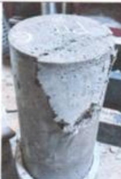
Fig. 4: Tipo de falla de la Muestra 11
