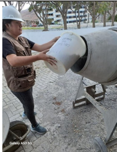
Procedimiento de la mezcla de materiales de acuerdo al diseño de mezcla con ayuda de una mezcladora de concreto para obtener el concreto fresco en las instalaciones del laboratorio de la Universidad de Huánuco.
