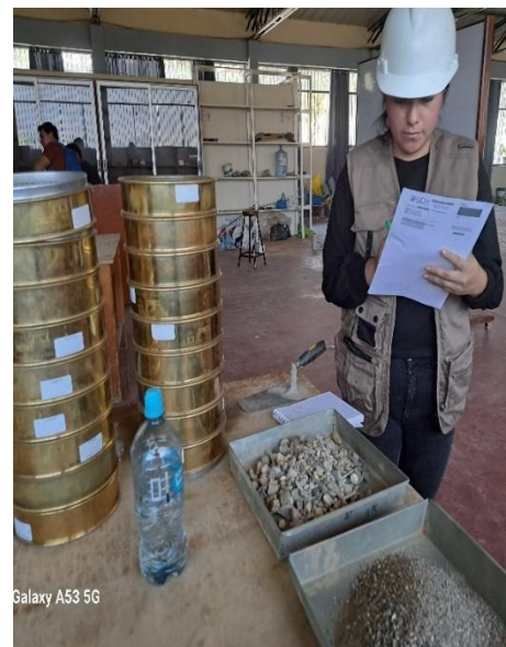
Ejecución de pruebas de laboratorio para conocer las características físicas y mecánicas de los agregados para la elaboración de un concreto de 210 kg/cm 2 .
