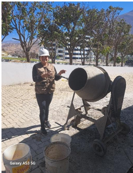
Procedimiento de la mezcla de materiales de acuerdo al diseño de mezcla con ayuda de una mezcladora de concreto para obtener el concreto fresco en las instalaciones del laboratorio de la Universidad de Huánuco.
