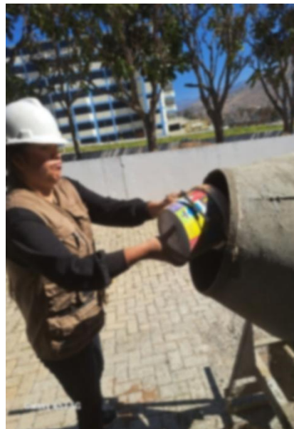
Introducción del Tereftalato de polietileno a la mezcladora de concreto, en las instalaciones del laboratorio de la Universidad de Huánuco.
