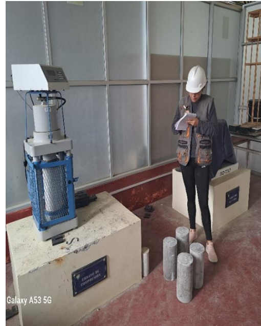
Ejecución del procedimiento de rotura de probetas, de acuerdo a la Norma ASTM C39- Resistencia A La Compresión de Concreto.
