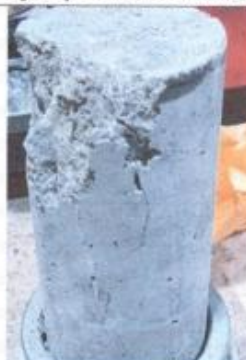
Fig. 4: Tipo de falla de la Muestra 05.
