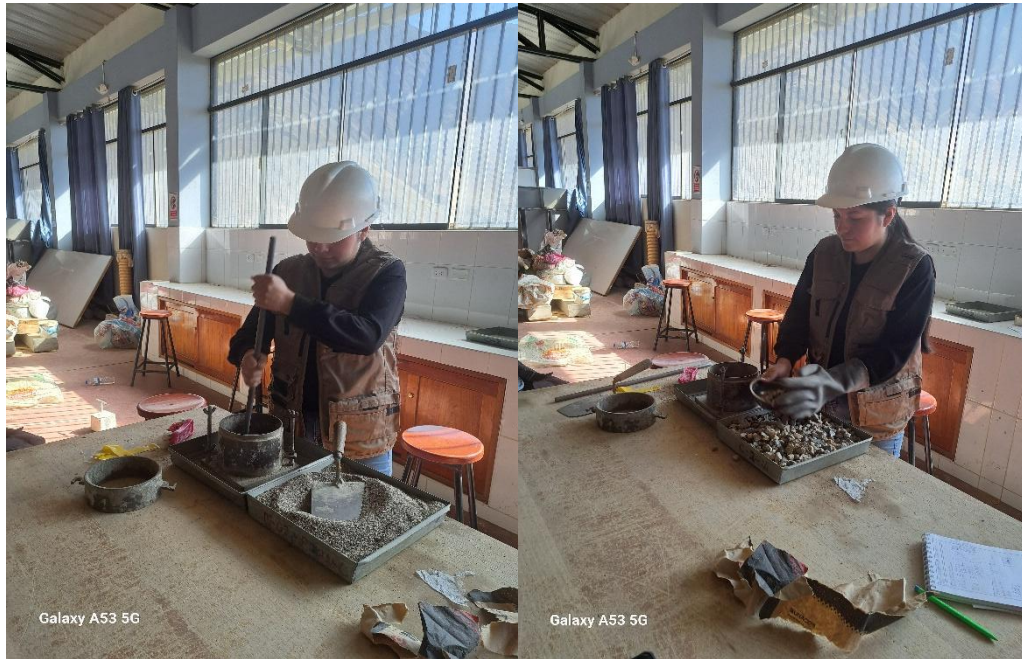
Ejecución de pruebas de laboratorio para conocer las características físicas y mecánicas de los agregados para la elaboración de un concreto de 210 kg/cm 2 .
