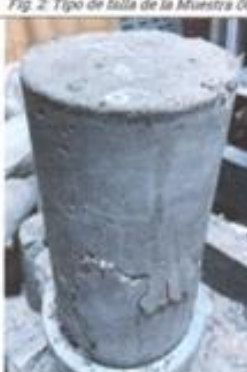
Fig. 4: Tipo de falla de la Muestra 07.
