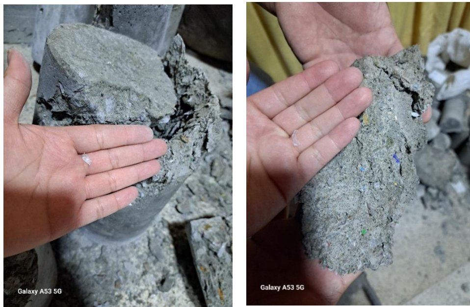
Tamaño del Tereftalato de polietileno molido (0.3 – 0.5 cm)
