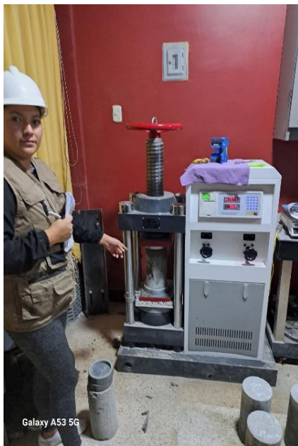
Ejecución del procedimiento de rotura de probetas, de acuerdo a la Norma ASTM C39- Resistencia A La Compresión de Concreto.
