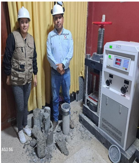
Ejecución del procedimiento de rotura de probetas, de acuerdo a la Norma ASTM C39- Resistencia A La Compresión de Concreto.
