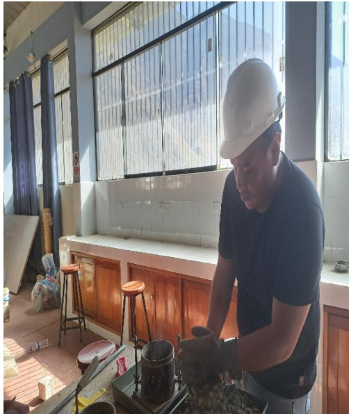
Ejecución de pruebas de laboratorio para conocer las características físicas y mecánicas de los agregados para la elaboración de un concreto de 210 kg/cm 2 .
