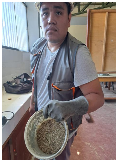
Proceso de molido de los residuos orgánicos (bagazo de caña de azúcar y carrizo) con un molino adaptado.
