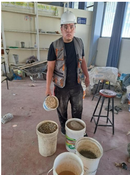
Pesaje de los materiales para la elaboración del concreto de acuerdo al diseño de mezcla, en las instalaciones del laboratorio de la Universidad de Huánuco.
