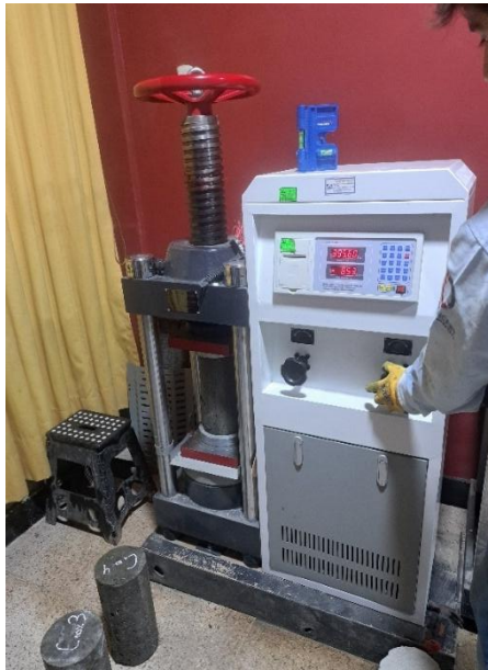
Ejecución del procedimiento de rotura de probetas, de acuerdo a la Norma ASTM C39- Resistencia a la Compresión de Concreto.
