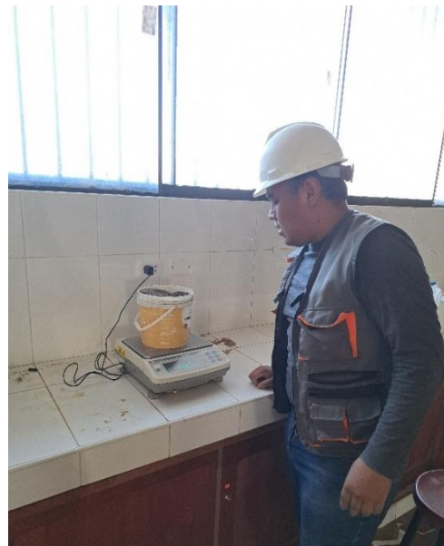
Pesaje de los materiales para la elaboración del concreto de acuerdo al diseño de mezcla, en las instalaciones del laboratorio de la Universidad de Huánuco.
