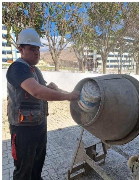
Procedimiento de la mezcla de materiales con ayuda de una mezcladora de concreto para obtener el concreto fresco en las instalaciones del laboratorio de la Universidad de Huánuco.
