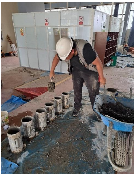
Ejecución del procedimiento de introducción de concreto fresco a los moldes, de acuerdo a los Estándares ASTM Designación: C 192/C 192M – 02 Práctica Estándar para Elaboración y Curado en el Laboratorio de Especímenes de Concreto para Ensayo.
