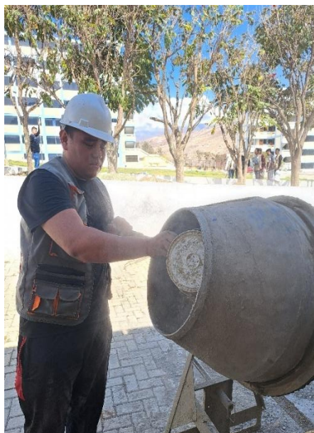
Procedimiento de la mezcla de materiales con ayuda de una mezcladora de concreto para obtener el concreto fresco en las instalaciones del laboratorio de la Universidad de Huánuco.
