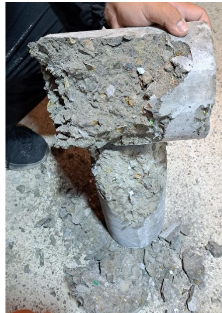
Concreto ecológico con adición de carrizo.
