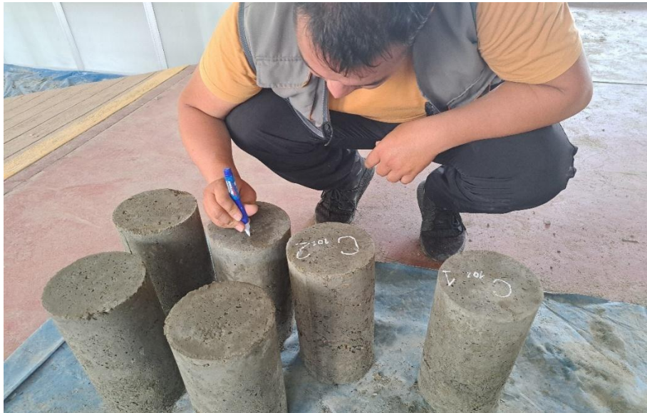
Ejecución del procedimiento de rotulado de concreto para su posterior análisis
