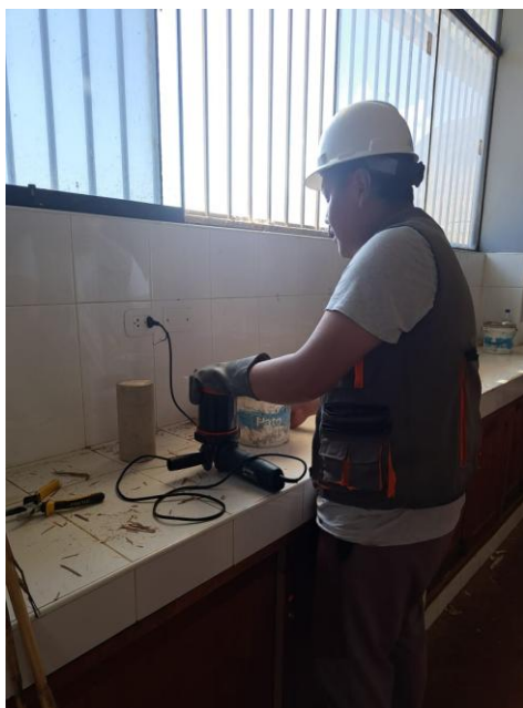
Proceso de molido de los residuos orgánicos (bagazo de caña de azúcar y carrizo) con un molino adaptado.
