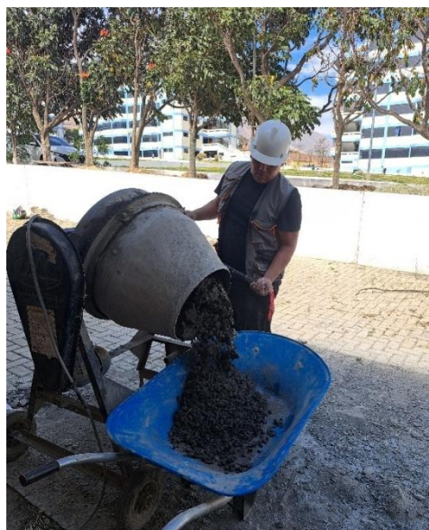
Procedimiento de la mezcla de materiales con ayuda de una mezcladora de concreto para obtener el concreto fresco en las instalaciones del laboratorio de la Universidad de Huánuco.
