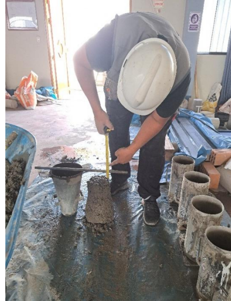
Ejecución del procedimiento para la prueba de Slump, de acuerdo al diseño de mezcla se obtuvo el revenimiento adecuado.
