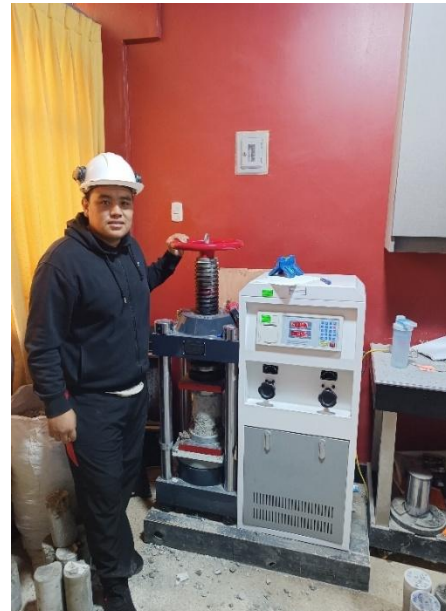
Ejecución del procedimiento de rotura de probetas, de acuerdo a la Norma ASTM C39- Resistencia a la Compresión de Concreto.
