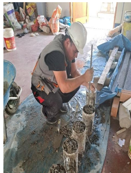
Ejecución del procedimiento de introducción de concreto fresco a los moldes, de acuerdo a los Estándares ASTM Designación: C 192/C 192M – 02 Práctica Estándar para Elaboración y Curado en el Laboratorio de Especímenes de Concreto para Ensayo.
