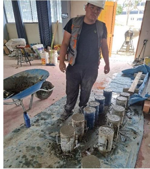
Ejecución del procedimiento de introducción de concreto fresco a los moldes, de acuerdo a los Estándares ASTM Designación: C 192/C 192M – 02 Práctica Estándar para Elaboración y Curado en el Laboratorio de Especímenes de Concreto para Ensayo.
