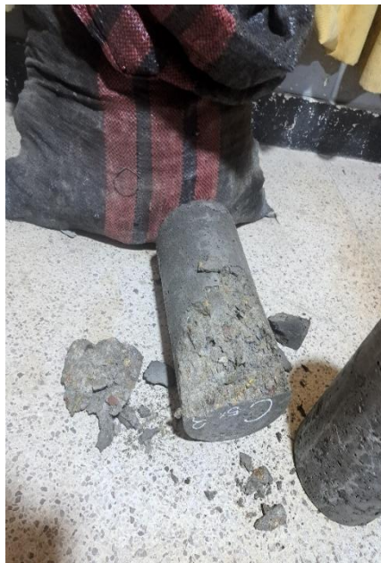
Concreto ecológico con adición de carrizo.
