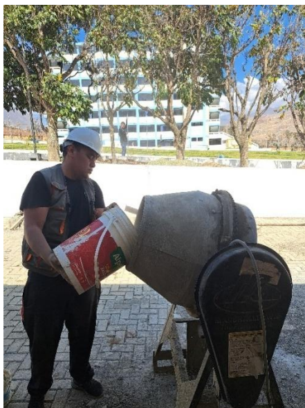
Procedimiento de la mezcla de materiales con ayuda de una mezcladora de concreto para obtener el concreto fresco en las instalaciones del laboratorio de la Universidad de Huánuco.
