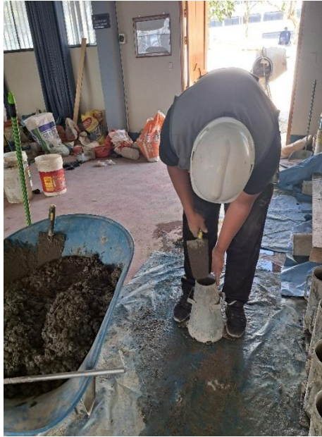
Ejecución del procedimiento para la prueba de Slump, de acuerdo al diseño de mezcla se obtuvo el revenimiento adecuado.
