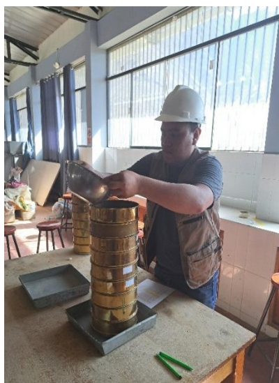
Ejecución de pruebas de laboratorio para conocer las características físicas y mecánicas de los agregados para la elaboración de un concreto de 210 kg/cm 2 .
