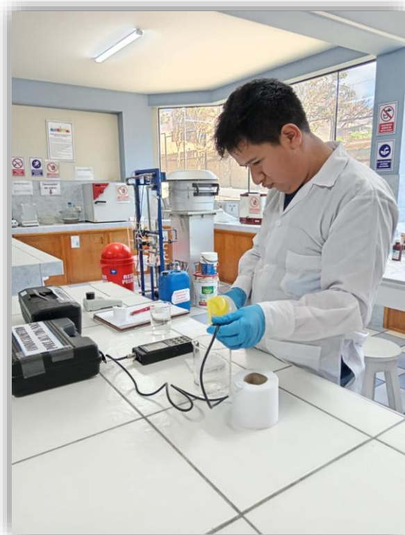
Medimos los parámetros conductividad y turbidez por jarra
