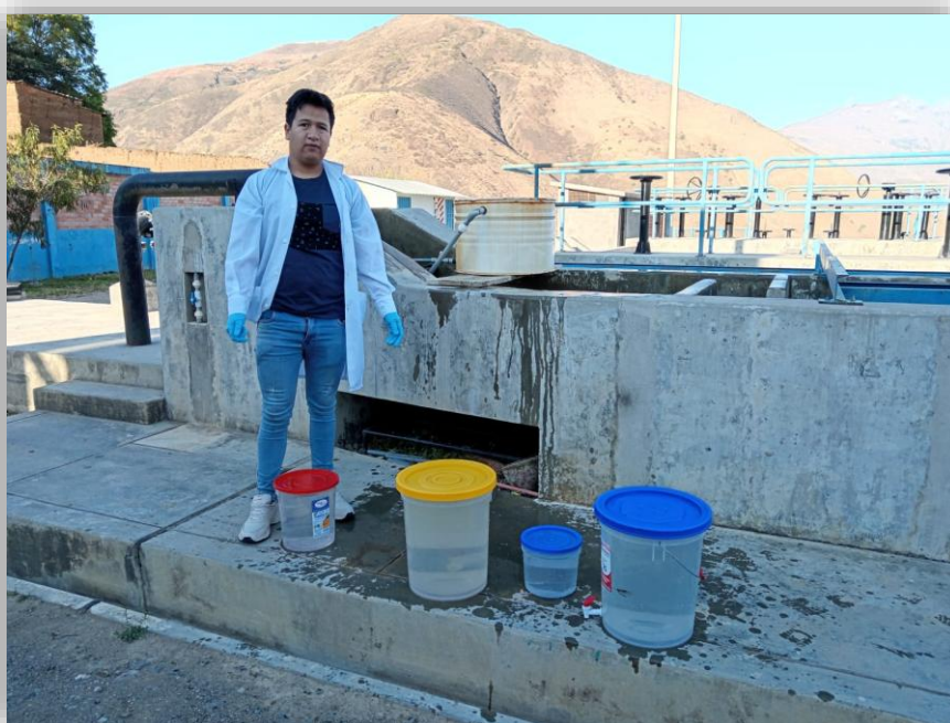
Muestras tomadas del punto de ingreso a la planta de tratamiento
