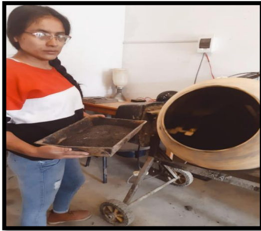
Figura 14 Colocación de materiales al trompo mezclador
