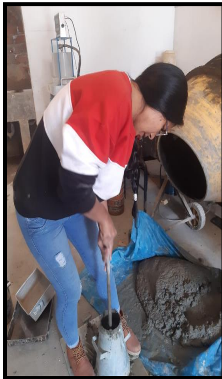
Figura 26 Ensayo de consistencia del concreto
