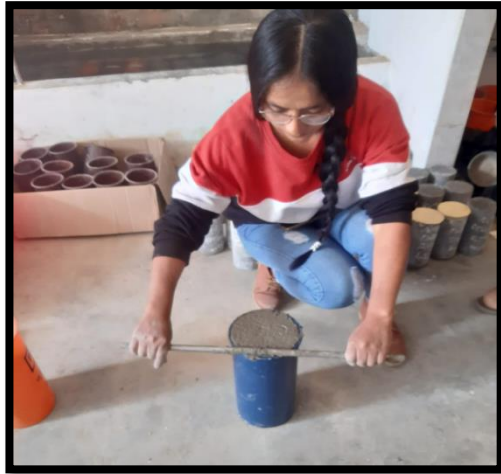
Figura 15 Eliminación del material excedente
