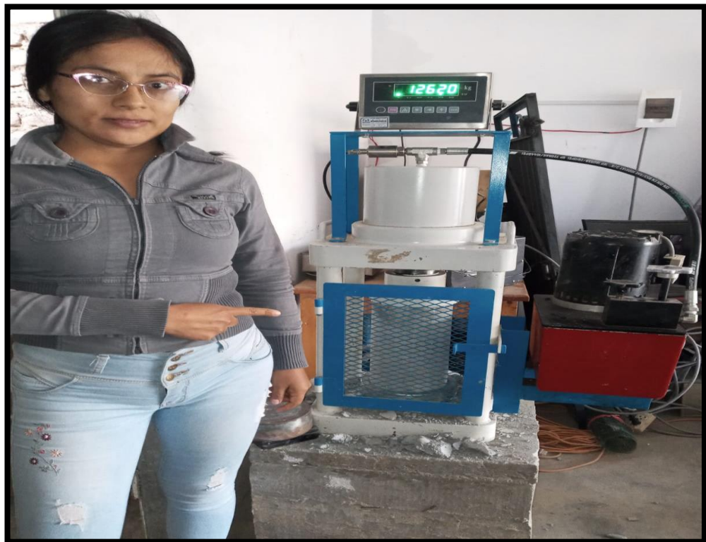
Figura 30 Especímenes ensayados a la resistencia a la compresión
