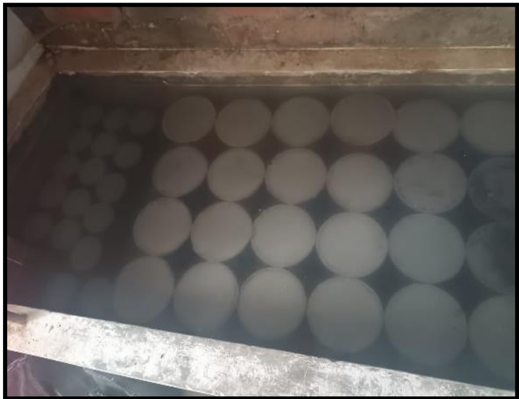
Figura 28 Curado de los especímenes
