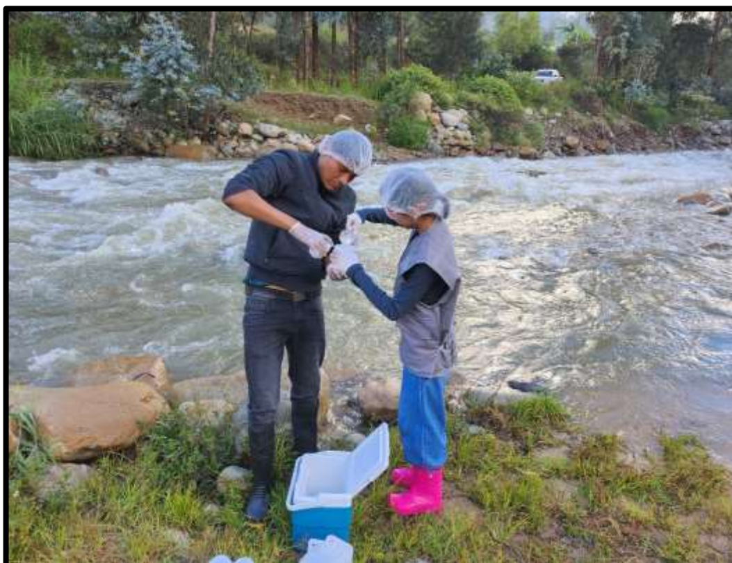
IMAGEN N° 13: USO DE ALCOHOL COMO PRESERVANTE PARA LAS MUESTRAS RECOLECTADAS ANTES DE SU ENVÍO AL LABORATORIO
