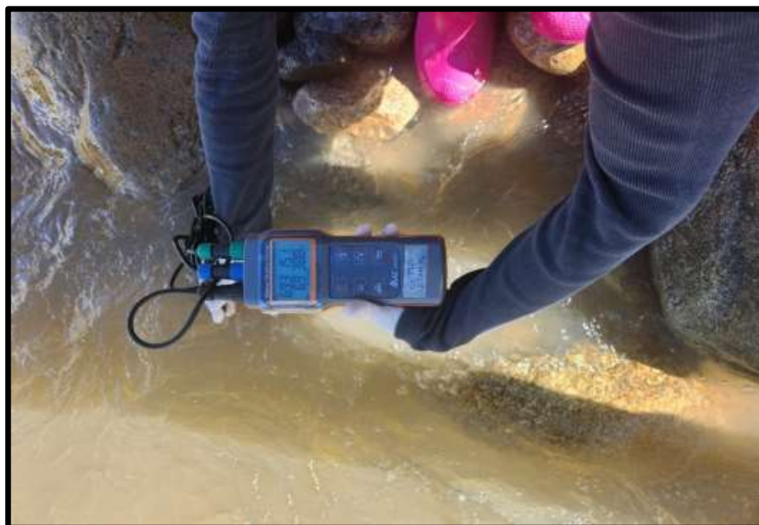
IMAGEN N° 02: MEDICIÓN DE LOS PARÁMETROS FISICOQUÍMICOS UTILIZANDO EL MULTIPARÁMETRO EN LA ESTACIÓN FZ-01 DEL RÍO
