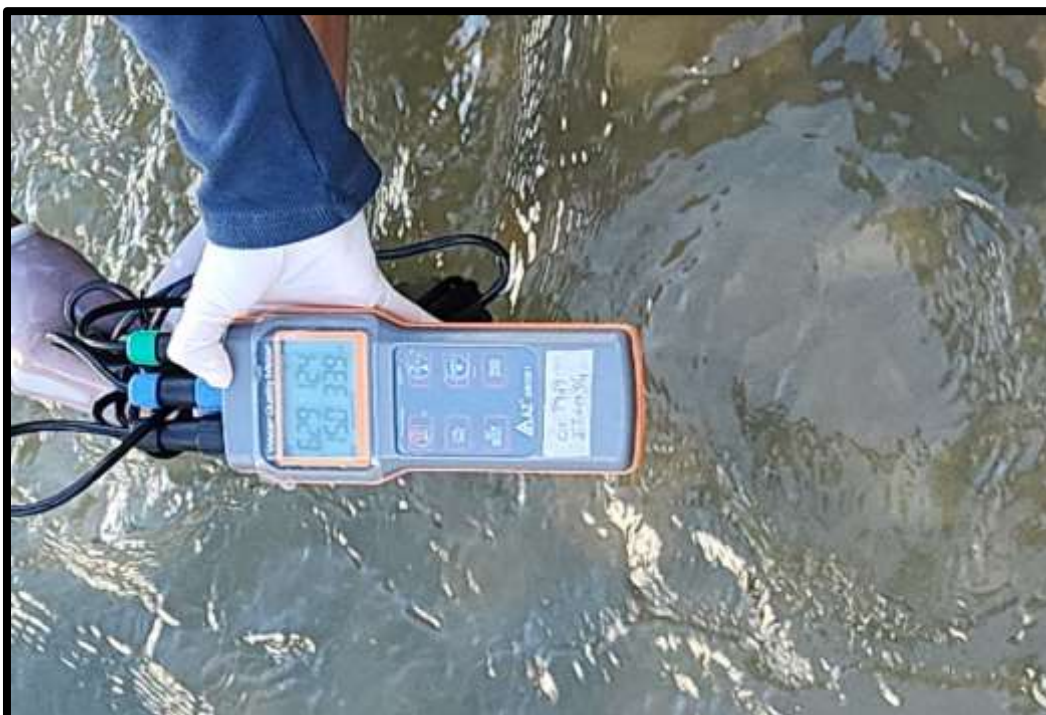
IMAGEN N° 12: EVALUACIÓN DIRECTA DE LOS PARÁMETROS FISCOQUÍMICOS EN FZ-03 MEDIANTE EL USO DEL MULTIPARÁMETRO
