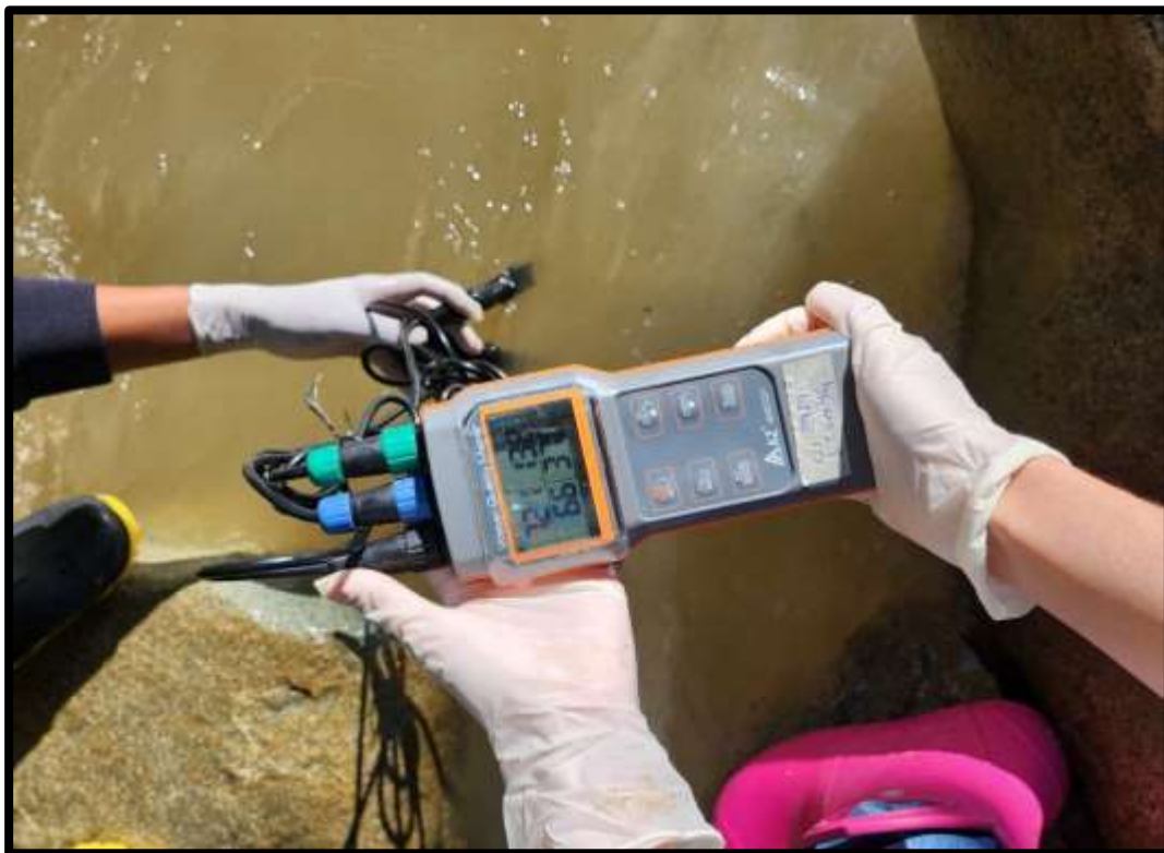
IMAGEN N° 05: MEDICIÓN DE LOS PARÁMETROS FISICOQUÍMICOS UTILIZANDO EL MULTIPARÁMETRO EN LA ESTACIÓN FZ-02 DEL RÍO
