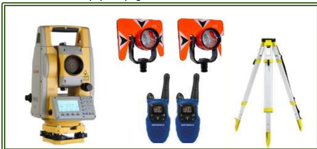
FIGURA N° 3-1: Equipo Topográfico Estación Total South N° 6
