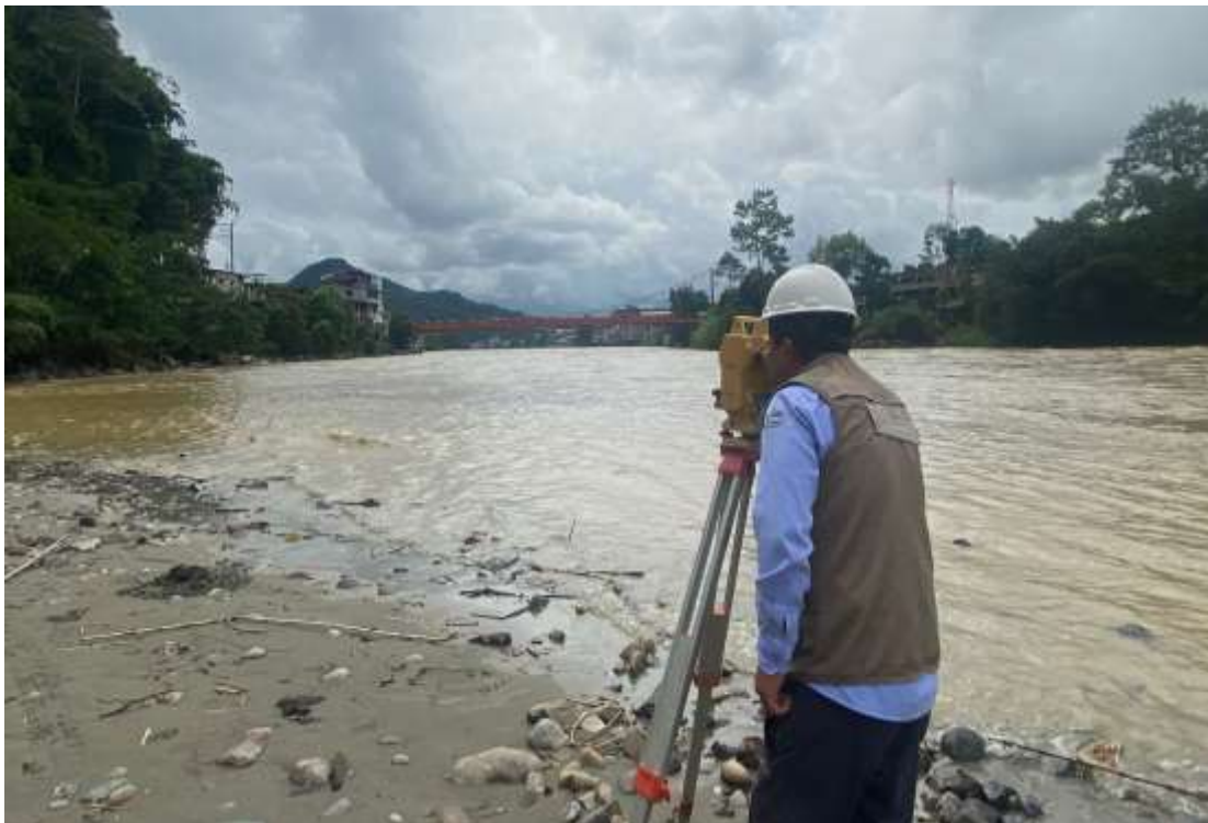
Foto del levantamiento topográfico con estación total.
