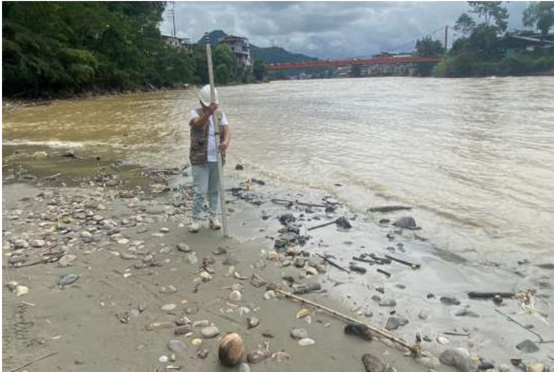
Foto del levantamiento de puntos con la mira a orillas del rio Huallaga.
