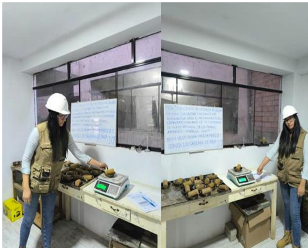
Pesaje de la muestra cilíndrica con adición 10%.
