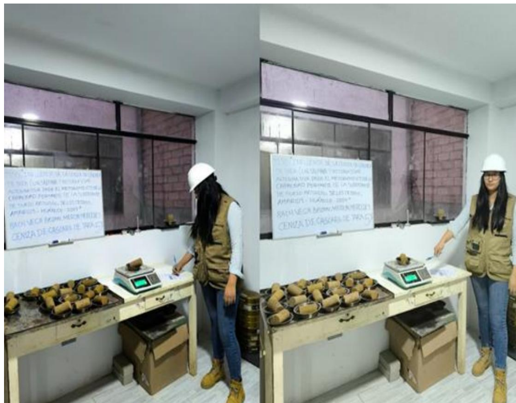
Pesaje de la muestra cilíndrica con adición 5%
