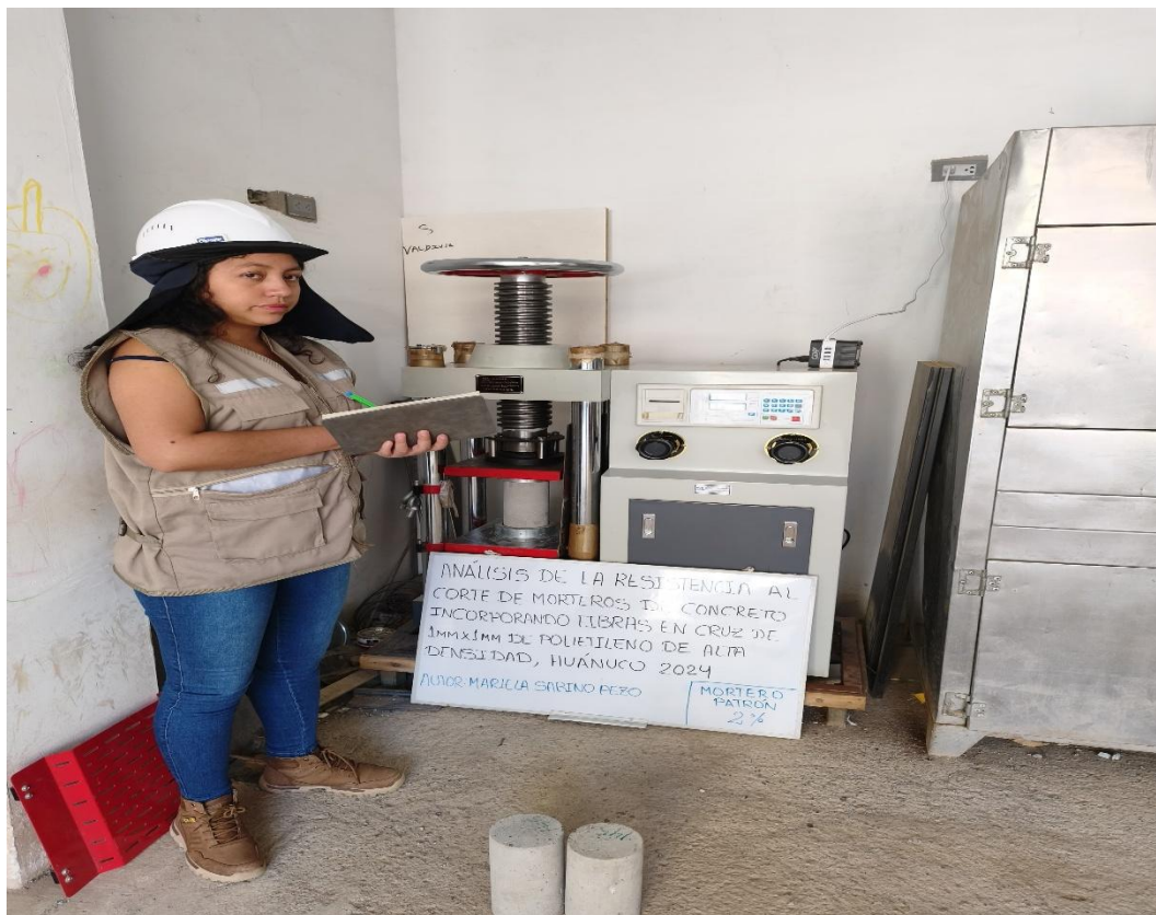
Registro de datos del ensayo de resistencia a la compresión del testigo patrón
