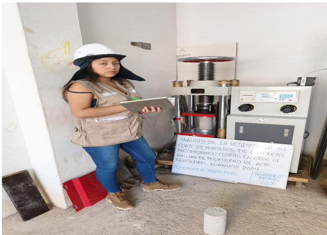
Registro de datos del ensayo de resistencia a la compresión del testigo con adición del 2.5% de fibras de HDEP
