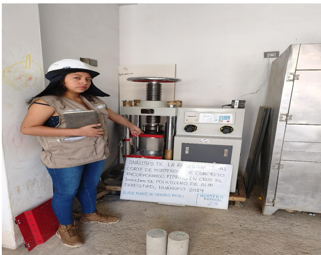
Ensayo de resistencia a la compresión del testigo con adición del 2% de fibras de HDEP
