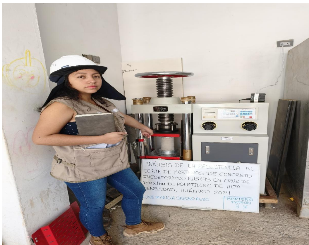
Ensayo de resistencia a la compresión del testigo con adición del 3% de fibras de HDEP
