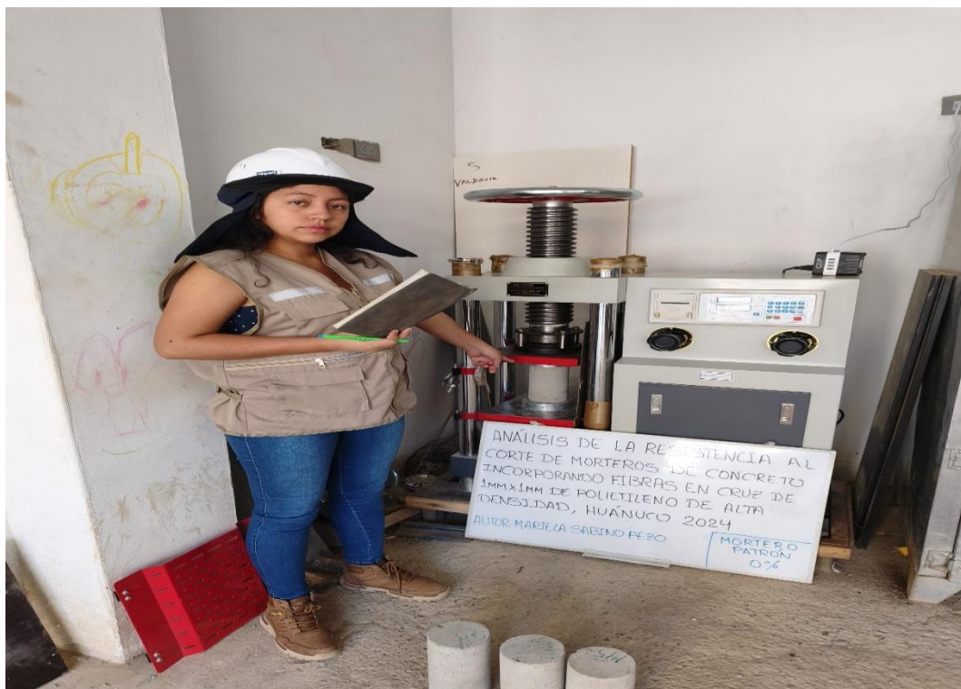
Ensayo de resistencia a la compresión del testigo patrón
