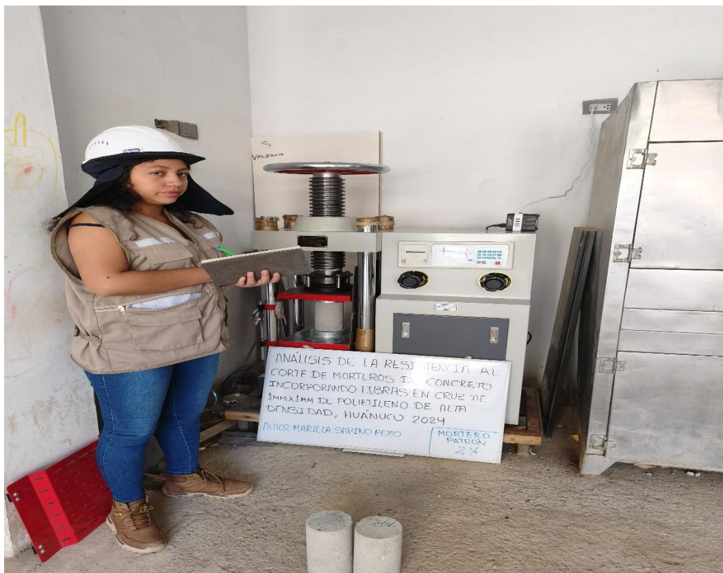
Registro de datos del ensayo de resistencia a la compresión del testigo con adición del 2% de fibras de HDEP
