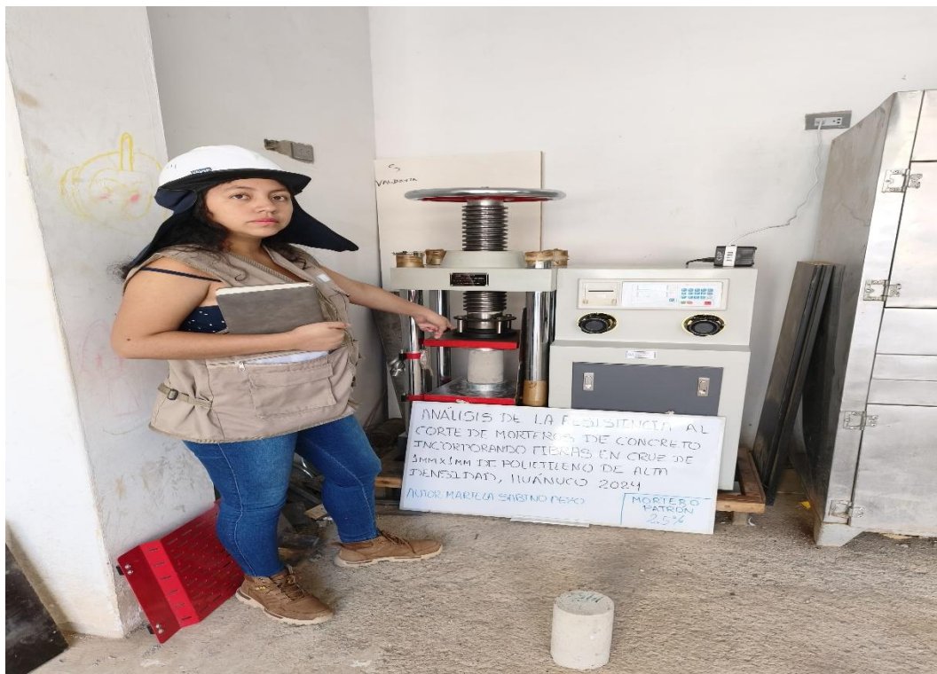
Ensayo de resistencia a la compresión del testigo con adición del 2.5% de fibras de HDEP
