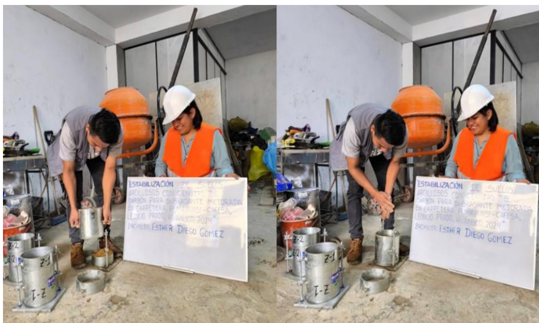
Figura 42 Desmontaje de los moldes
