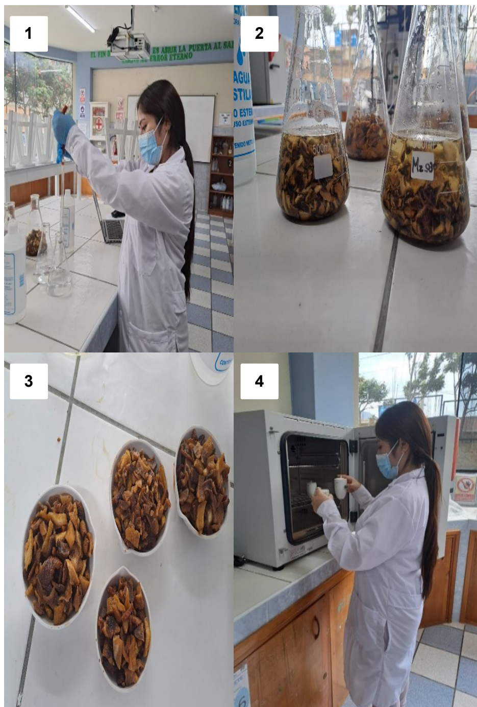
Figura 12 Procedimiento para la activación de la cascara
