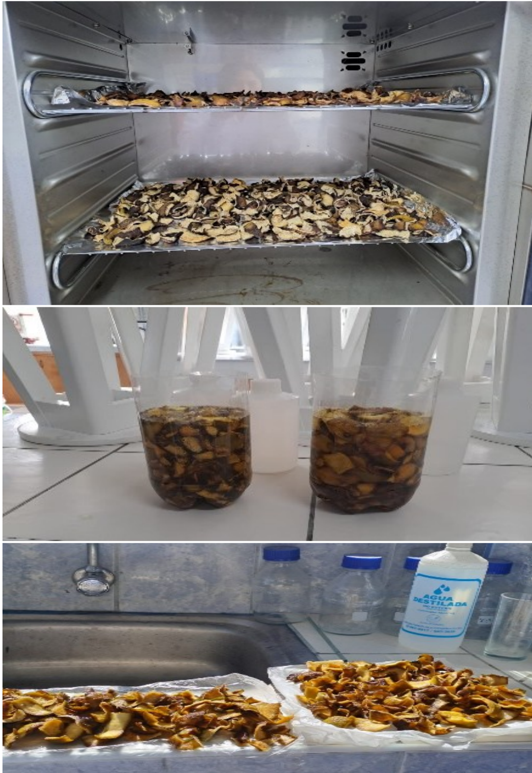
Fotografía 3 Secado, impregnación con NaOH y lavado
