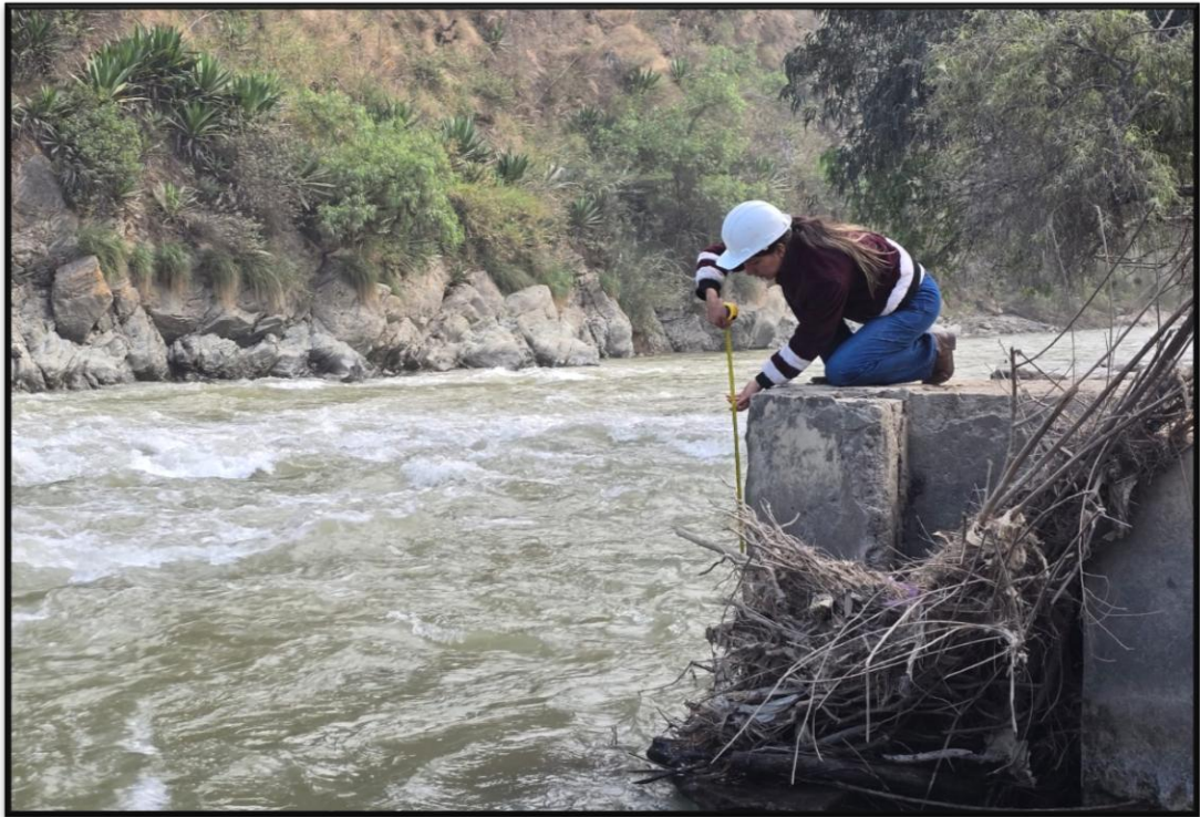
En la vista fotográfica se muestra la toma de medida de la profundidad en el cauce del rio
