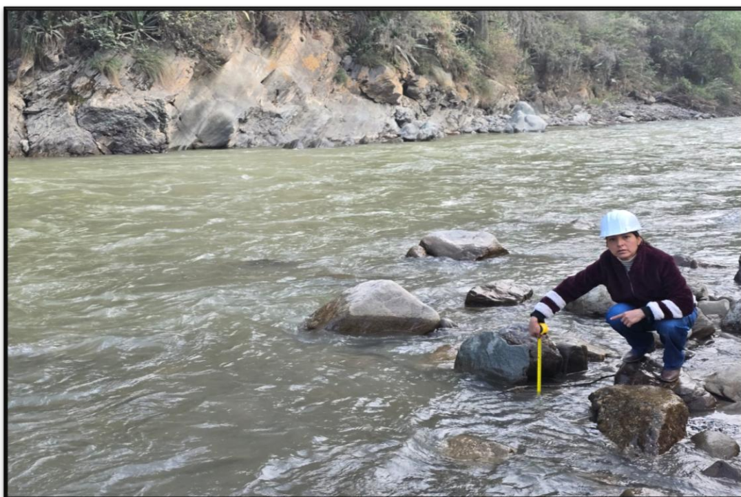
En la vista fotográfica se muestra la toma de medida de la profundidad en el cauce del río
