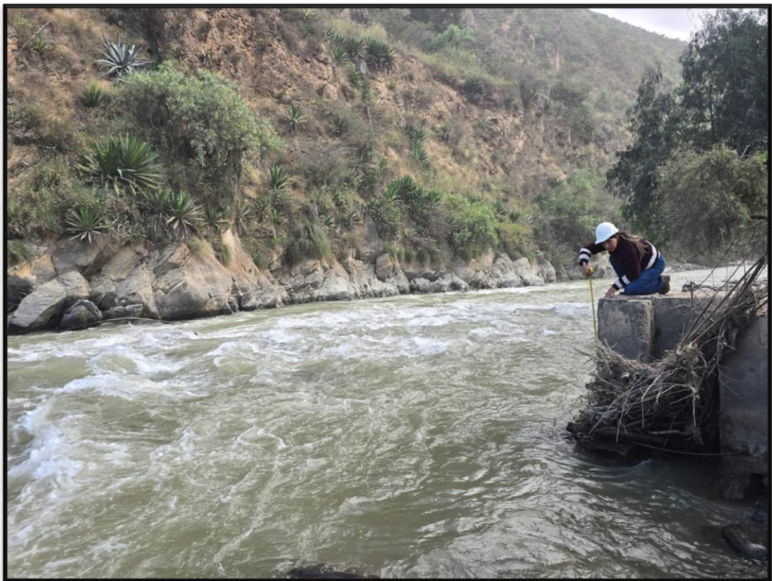
En la vista fotográfica se muestra la toma de medida de la profundidad en el cauce del rio
