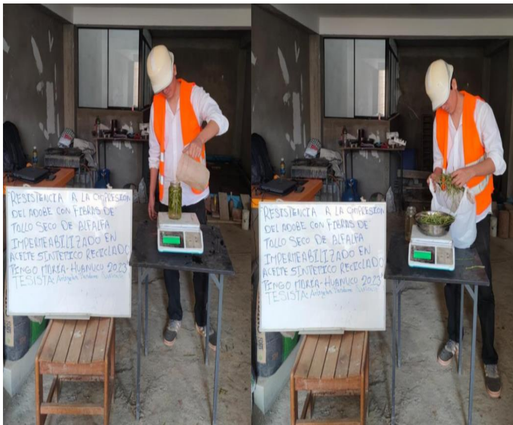
Figura 21 Pesaje del recipiente con agua y tallo de alfalfa y del tallo de alfalfa saturada
