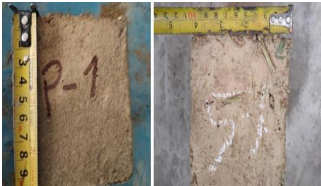
Figura 35 Selección de los bloques patrón, con 5% de fibra de tallo seco de alfalfa a los 28 días de secado
