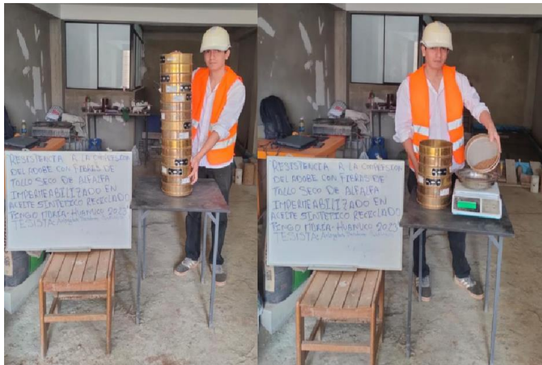
Figura 16 Muestra pasando por el tamiz N°4 hasta N°200 y pesaje
