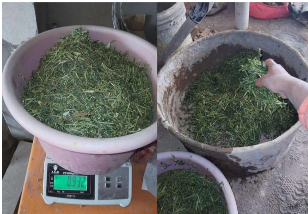
Figura 28 Pesaje al 5% de tallo de alfalfa y juntado de todas las muestras
