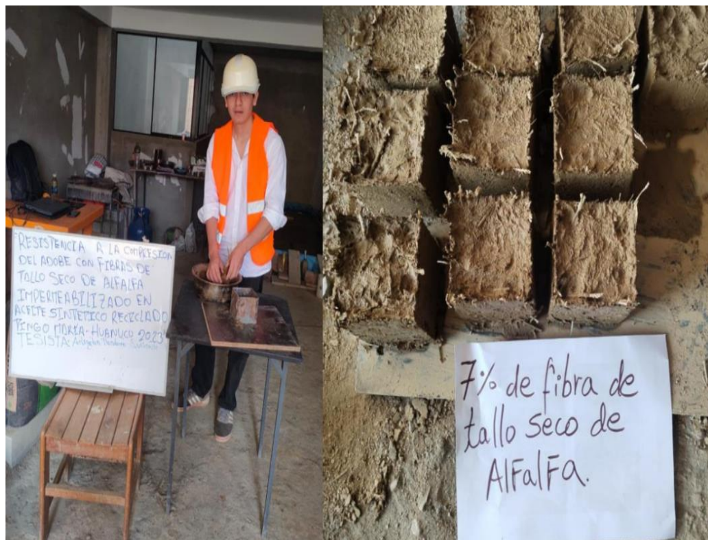
Figura 32 Elaboración de los bloques
