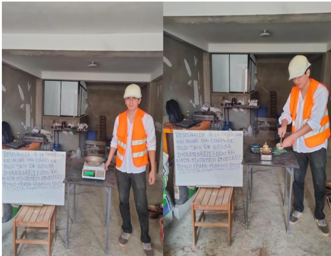
Figura 17 Pesaje de la muestra de 150g a 200g pasado por el tamiz N°40, corte con el acanalador y golpear
