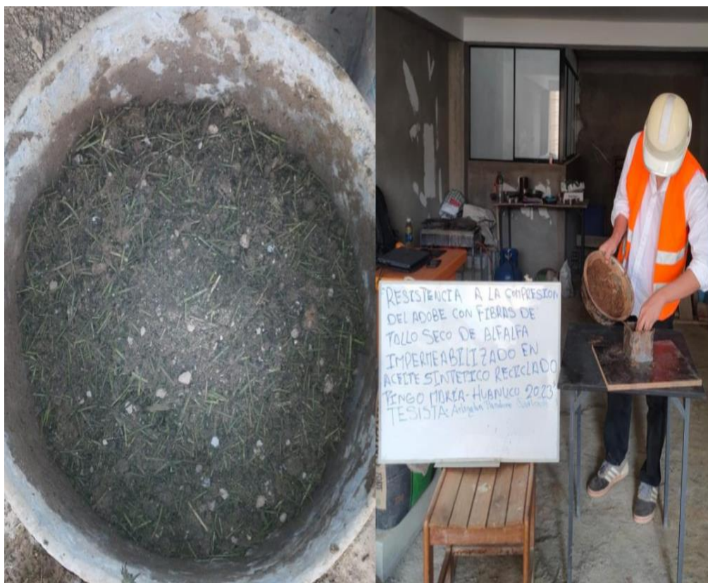
Figura 29 Mezcla de los tallos al 5% y elaboración de los bloques
