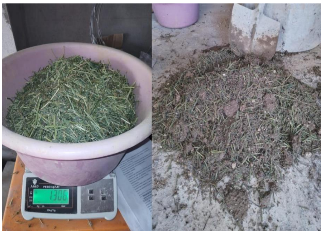
Figura 31 Pesaje de 7% de tallo de alfalfa y mezclado.
