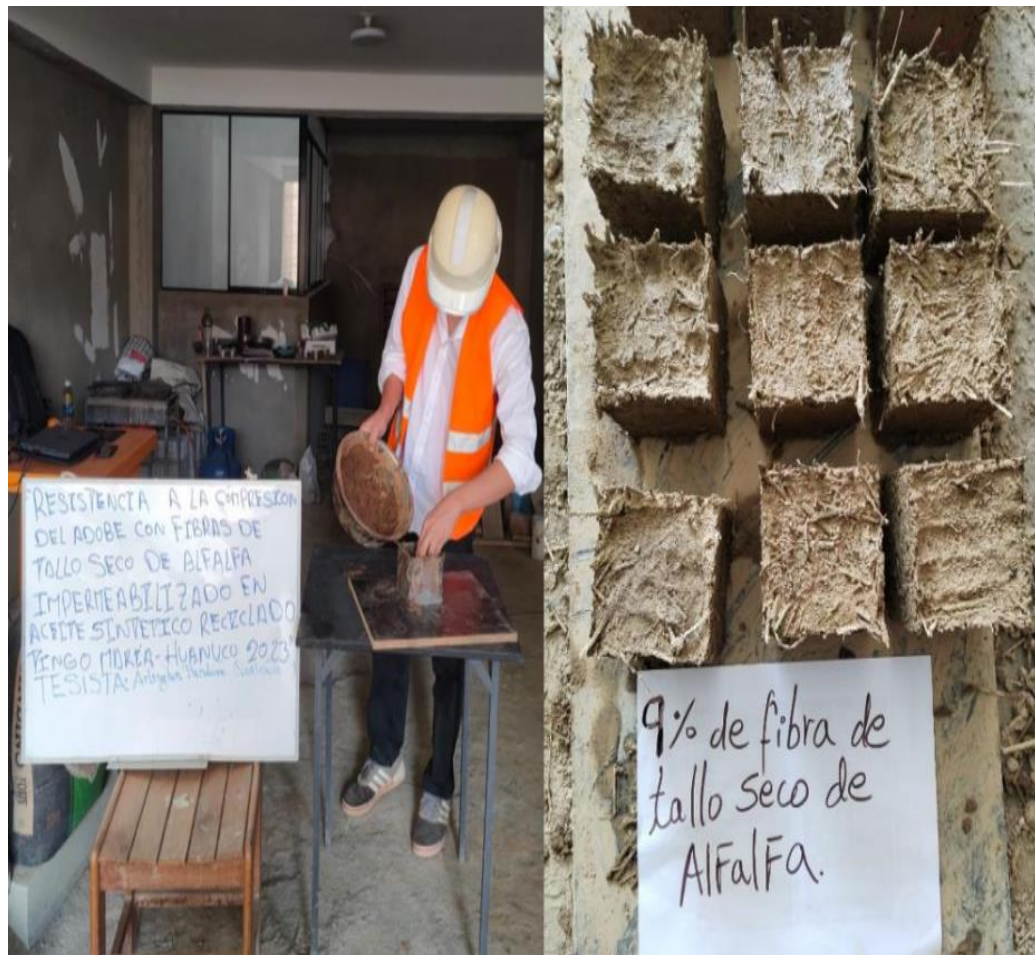
Figura 34 Elaboración de los bloques
