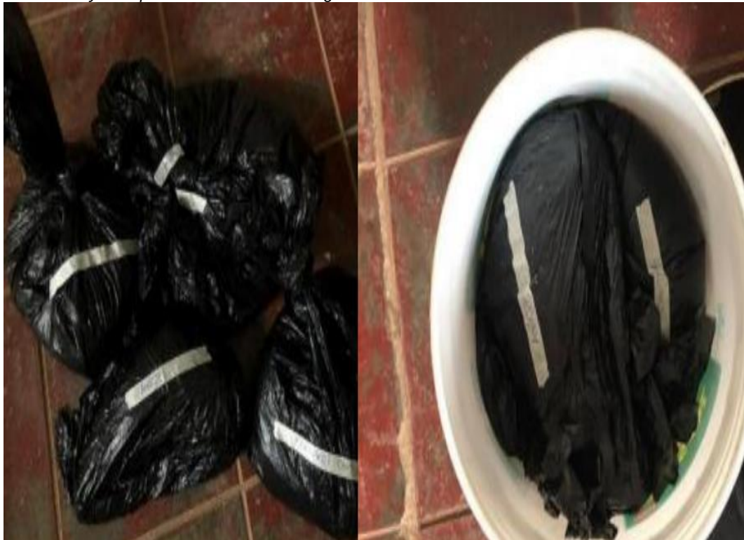
Figura 11 Preservación y transporte de las muestras según norma ASTM D 4220-89
