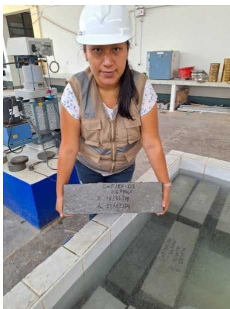
Figura 30 Curado de las muestras
