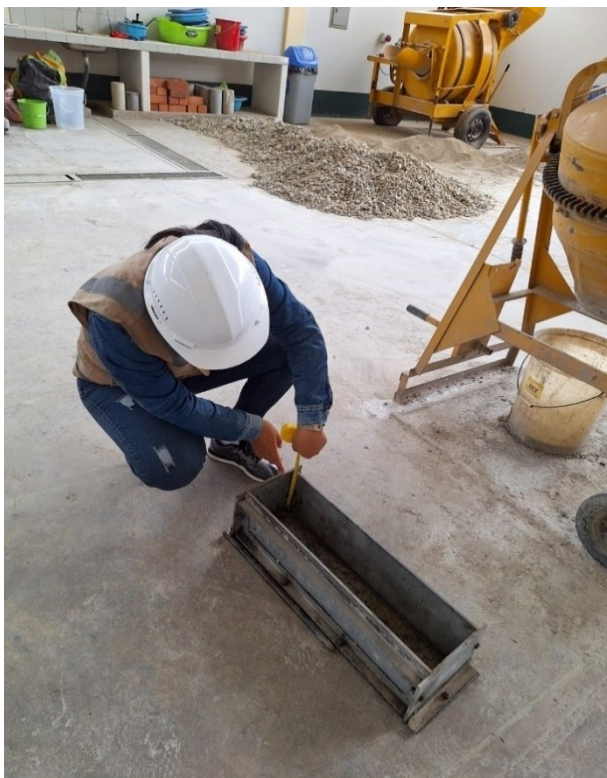
Figura 51 Verificación de las dimensiones de los moldes
