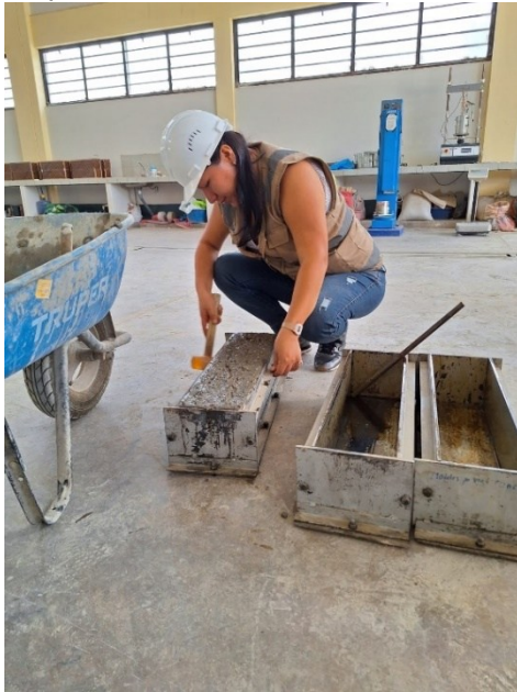
Figura 52 Golpeando la muestra con el martillo de goma
