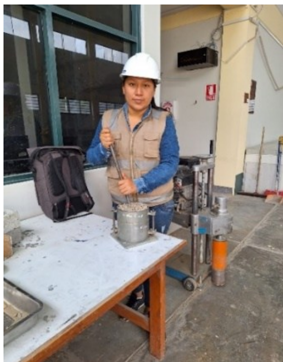
Figura 6 Compactación de los agregados
