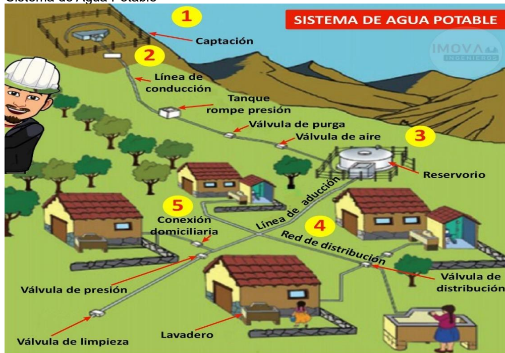
Figura 1 Sistema de Agua Potable
