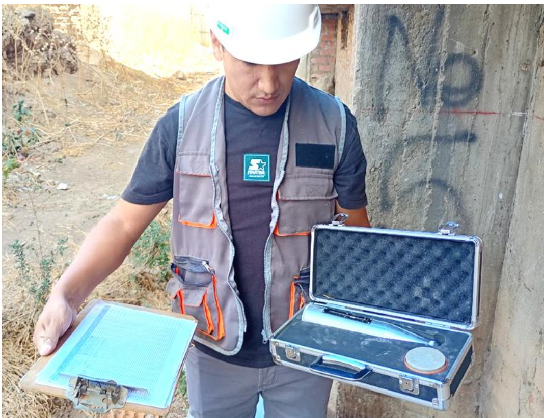
FOTOGRAFÍA N° 02: Equipo y materiales para el ensayo de esclerometría
