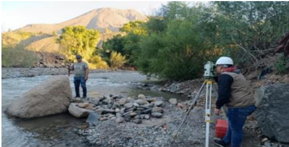
En la imagen se puede observar al prismo a orillas de la cuenca estacionado para el Levantamiento Topográfico del proyecto.
