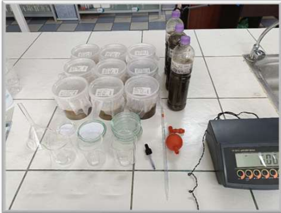
Activación de los biodigestores de segunda generación
