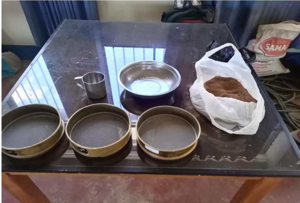
Se realizó el tamizado de la cascarilla de cacao molida utilizando tres diferentes tamaños de malla, con el objetivo de clasificar las partículas según su granulometría
