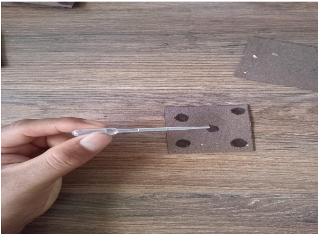
El cuarto indicador que medimos fue la absorción con un gotero y cronometro
