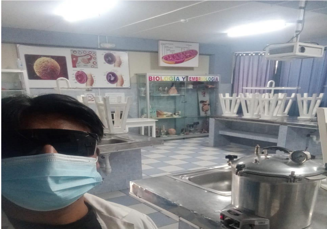
Se llevo las tres mezclas a un proceso de cocción de 110° Celsius por dos horas en un AUTOCLAVE (instrumento de laboratorio).
